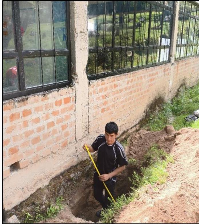
Fotografía 5. I.E. Santiago Antúnez de Mayolo – toma de muestra de suelo para ensayo de corte directo
