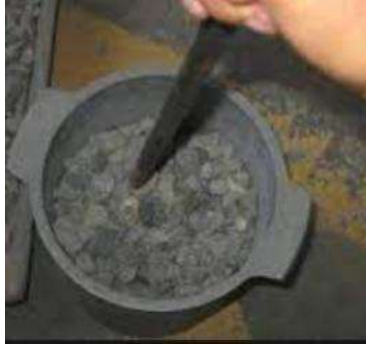
Figura 7. Compactación del agregado grueso en tres capas. Fuente: Elaboración propia.
