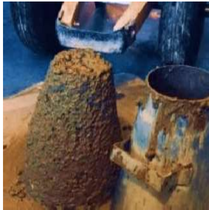
Figura 18. Prueba de SLUMP
