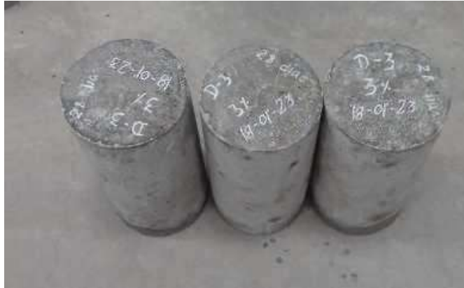
Figura 47. Rotura de probetas al 3 %.
