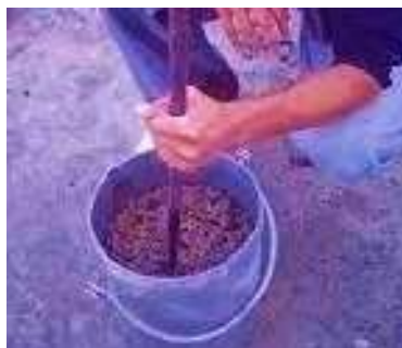
Figura 19. Compactación de concreto para el peso unitario
