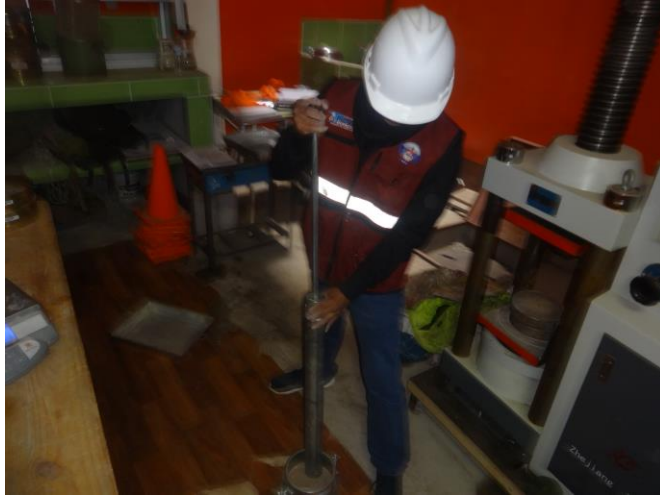
Muestra del suelo, aplicación de golpes con el pisón.
