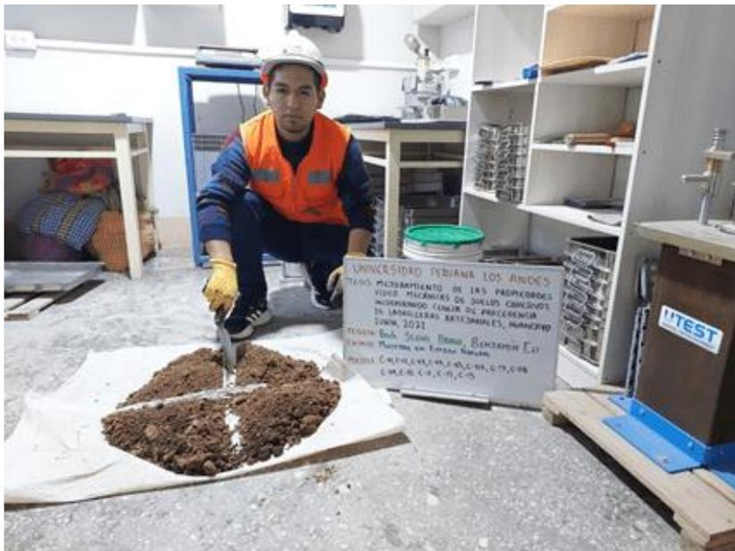
*Nota: Ensayo de cuarteo para reducción de muestra a tamaño de ensayo. Fuente: Elaboración propia.*
