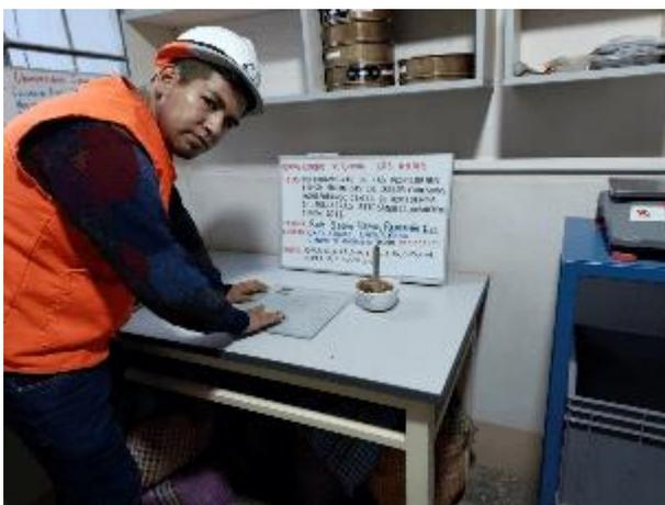
*Nota:* Ensayo de limite plástico. Fuente: *Elaboración propia*
