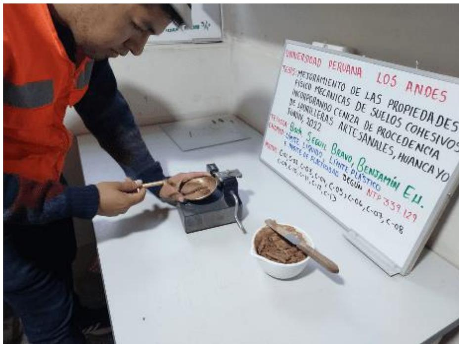
*Nota:* Ensayo de limite líquido. Fuente: *Elaboración propia.*
