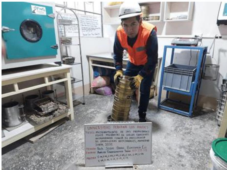
*Nota:* Ensayo de análisis granulométrico en laboratorio. Fuente: *Elaboración propia.*
