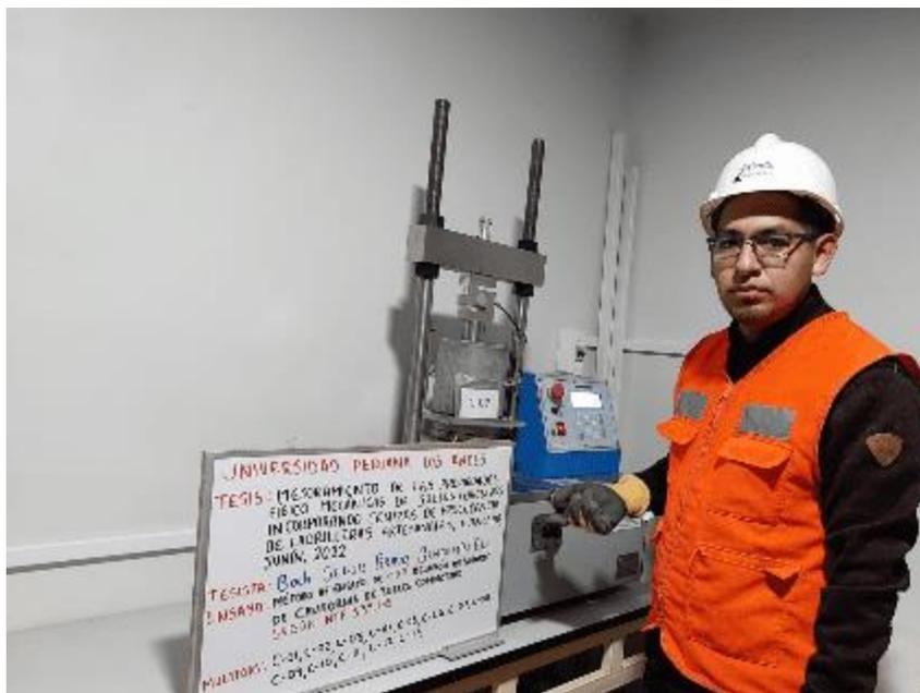
*Nota: Ensayo de CBR en laboratorio con adición de 10% de ceniza. Fuente: Elaboración propia.*
