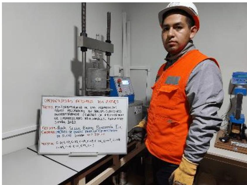
*Nota:* Ensayo de CBR en laboratorio con adición de 5% de ceniza. Fuente: *Elaboración propia.*
