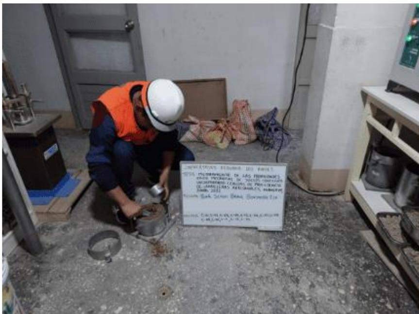
*Nota: Muestra para el contenido de humedad - PROCTOR modificado. Fuente: Elaboración propia.*
