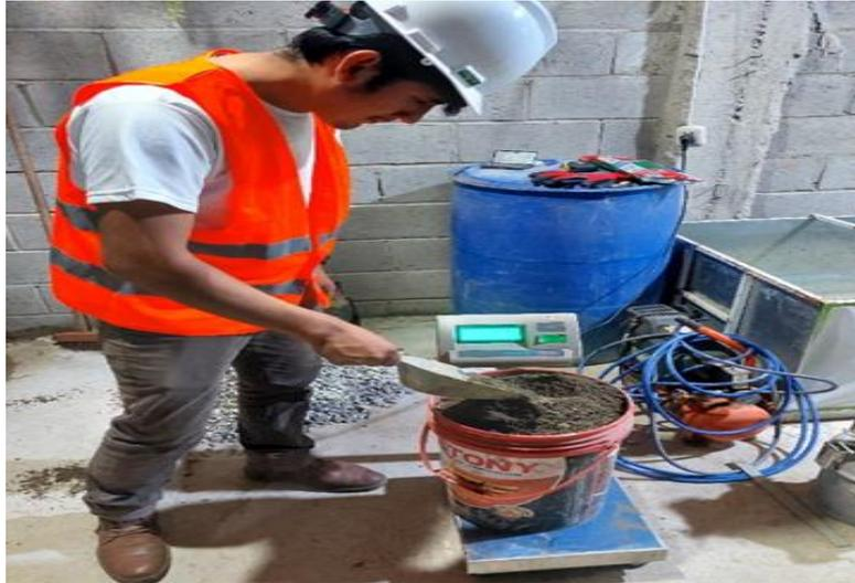
Fotografía 7. Cantidad del agregado de acuerdo al diseño de mezcla patrón.
