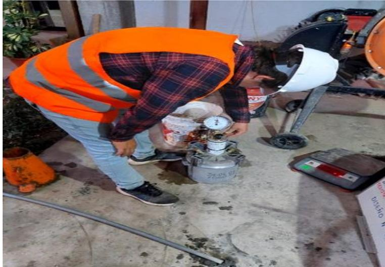
Fotografía 31. Método por presión para la determinación del contenido de aire del diseño N° 004.
