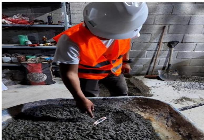
Fotografía 9. Determinación de la temperatura del concreto patrón el cual fue de 28.6 °C.
