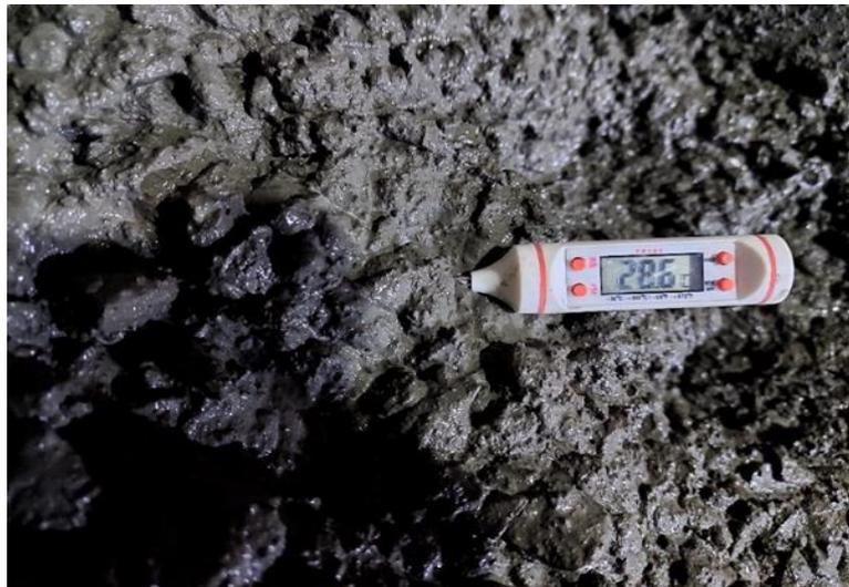
Fotografía 29. Determinación de la temperatura del diseño de mezcla N° 004, T= 28°C.
