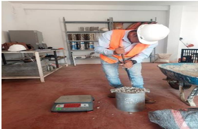
Fotografía 5. Desarrollo del ensayo de PUC Y PUS de los agregados fino – grueso.
