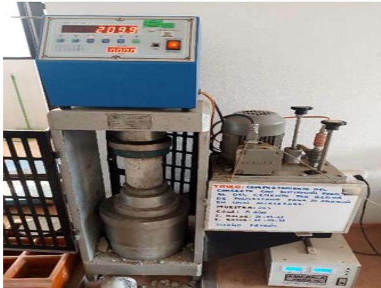
Fotografía 34. Ensayo de resistencia a la compresión axial del concreto.
