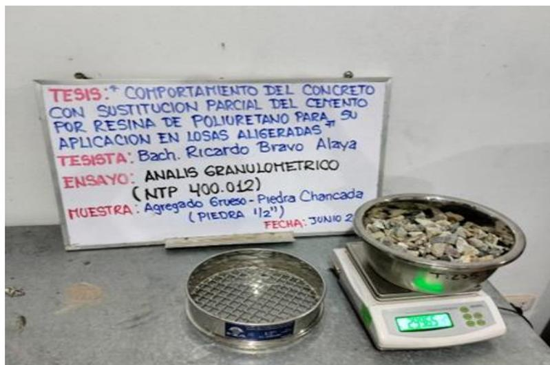
Fotografía 3. Pesado del material retenido en el tamiz.
