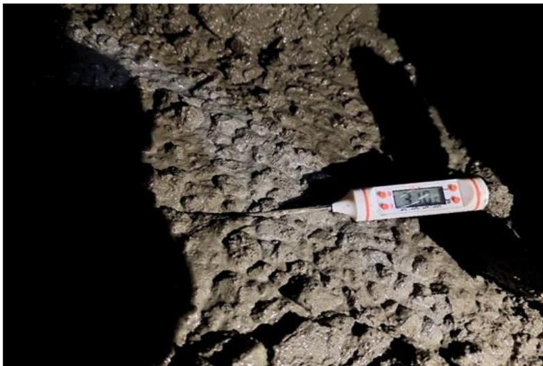
Fotografía 18. Determinación de la temperatura del diseño de mezcla N° 002, T= 31°C.
