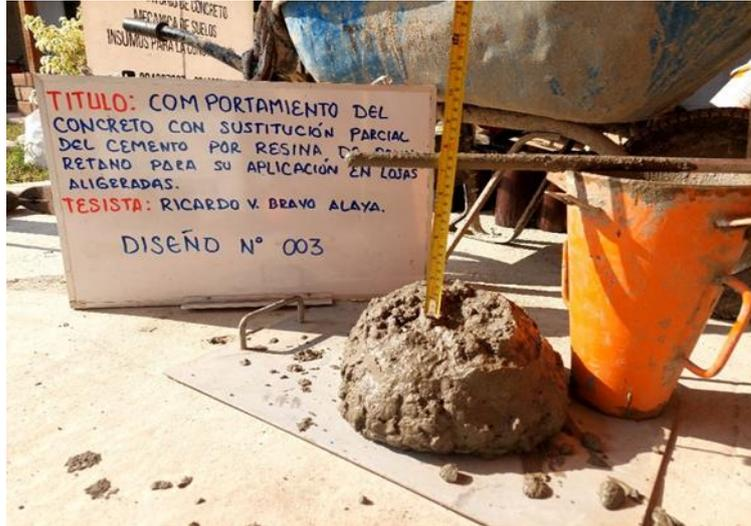
Fotografía 25. Medición del Asentamiento del diseño de mezcla N° 003 el cual fue de 7”.
