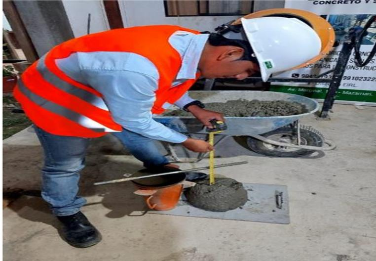
Fotografía 19. Medición del Asentamiento del diseño de mezcla N° 002 el cual fue de 6”.
