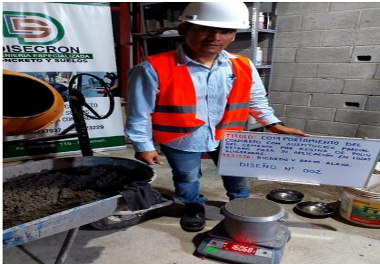
Fotografía 20. Peso del diseño de mezcla N°002 para hallar el contenido de aire.
