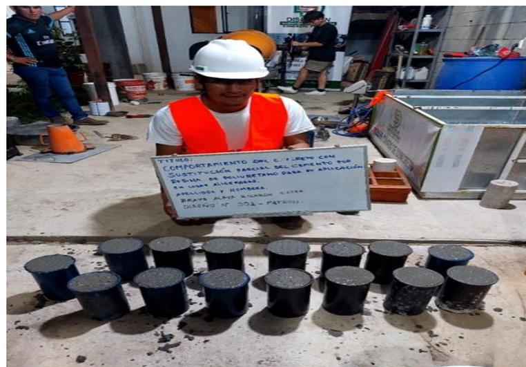
Fotografía 15. Vaciado de la mezcla del concreto patrón.
