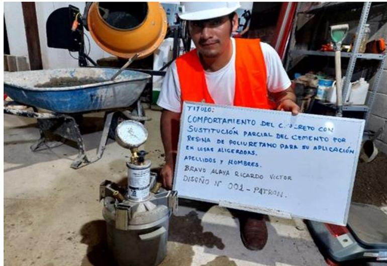
Fotografía 13. Método por presión para la determinación del contenido de aire en estado fresco
