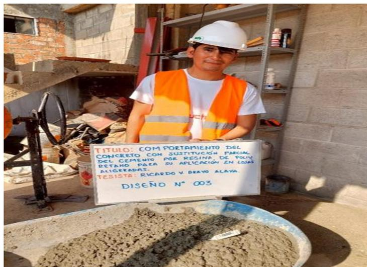
Fotografía 24. Determinación de la temperatura del diseño de mezcla N° 003, T= 33.7°C.
