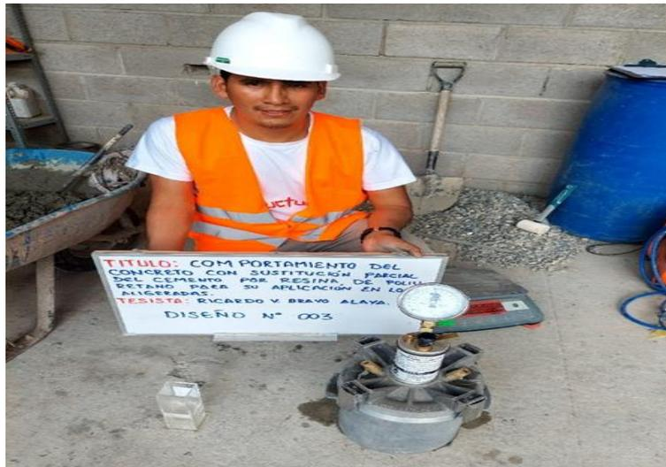
Fotografía 26. Método por presión para la determinación del contenido de aire del diseño N° 003.
