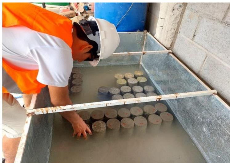
Fotografía 27. Elaboración y curado de las probetas cilíndricas del diseño N° 003.
