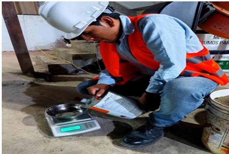
Fotografía 17. Peso de la resina de poliuretano para el diseño de mezcla N° 002.
