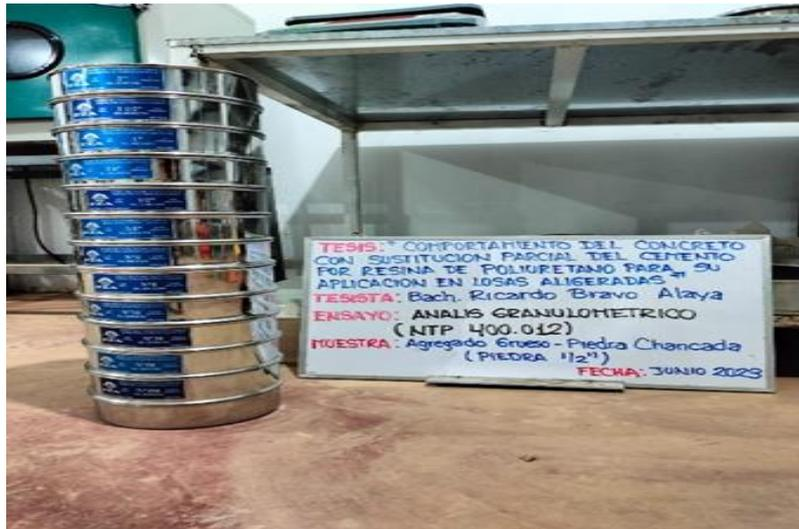
Fotografía 1. Ensayo granulométrico del agregado fino y grueso.
