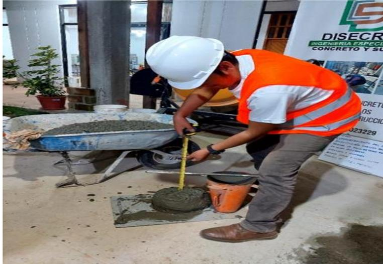
Fotografía 10. Medición del asentamiento del concreto patrón, del ensayo Slump.
