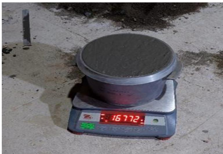
Fotografía 12. Peso del concreto patrón para hallar el contenido de aire.
