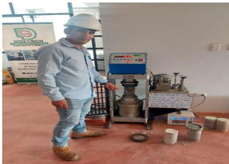
Fotografía 36. Especímenes a los 28 días de edad de los diseños de mezclas.
