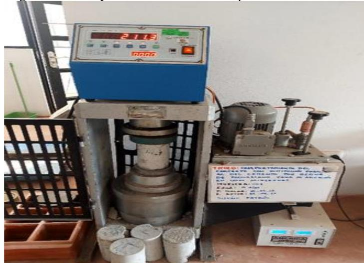
Fotografía 35. Rotura de las probetas cilíndricas en el ensayo de compresión.
