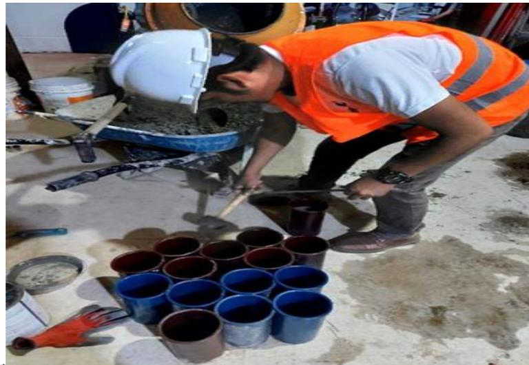
Fotografía 14. Probetas cilíndricas para contener el concreto patrón.
