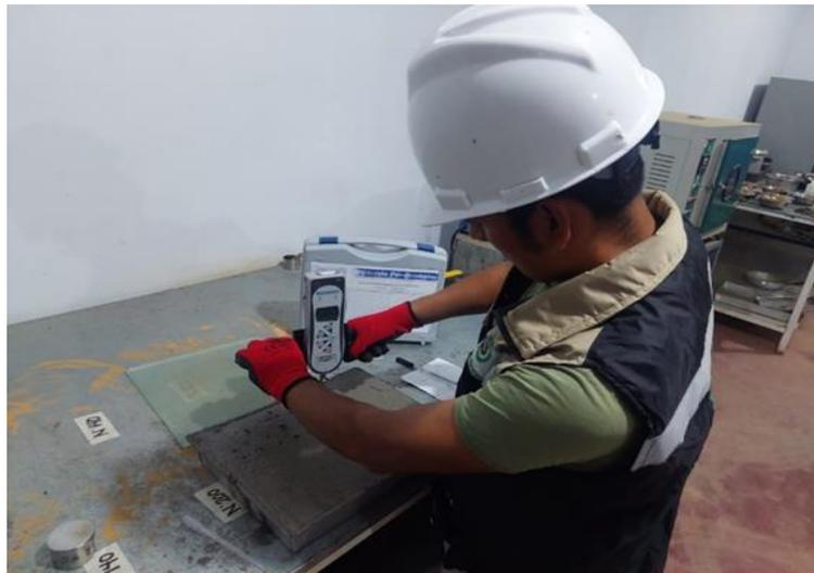
Fotografía 33. Desarrollo del ensayo exudación del diseño N° 004.
