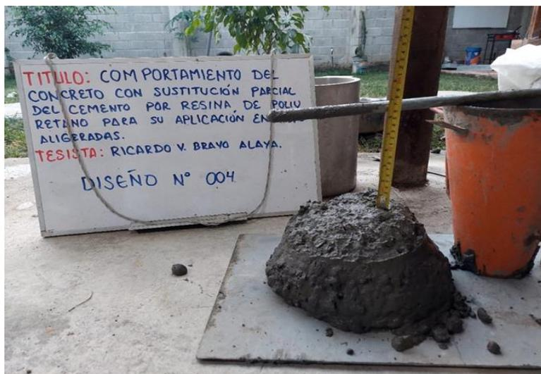
Fotografía 30. Medición del Asentamiento del diseño de mezcla N° 004 el cual fue de 6.5”.
