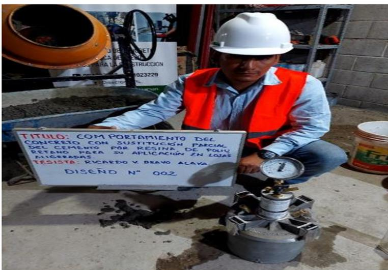
Fotografía 21. Método por presión para la determinación del contenido de aire del diseño N° 002.
