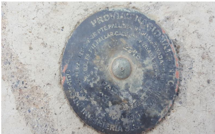
Figura 27. Toma de lectura al punto geodésico (GPS VIAS-03A).
