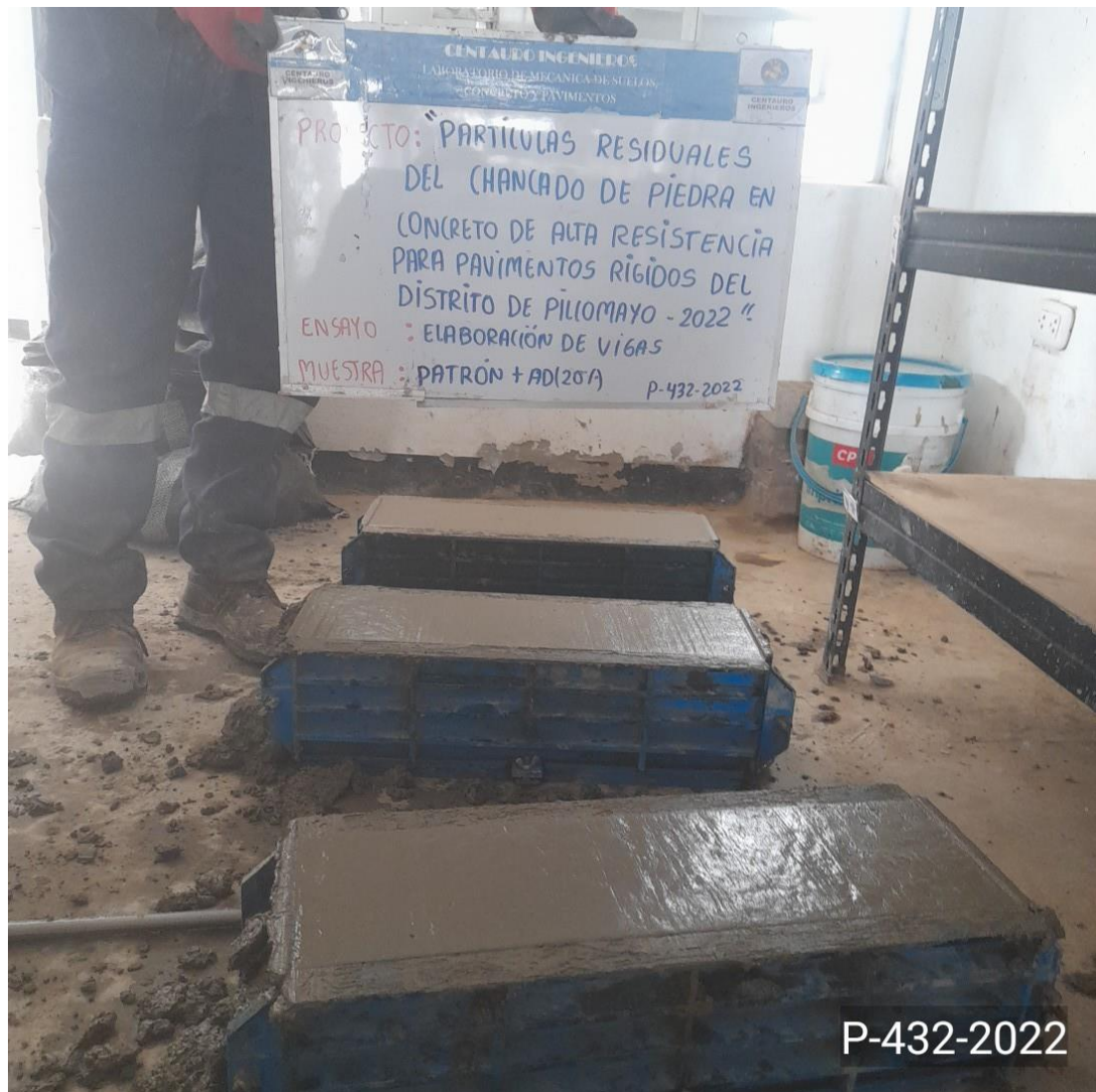
Foto N° 15: Elaboración de vigas, muestra patrón + ad (20%).
