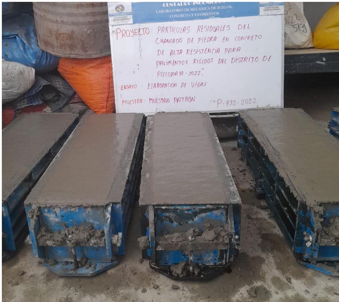
Foto N° 3: Elaboración de las vigas patrón.
