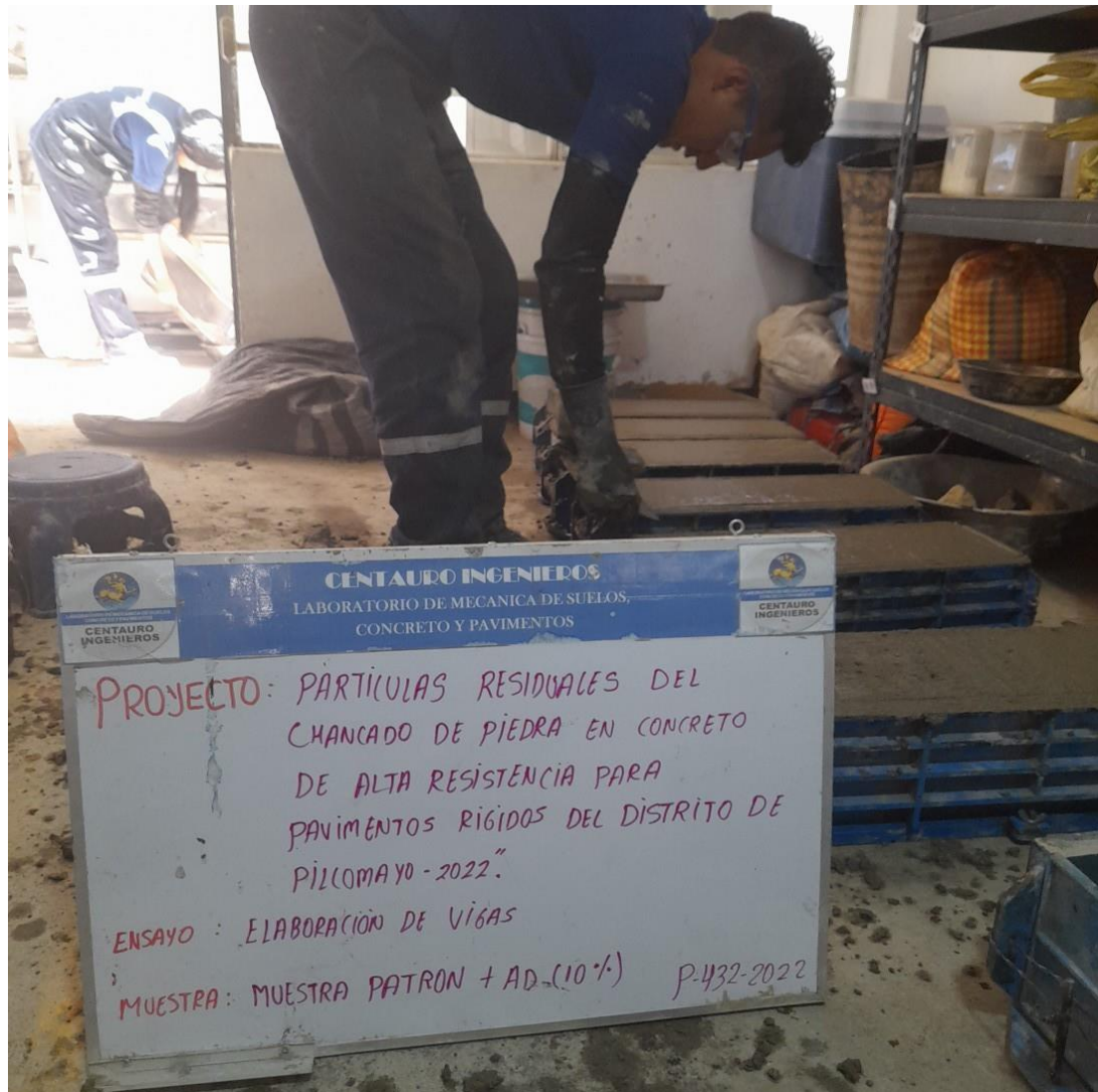
Foto N° 14: Elaboración de vigas, muestra patrón + ad (10%).
