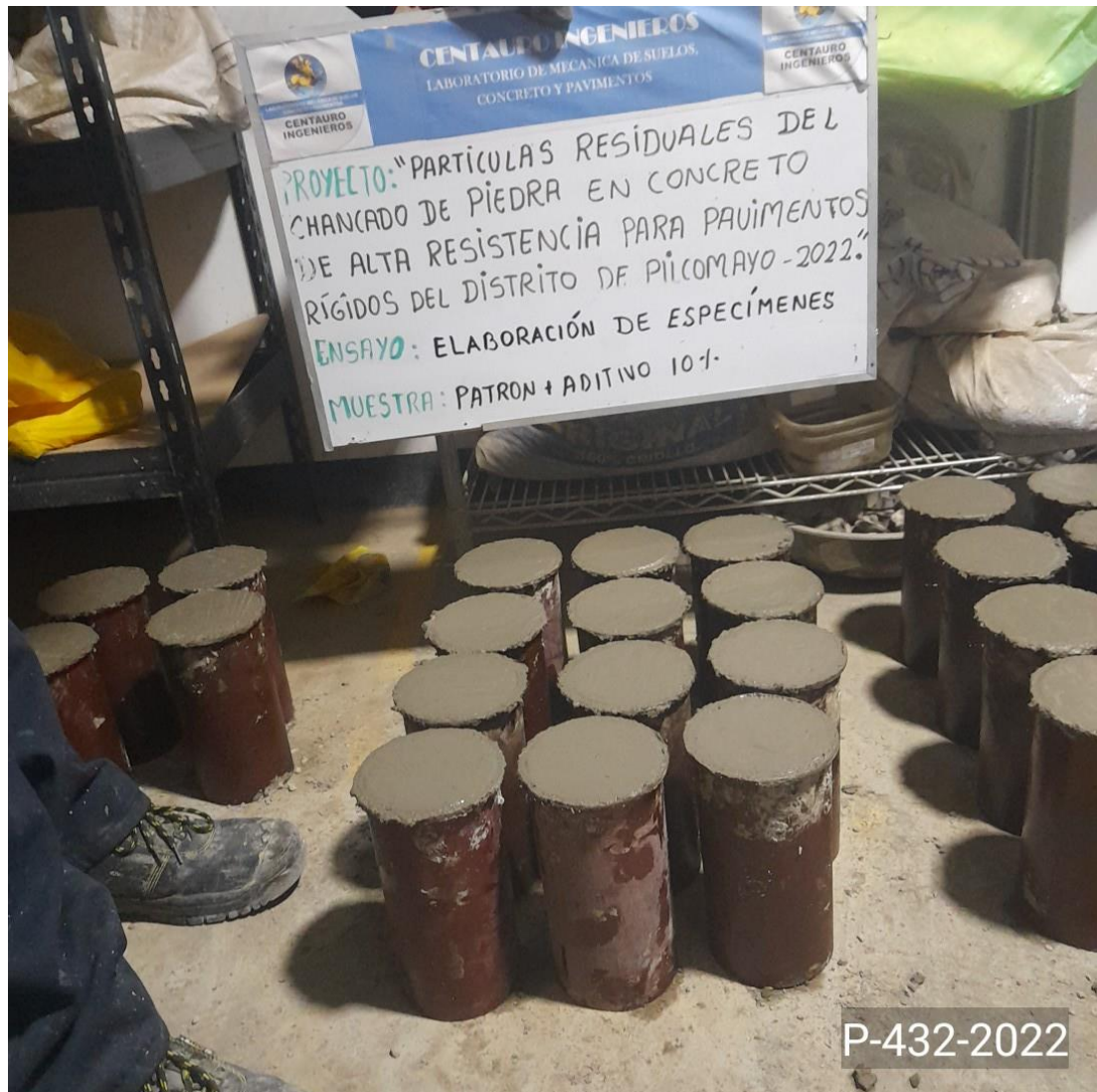
Foto N° 9: Elaboración de especímenes 10%.
