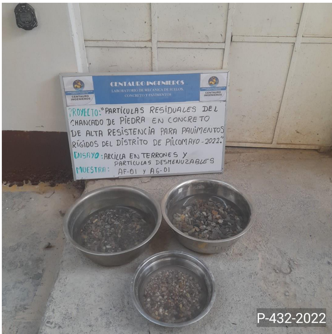
Foto N° 1: Arcilla en terrones y partículas desmenuzables.
