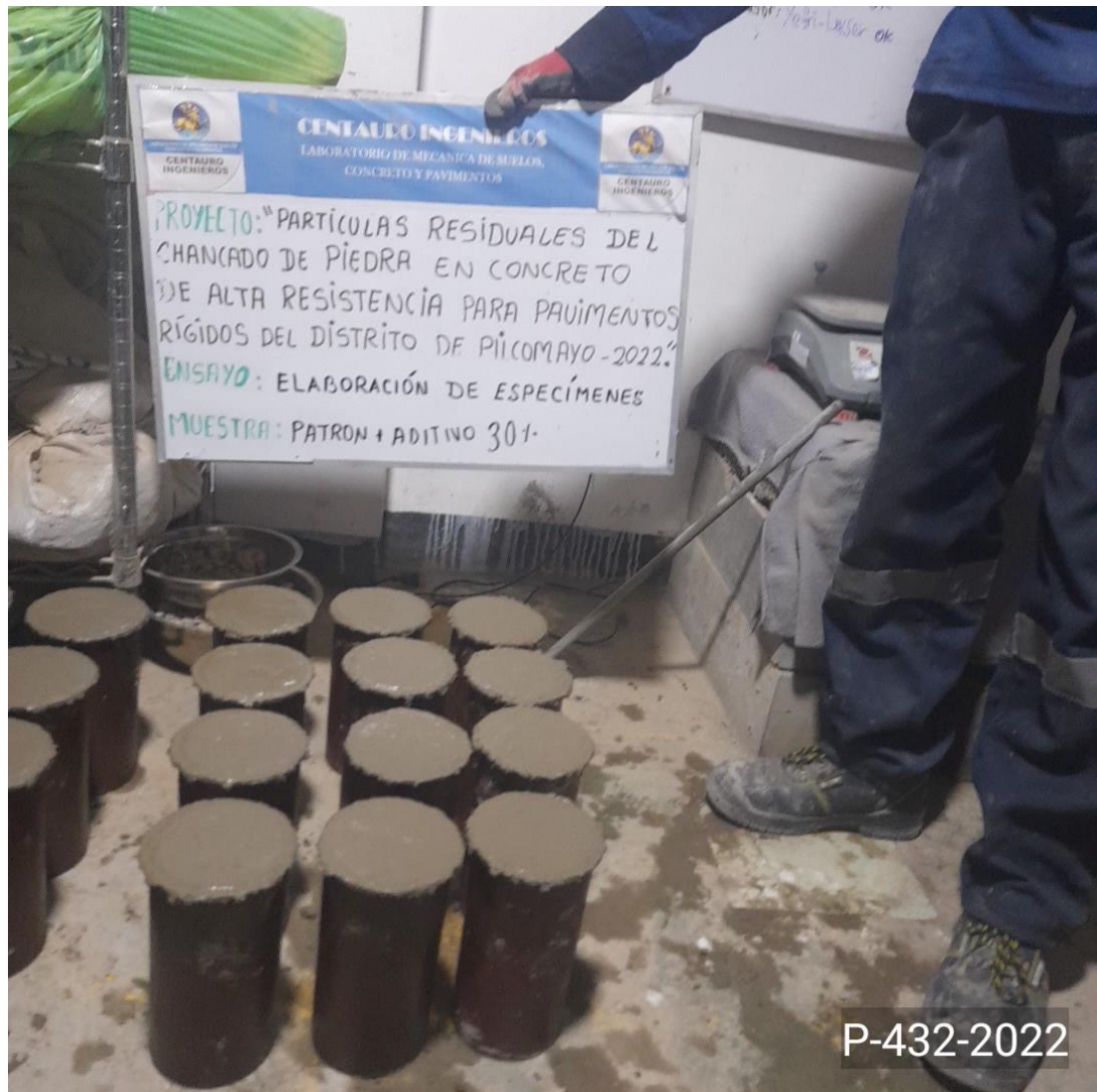
Foto N° 10: Elaboración de especímenes 30%.
