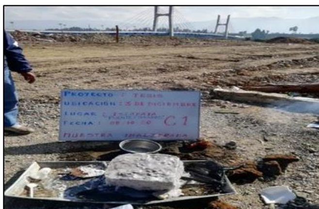
Figura 36. Proceso de parafinado para conservar su humedad.
