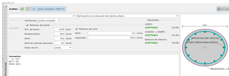
Figura 65. Demandas de pilotes a flexión y compresión con 12ø3/4" de refuerzo vertical y refuerzo de cero de 3/8" en espiral.
