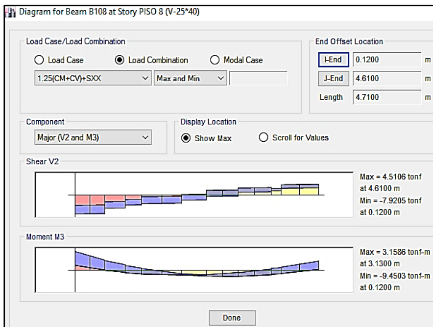
Figura 78. Diagrama de la viga con pilote B108 en el piso 8. Fuente: Modelamiento en el Etabs.
