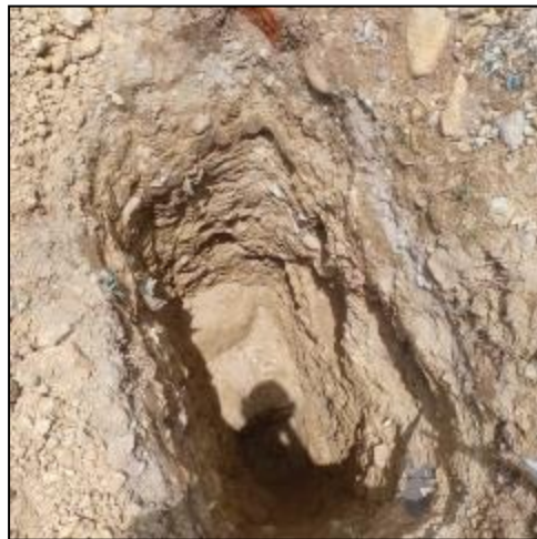
Fotografía 4: En la fotografía se observa la CALICATA No. 02 finalizada con una profundidad total de 3.00 m.
