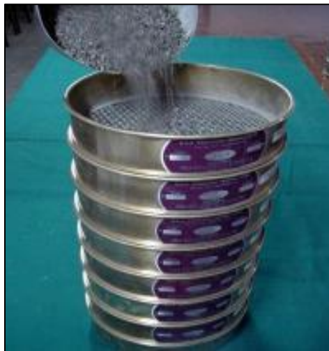
Figura 16: Ensayo de análisis granulométrico.
