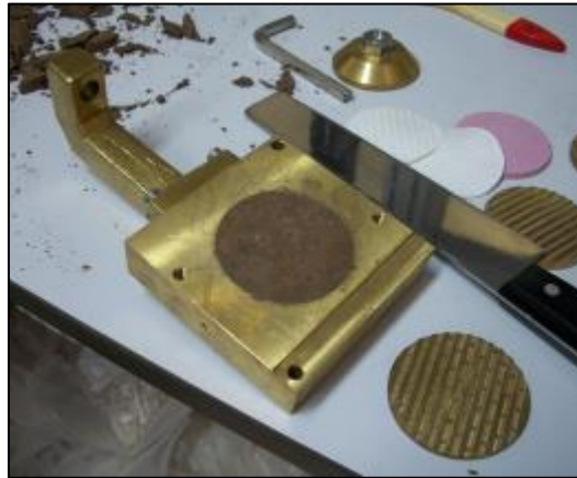
Figura 18: Ensayo de corte directo.
