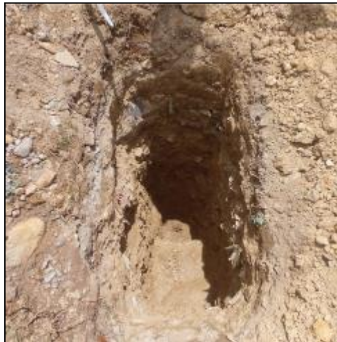
Fotografía 2: En la fotografía se observa la CALICATA No. 01 finalizada con una profundidad total de 3.00 m.
