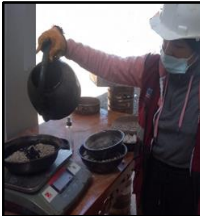
Fotografía 10. Colocado de líquido asfáltico en las muestras de briquetas con agregados
