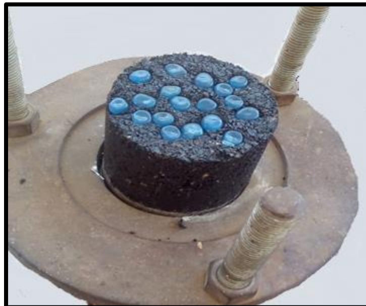
Figura 25. Guijarro de piedra fluorescente compactado en la briqueta
