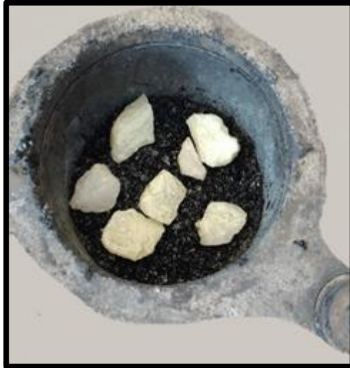
Figura 22. Añadiendo cuarzo a las briquetas en los últimos golpes en la briqueta
