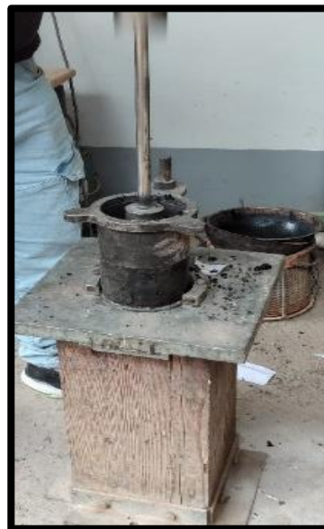
Figura 19. Compactación de las briquetas en 75 golpes
