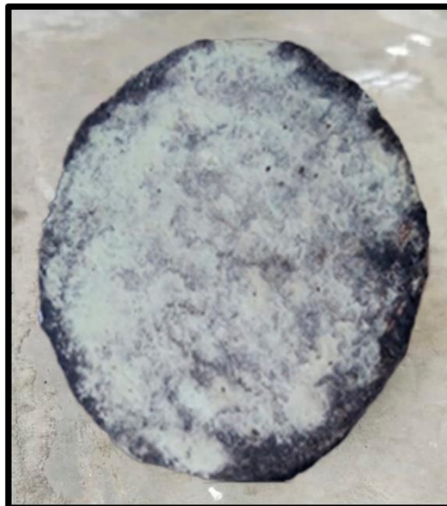
Figura 27. Aluminato de estroncio fluorescente roseado en la briqueta
