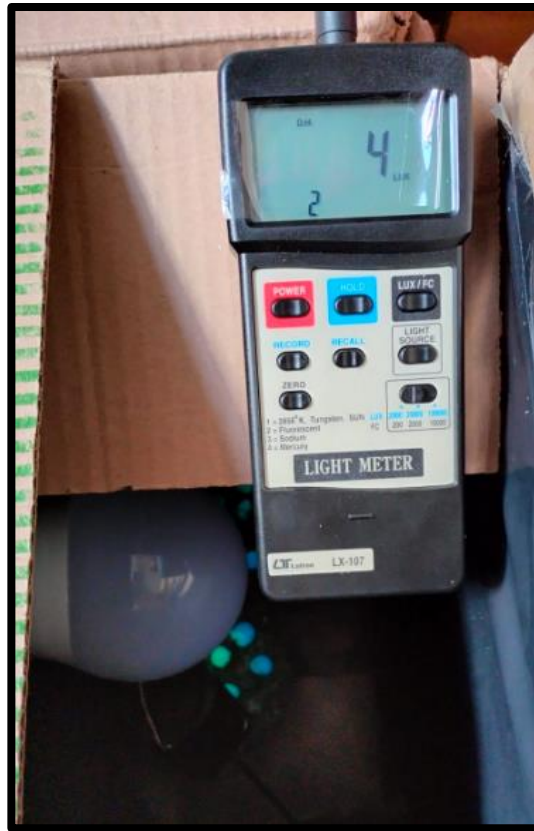
Figura 34. Midiendo con luxómetro adicionando guijarro de piedra fluorescente
