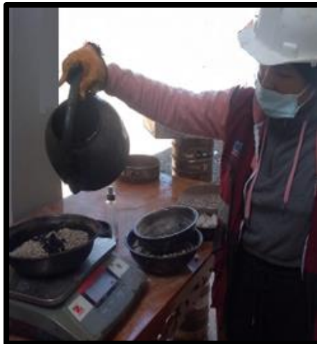
Figura 17. Pesado del porcentaje de asfalto en caliente
