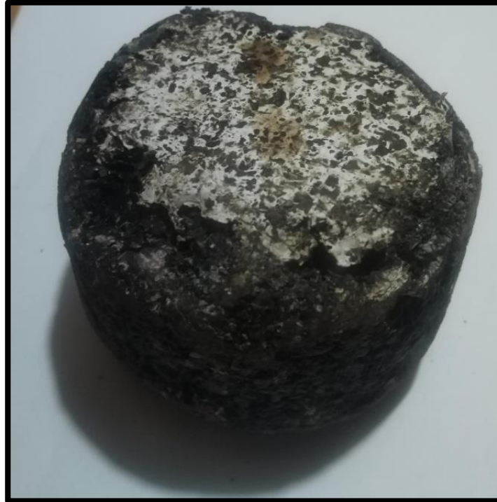
Figura 44. Briqueta patrón después del ensayo cántabro
