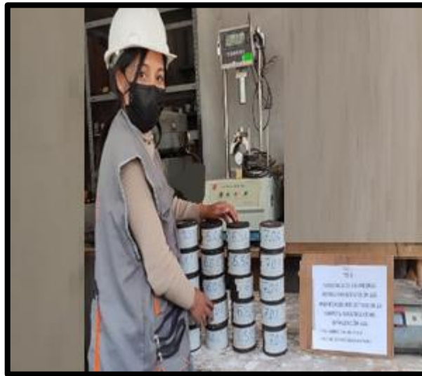
Figura 20. Briquetas MAC desmoldadas
