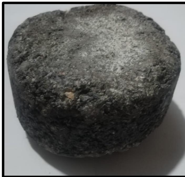
Figura 23. Briqueta después de ensayo cántabro de cuarzo + 10 pasadas de glow
