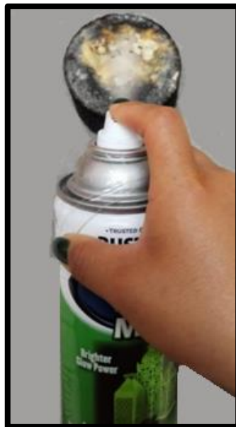
Figura 23. Añadiendo a la briqueta de cuarzo el glow en 10 pasadas
