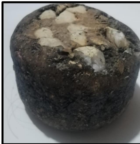
Figura 45. Briqueta con cuarzo + 10 pasadas de glow
