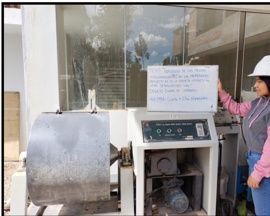
Fotografía 20. Ensayo de cántabro en la máquina de abrasión los ángeles
