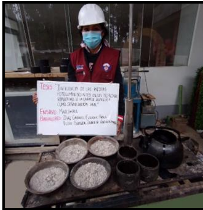
Fotografía 3. Calentado de las muestras para la elaboración de mezclas asfálticas en caliente
