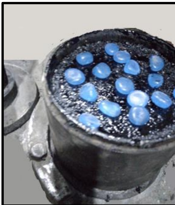
Fotografía 12. Colocado de guijarro de piedras fluorescentes antes del compactad en la elaboración de briquetas
