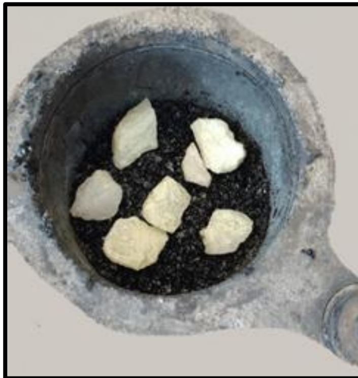
Fotografía 11. Colocado de cuarzo antes del compactado en la elaboración de briqueta
