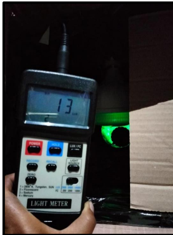
Figura 32. Midiendo con luxómetro adicionando cuarzo + 10 pasadas de glow
