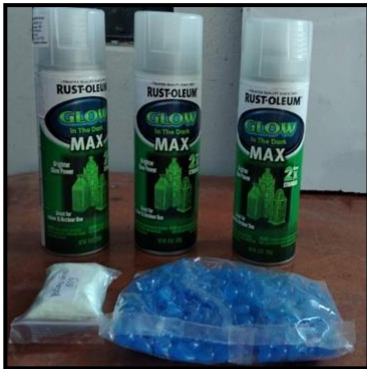
Fotografía 7. Muestra de aditivos utilizados: spray de glow max, aluminato de estroncio y guijarro de piedras fluorescentes
