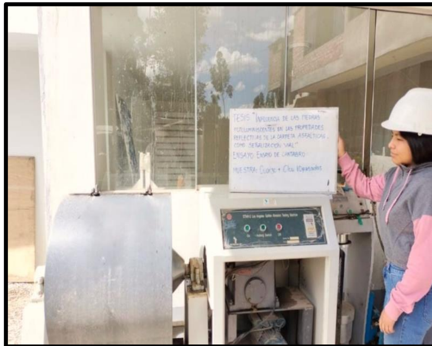
Figura 43. Colocado de briqueta en la máquina de abrasión
