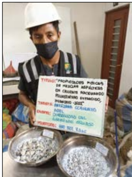
Fotografía N° 12: Determinar la resistencia de los agregados a la desintegración por medio de soluciones mediante el ensayo de Durabilidad al sulfato de magnesio, según referencia de la norma (ASTM C 88M-18 – AASHTO T 104).
