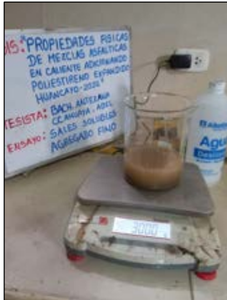
Fotografía N° 20: Elaboración del ensayo de sales solubles con el peso del material con el peso del agua destilada para recaudar todas las sales a ensayar (peso del Baker, aforo total de agua y el volumen utilizado de agua destilada) según referencia de la norma (MTC E 219 – ASTM D 1888).
