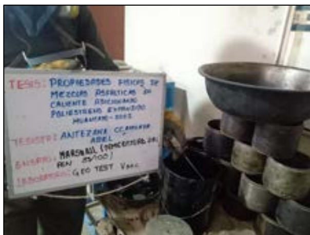
Fotografía N° 35: El pen 85/100 a utilizar debe de estar a un rango de temperatura de mezcla recomendada para producir una buena viscosidad, según referencia de la norma ASTM D 6926 -20.
