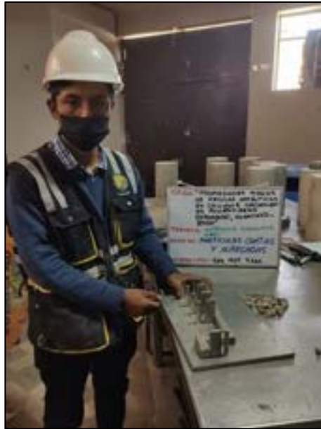
Fotografía N° 9: Método de determinación de los porcentajes de partículas chatas o alargadas en el agregado grueso, según referencia de la norma ASTM D 4791
