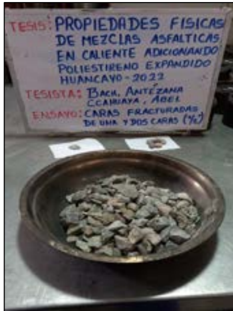
Fotografía N° 11: Determinar el porcentaje de masa del agregado grueso con partículas fracturadas, según referencia de la norma (ASTM D5821).
