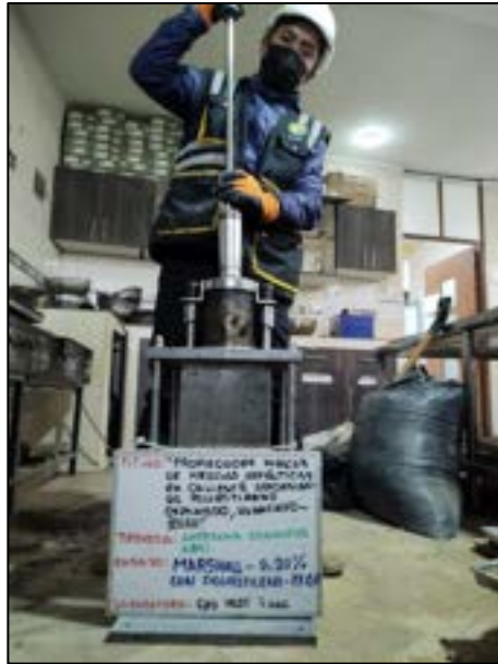
Fotografía N° 47: Compactación del espécimen adicionando el 0.20% de poliestireno, por cara 75 golpes, según referencia de la norma ASTM D 6926 -20.
