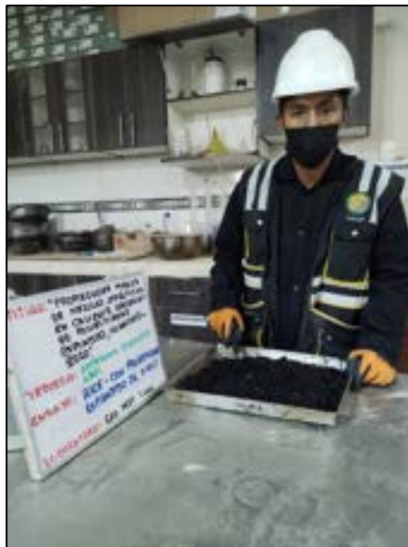
Fotografía N° 66: Después del secado al horno de la mezcla de emulsión con diferentes porcentajes de agua a usar al final del periodo de vacío, que se libera gradualmente. Se mide la temperatura del agua como la masa y el volumen, según referencia de la norma MTC D 2041.
