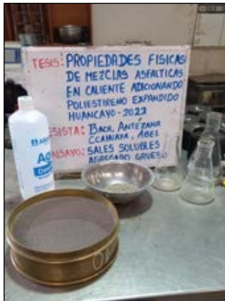
Fotografía N° 14: Determinar el contenido de cloruros y sulfatos con el ensayo de sales solubles (peso del Baker, aforo total de agua y el volumen utilizado de agua destilada) según referencia de la norma (MTC E 219 – ASTM D 1888).
