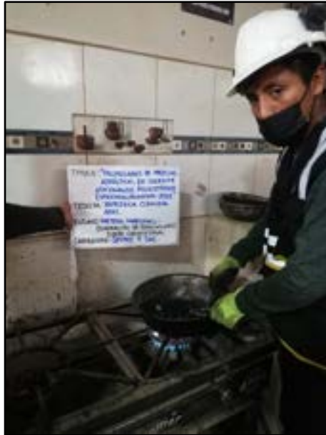
Fotografía N° 37: Mezcla del agregado y el cemento asfáltico hasta que todas las partículas del agregado estén revestidas, según referencia de la norma ASTM D 6926 -20.
