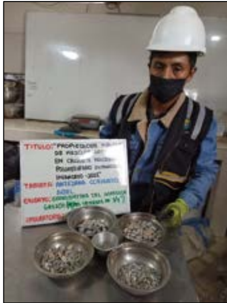
Fotografía N° 1: Determinar la clasificación de los materiales propuestos para uso como agregados con la selección de los tamices adecuados para la Granulometría del agregado grueso (piedra triturada de 3/4”) según referencia de la norma (ASTM C 136 – AASHTO T 88).
