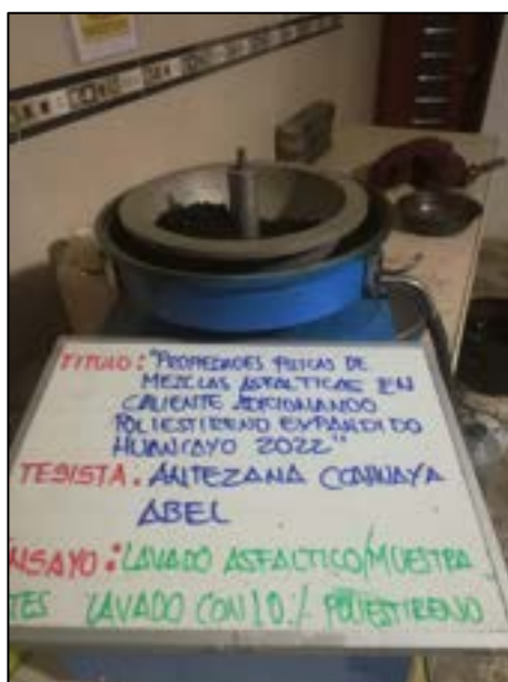
Fotografía N° 60: Extracción cuantitativa de asfalto en mezclas en los pavimentos con el 10% del poliestireno, de forma cuantitativa se coloca la mezcla en caliente del pavimento, según referencia de la norma MTC E 502.
