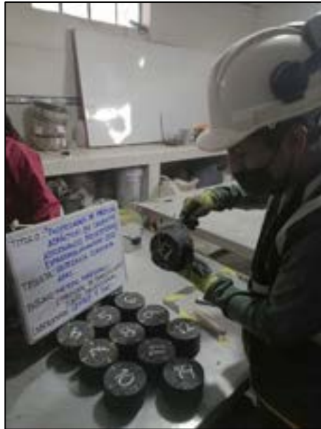
Fotografía N° 51: Después de completar la compactación las briquetas con porcentajes de poliestireno, esperamos un día para poder desmoldar las briquetas que fueron extraídas de los moldes, según referencia de la norma ASTM D 6926 -20.
