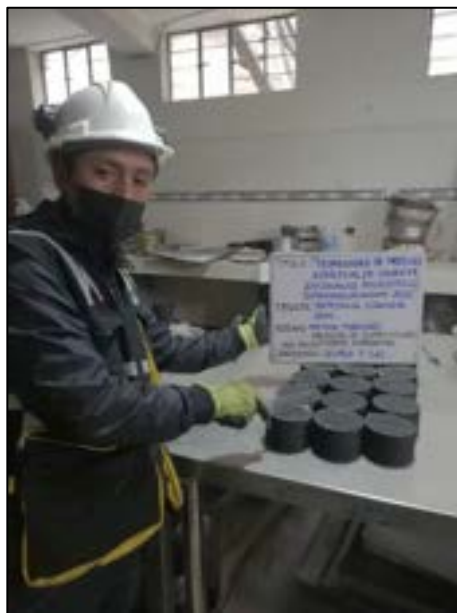
Fotografía N° 40: Después de completar la compactación las briquetas esperamos un día para poder desmoldar las briquetas que fueron extraídas de los moldes, según referencia de la norma ASTM D 6926 -20.
