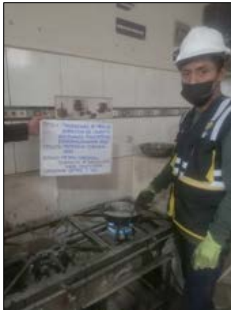
Fotografía N° 34: Preparación del agregado hasta un peso constante en un horno a temperatura de 110^{\circ}\text{C}\pm 5^{\circ}\text{C} , con referencia de la norma ASTM D 6926 -20.
