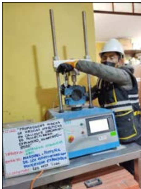
Fotografía N° 56: Prueba de estabilidad y flujo Marshall cubre las mediciones de la resistencia del pavimento de asfalto cargadas en dirección perpendicular del cilindro, según la referencia de la norma ASTM D 6927 – 15.
