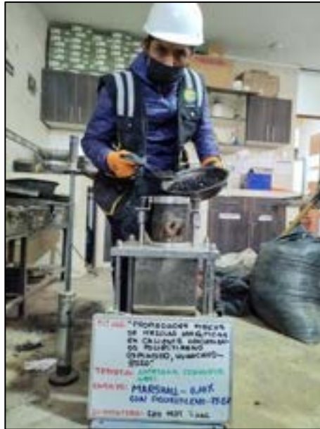
Fotografía N° 45: Relleno en 3 capas del espécimen convencional, en las briquetas adicionando el 0.10% de poliestireno, según referencia de la norma ASTM D 6926 -20.
