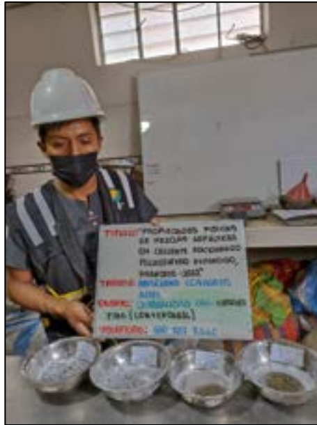
Fotografía N° 13: Determinar la resistencia de los agregados a la desintegración por medio de soluciones mediante el ensayo de Durabilidad al sulfato de magnesio, según referencia de la norma (ASTM C 88M-18 – AASHTO T 104).
