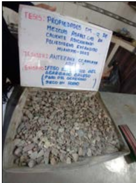
Fotografía N° 25: Determinar la densidad de la masa mediante el ensayo del peso específico saturado del agregado grueso según la norma (ASTM C 127).
