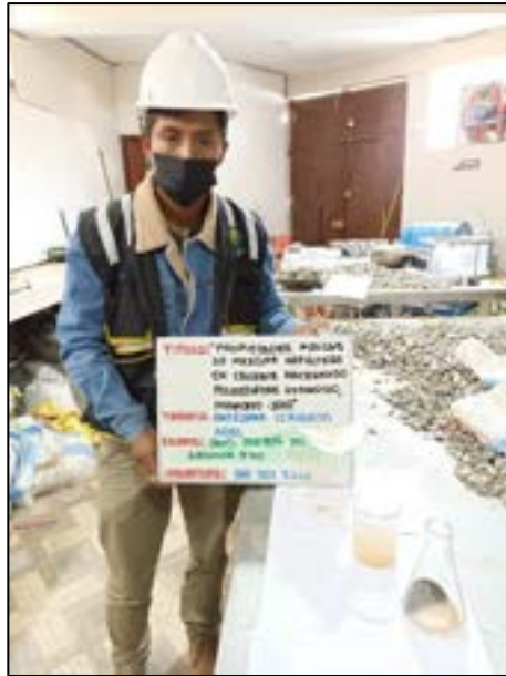
Fotografía N° 21: Determinar los cloruros y sulfatos con el ensayo de sales solubles (peso del Baker, aforo total de agua y el volumen utilizado de agua destilada) según referencia de la norma (MTC E 219 – ASTM D 1888).
