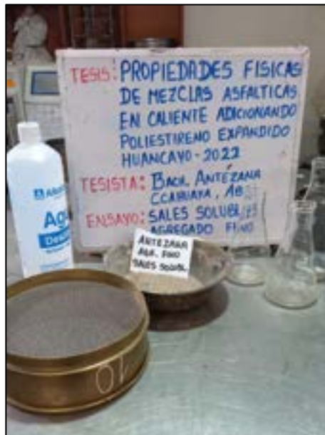
Fotografía N° 18: Determinar el contenido de cloruros y sulfatos con el ensayo de sales solubles (peso del Baker, aforo total de agua y el volumen utilizado de agua destilada) según referencia de la norma (MTC E 219 – ASTM D 1888).
