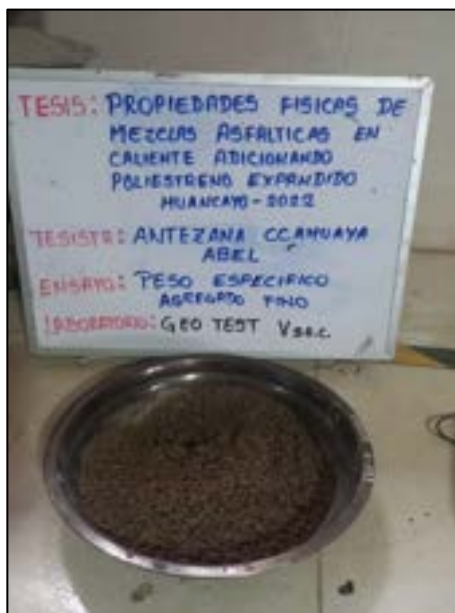
Fotografía N° 26: Determinar la absorción después de 24 horas de sumergido en agua el agregado fino mediante el ensayo de peso específico del agregado fino según referencia de la norma (ASTM C128).
