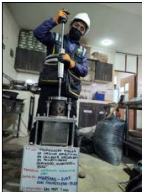
Fotografía N° 46: Compactación del espécimen adicionando el 0.10% de poliestireno, por cara 75 golpes, según referencia de la norma ASTM D 6926 -20.
