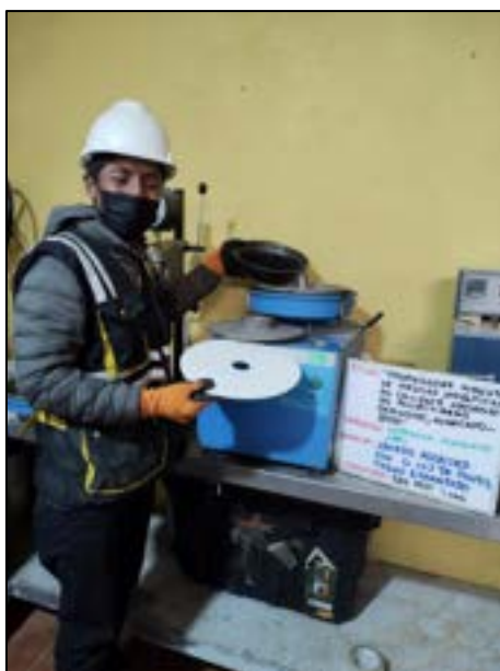
Fotografía N° 59: Calculo en la balanza de la mezcla asfáltica cuantitativamente con el 10% del poliestireno, según referencia de la norma MTC E 502.
