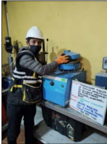
Fotografía N° 65: Extracción cuantitativa de asfalto en mezclas en los pavimentos con el 40% del poliestireno, de forma cuantitativa se coloca la mezcla en caliente del pavimento, según referencia de la norma MTC E 502.
