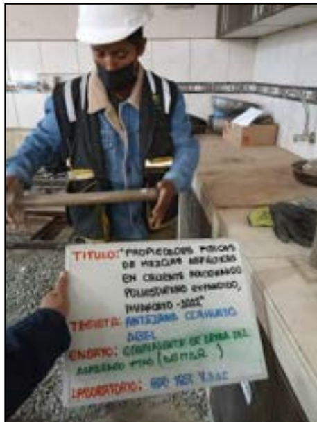
Fotografía N° 32: Determinar la cantidad de material para la limpieza mediante el ensayo de equivalente de arena la altura máxima de material fino y la altura máxima de la arena en pulgadas, según referencia de la norma (ASTM D 2419 –(14) – ASSHTO T 176).
