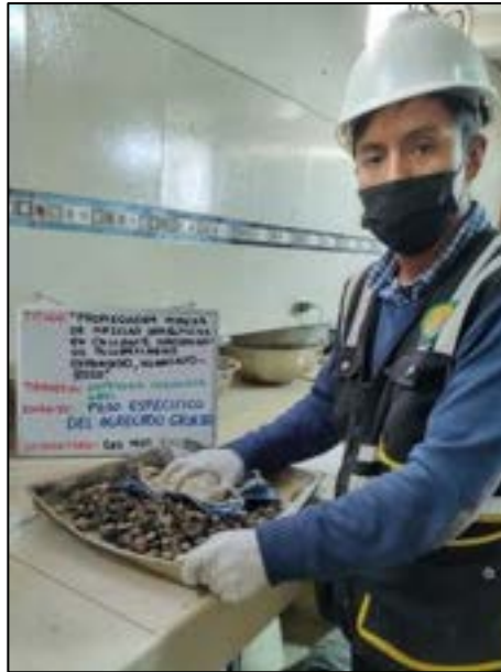
Fotografía N° 23: Determinar la densidad de la masa mediante el ensayo del peso específico partículas en un estado saturado superficialmente seco del agregado grueso, según referencia de la norma (ASTM C 127).
