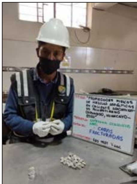
Fotografía N° 10: Determinar el porcentaje de masa del agregado grueso con partículas fracturadas, según referencia de la norma (ASTM D5821).
