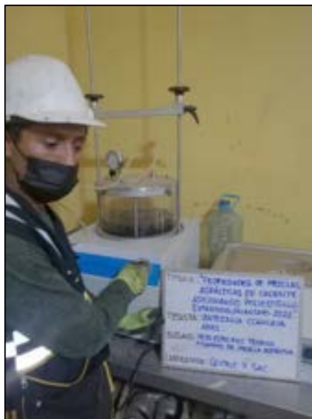
Fotografía N° 68: El equipo se encarga de sacar todos los vacíos gradualmente para reducir la presión residual en el recipiente de vacíos a 4kPa, para luego ponerlo en baño maria y pesándolo llenar al recipiente como se muestra en la fotografía, según referencia de la norma MTC D 2041.
