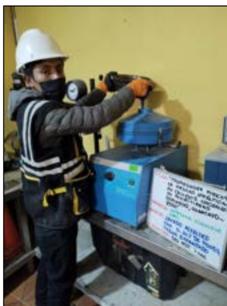
Fotografía N° 62: Extracción cuantitativa de asfalto en mezclas en los pavimentos con el 20% del poliestireno, de forma cuantitativa se coloca la mezcla en caliente del pavimento, según referencia de la norma MTC E 502.
