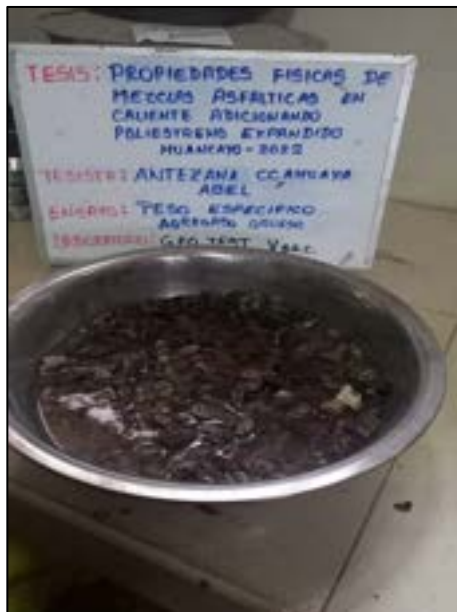
Fotografía N° 22: Determinar la densidad de la masa mediante el ensayo del peso específico saturado por 24 horas, seco del agregado grueso, según referencia de la norma (ASTM C 127).
