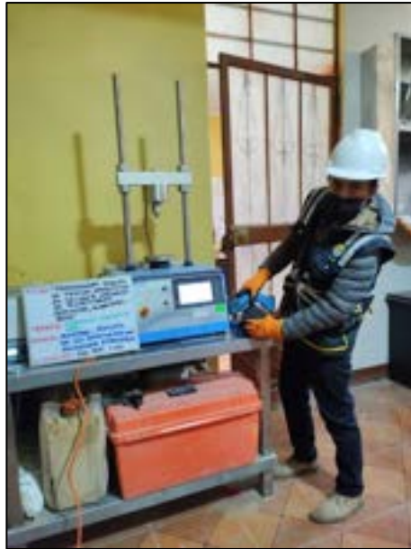
Fotografía N° 55: Prueba de estabilidad y flujo Marshall cubre las mediciones de la resistencia del pavimento de asfalto cargadas en dirección perpendicular del cilindro, según la referencia de la norma ASTM D 6927 – 15.
