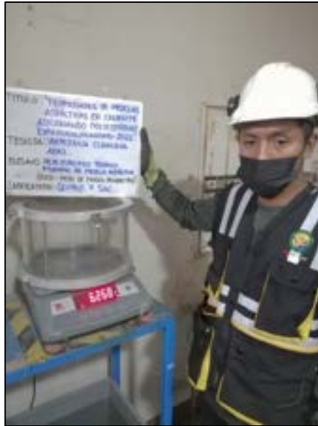
Fotografía N° 67: Después se pesa la masa del equipo de prueba para una primera data. Se mide la temperatura del agua como la masa y el volumen, según referencia de la norma MTC D 2041.
