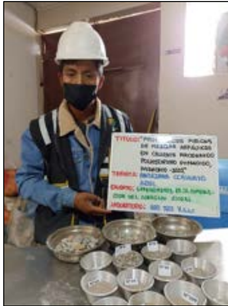
Fotografía N° 5: Determinar la clasificación de los materiales propuestos para uso como agregados con la selección de los tamices adecuados para la Granulometría global del agregado, según referencia de la norma (ASTM C 136 – AASHTO T 88).
