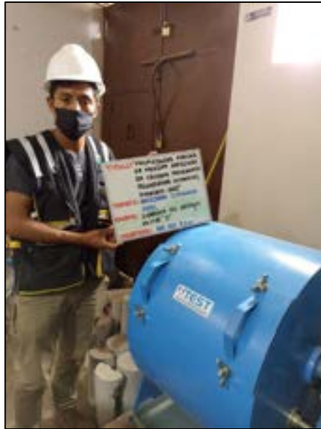
Fotografía N° 7: Determinar la pérdida por desgaste por el método “B” utilizando 11 esferas con la máquina de los ángeles mediante el ensayo de abrasión los ángeles, según referencia de la norma (ASTM C 131 – ASHTO T 96).
