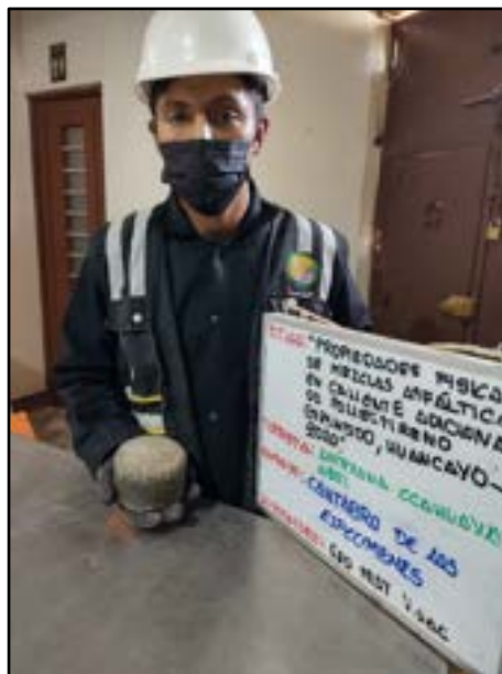
Fotografía N° 72: Determinación del valor de la pérdida por desgaste de la mezcla bituminosa, según referencia de la norma MTC D-352.
