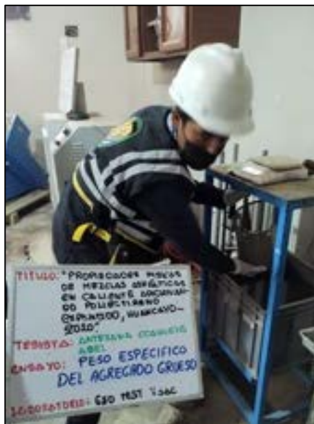
Fotografía N° 24: Determinar la densidad de la masa mediante el ensayo del peso específico saturado del agregado grueso según la norma (ASTM C 127).
