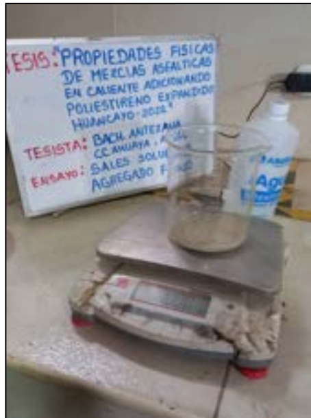
Fotografía N° 19: Elaboración del ensayo de sales solubles con el peso del material a ensayar (peso del Baker, aforo total de agua y el volumen utilizado de agua destilada) según referencia de la norma (MTC E 219 – ASTM D 1888).
