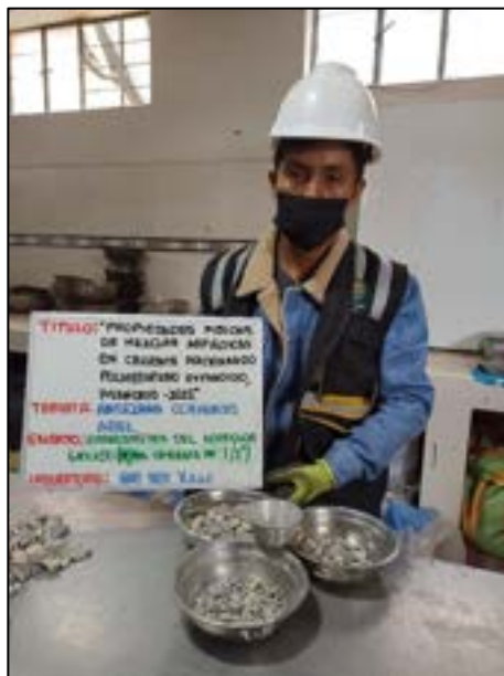
Fotografía N° 2: Determinar la clasificación de los materiales propuestos para uso como agregados con la selección de los tamices adecuados para la Granulometría del agregado grueso (piedra triturada de 1/2”) según referencia de la norma (ASTM C 136 – AASHTO T 88).
