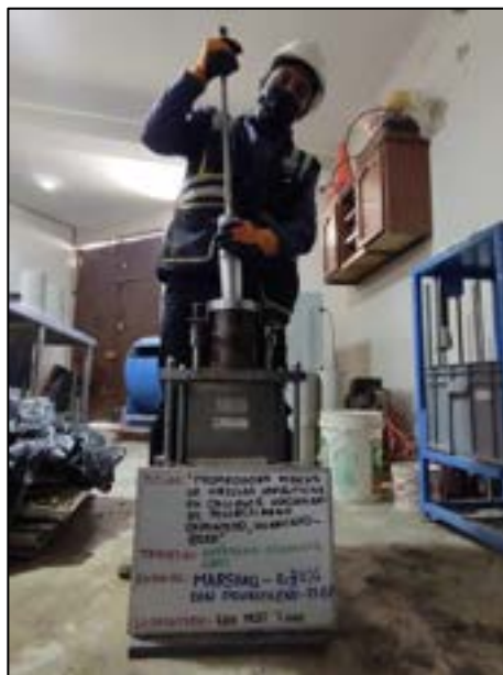
Fotografía N° 48: Compactación del espécimen adicionando el 0.30% de poliestireno, por cara 75 golpes, según referencia de la norma ASTM D 6926 -20.
