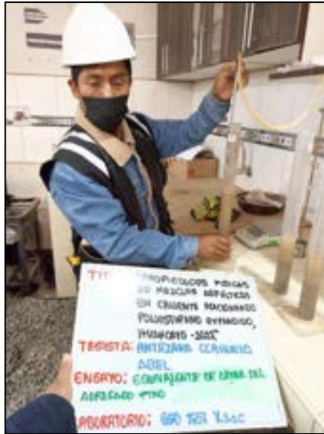
Fotografía N° 33: Determinar la cantidad de material para la limpieza mediante el ensayo de equivalente de arena la altura máxima de material fino y la altura máxima de la arena en pulgadas, según referencia de la norma (ASTM D 2419 –(14) – ASSHTO T 176).
