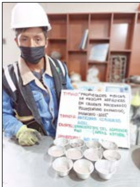
Fotografía N° 4: Determinar la clasificación de los materiales propuestos para uso como agregados con la selección de los tamices adecuados para la Granulometría del agregado fino (arena natural) según referencia de la norma (ASTM C 136 – AASHTO T 88).
