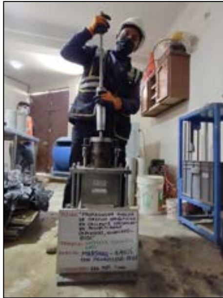
Fotografía N° 49: Compactación del espécimen adicionando el 0.40% de poliestireno, por cara 75 golpes, según referencia de la norma ASTM D 6926 -20.
