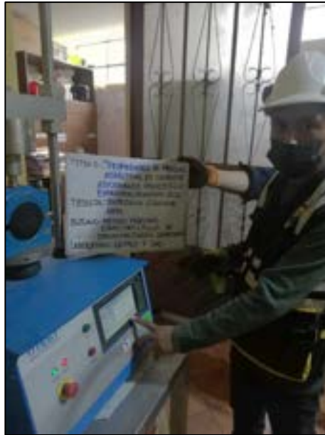
Fotografía N° 57: Prueba de estabilidad y flujo Marshall cubre las mediciones de la resistencia del pavimento de asfalto con los porcentajes de poliestireno cargadas en dirección perpendicular del cilindro, según la referencia de la norma ASTM D 6927 – 15.
