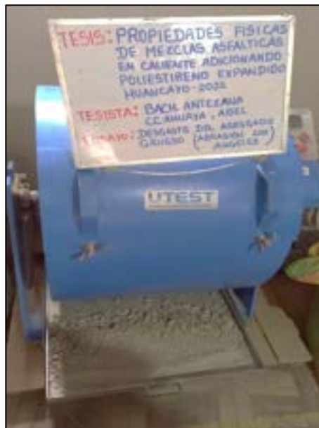
Fotografía N° 6: Determinar la pérdida por desgaste por el método “B” utilizando 11 esferas con la máquina de los ángeles mediante el ensayo de abrasión los ángeles, según referencia de la norma (ASTM C 131 – ASHTO T 96).
