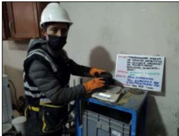
Fotografía N° 52: Peso al aire libre para poder conservar el peso con los vacíos libres, según la referencia de la norma ASTM D 1188-07.
