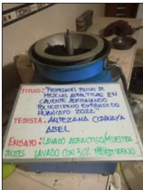
Fotografía N° 63: Extracción cuantitativa de asfalto en mezclas en los pavimentos con el 30% del poliestireno, de forma cuantitativa se coloca la mezcla en caliente del pavimento, según referencia de la norma MTC E 502
