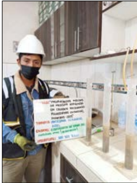
Fotografía N° 31: Determinar la cantidad de material para la limpieza mediante el ensayo de equivalente de arena la hora de saturación y decantación según referencia de la norma (ASTM D 2419 – (14) – ASSHTO T 176).
