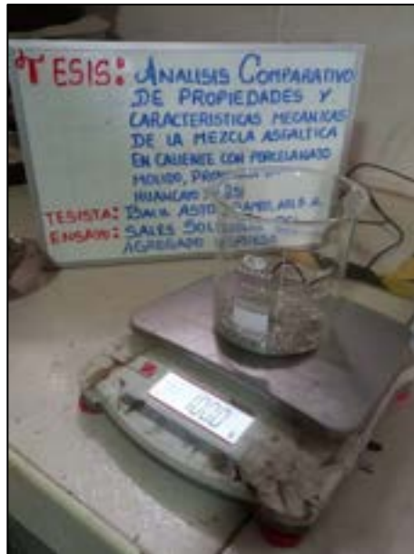
Fotografía N° 15: Elaboración del ensayo de sales solubles con el peso del material a ensayar (peso del Baker, aforo total de agua y el volumen utilizado de agua destilada) según referencia de la norma (MTC E 219 – ASTM D 1888).
