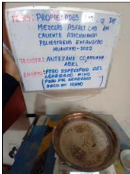
Fotografía N° 30: Determinar la absorción después de 24 horas de sumergido en agua el agregado fino mediante el ensayo de peso específico del agregado fino según referencia de la norma (ASTM C128).
