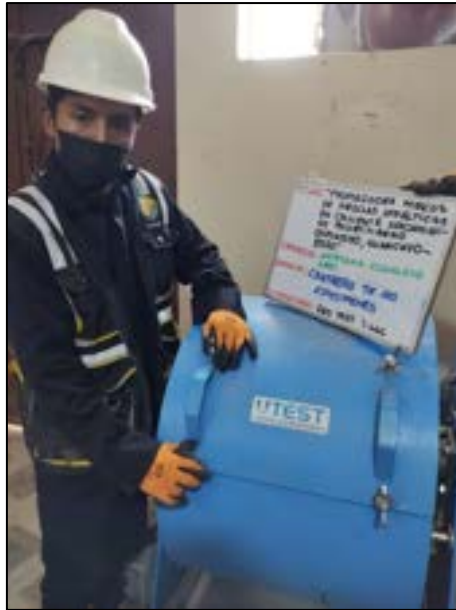
Fotografía N° 71: Mezcla bituminosa puesta en el equipo para calcular la resistencia de disgregación de mezcla ante efectos abrasivos, según referencia de la norma MTC D – 352.
