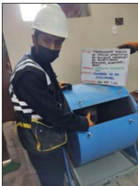
Fotografía N° 70: Mezcla bituminosa caliente de granulometría abierta, donde la resistencia de disgregación de mezcla ante efectos abrasivos, según referencia de la norma MTC D – 352.
