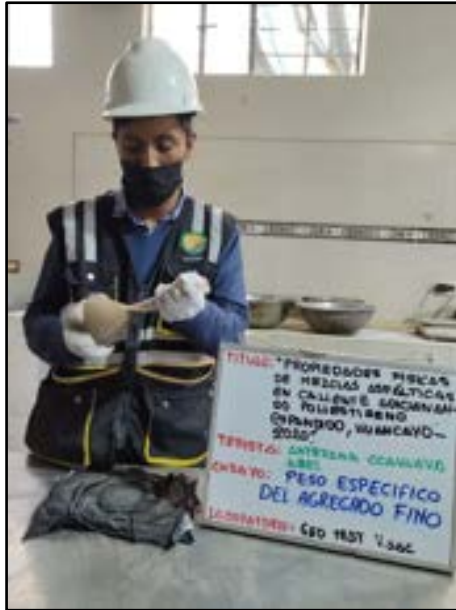
Fotografía N° 29: Determinar la absorción después de 24 horas de sumergido en agua el agregado fino mediante el ensayo de peso específico del agregado fino según referencia de la norma (ASTM C128).
