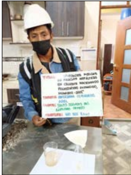
Fotografía N° 17: Determinar los cloruros y sulfatos con el ensayo de sales solubles (peso del Baker, aforo total de agua y el volumen utilizado de agua destilada) según referencia de la norma (MTC E 219 – ASTM D 1888).
