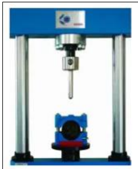
Figura 6. Ensayo Marshall para briquetas.
