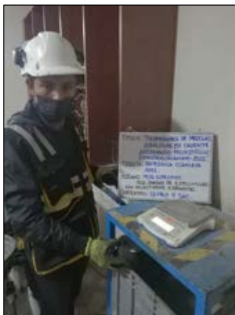
Fotografía N° 42: Luego del desmolde cuando la briqueta ya está fría, y libre de materiales extraños como el papel, que se puso al momento de compactar, se sumerge al agua y se mesa con una canastilla especial mientras está suspendido, según la referencia de la norma ASTM D 1188-07.
