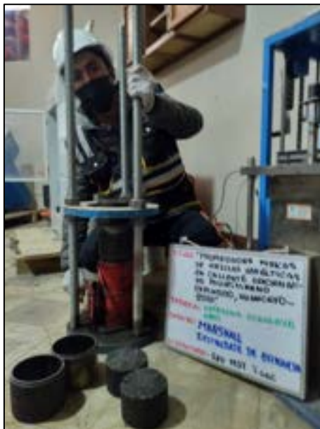
Fotografía N° 50: Después de completar la compactación las briquetas esperamos un día para poder desmoldar las briquetas con porcentajes de poliestireno, que fueron extraídas de los moldes, según referencia de la norma ASTM D 6926 -20.
