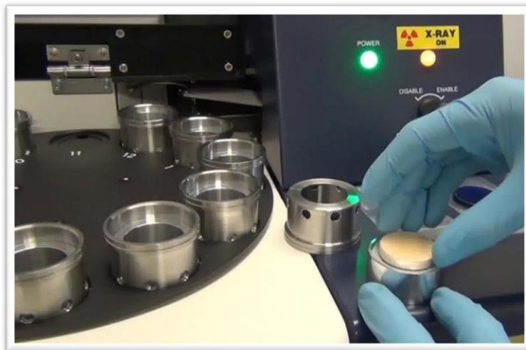
Foto 4. Se observa la muestra 1 (pastilla) donde se está introduciendo al equipo de espectrometría XRF para la irradiación
