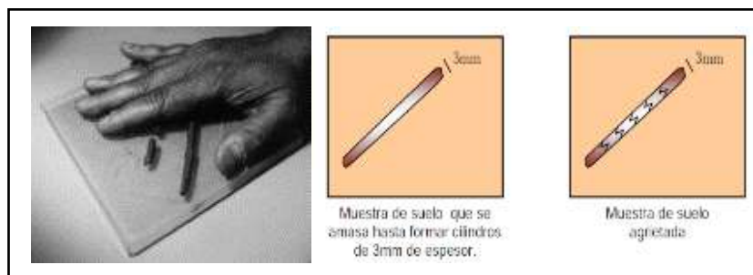
Figura 2.20. Prueba del límite plástico
