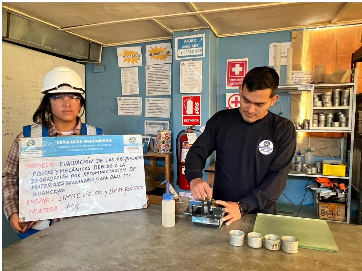
Fotografía N°03. Ensayo de límites de consistencia.
