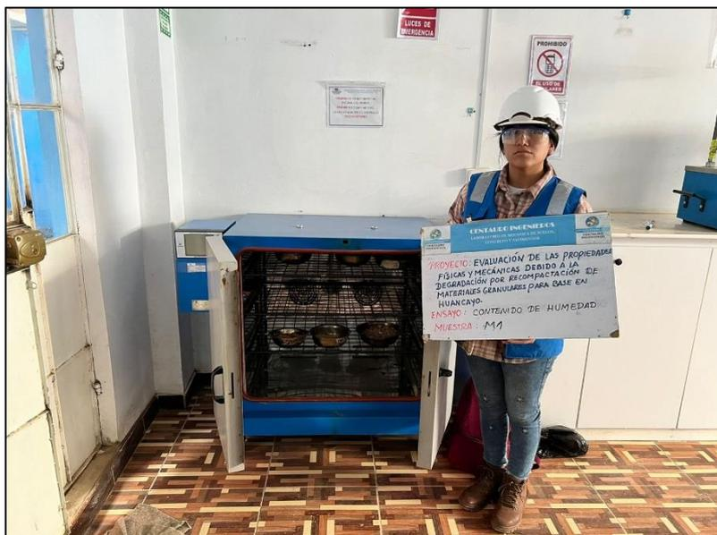
**Figura 4.11** *Ensayo contenido de humedad.*
