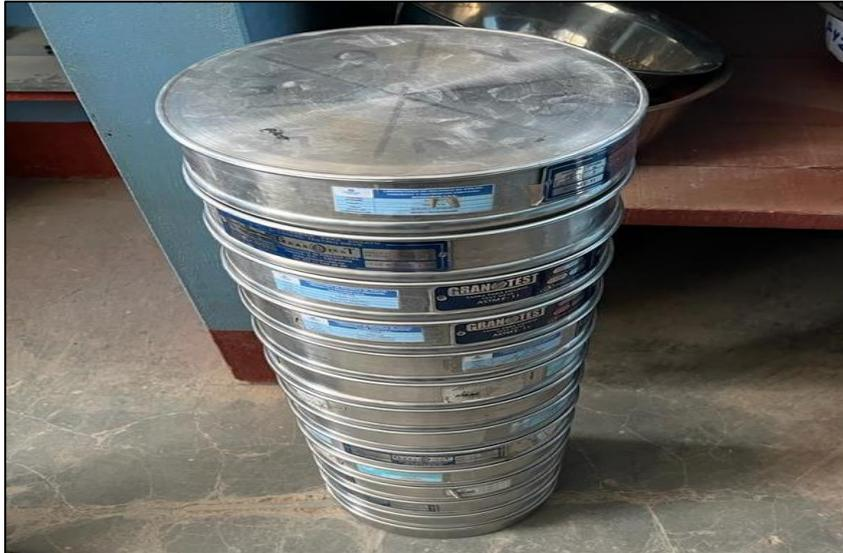
**Figura 4.6** Juego de tamices para el ensayo de granulometría.
