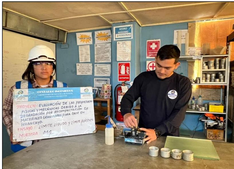
**Figura 4.10** *Ensayo límite líquido.*
