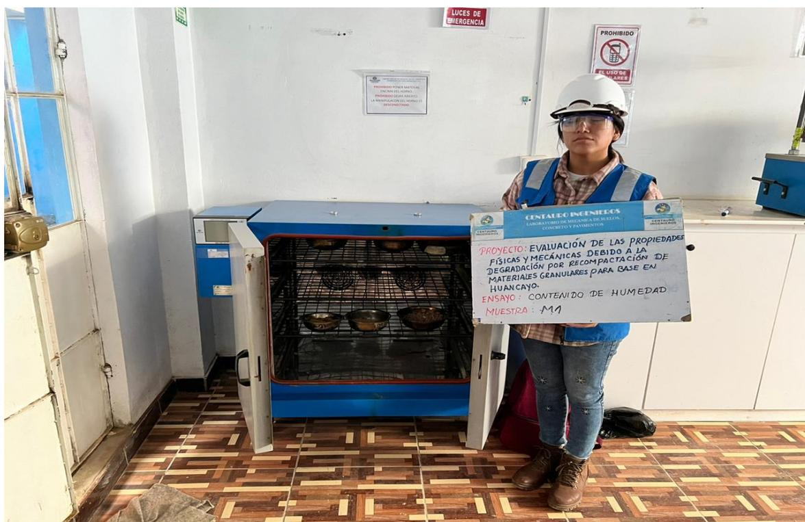
Fotografía N°04. Ensayo de contenido de humedad.
