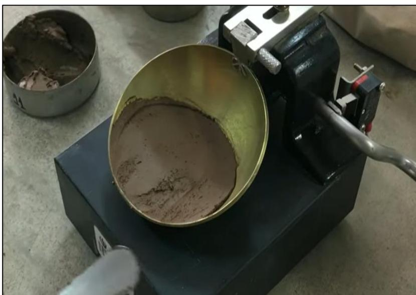
**Figura 4.9** *Ensayo límite líquido.*
