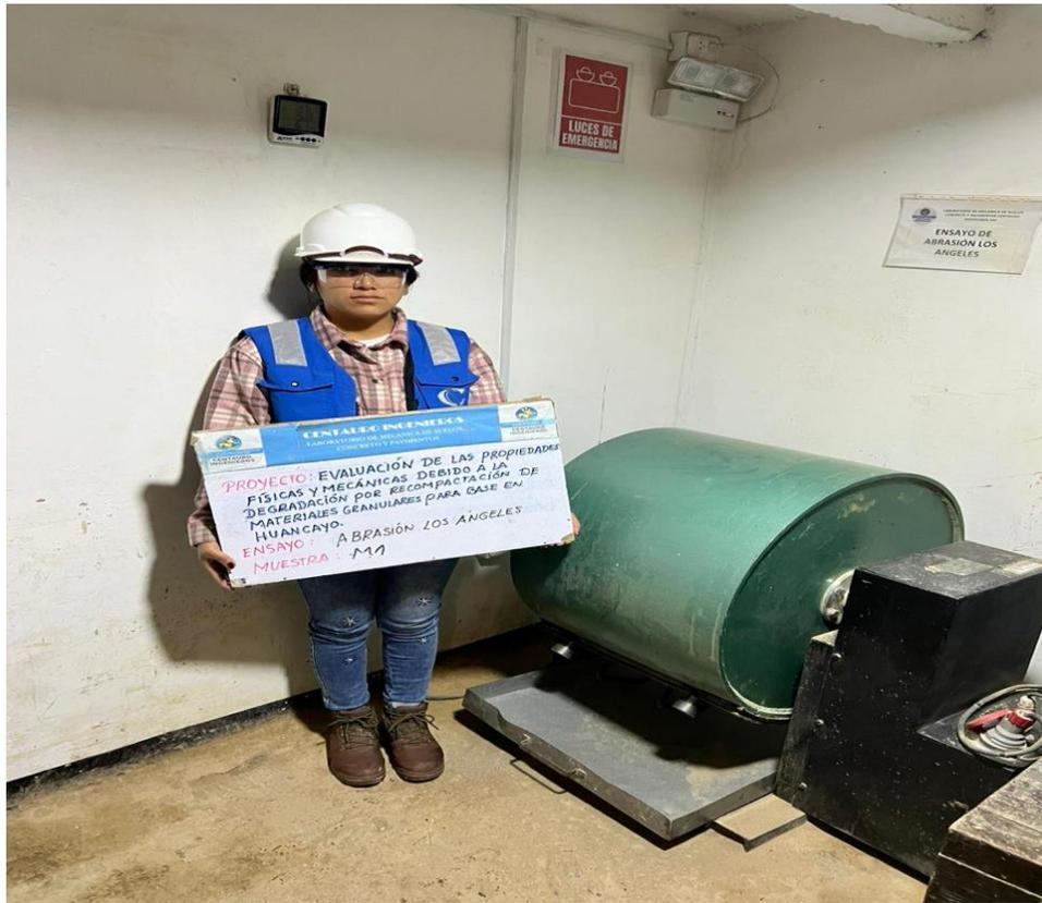
Fotografía N°05. Ensayo de abrasión los Ángeles.
