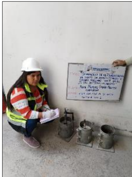
Fotografía 21: Ensayo de CBR del material convencional más el 10% de cemento portland tipo I
