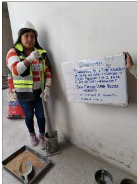
Fotografía 20: Ensayo de CBR del material convencional más el 6% de cemento portland tipo I
