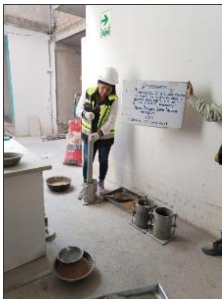
Fotografía 18: Ensayo de CBR del material convencional
