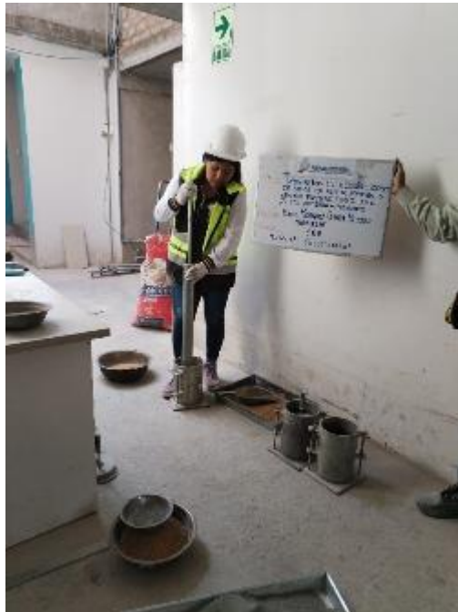
Figura 5: ensayo de CBR del material convencional
