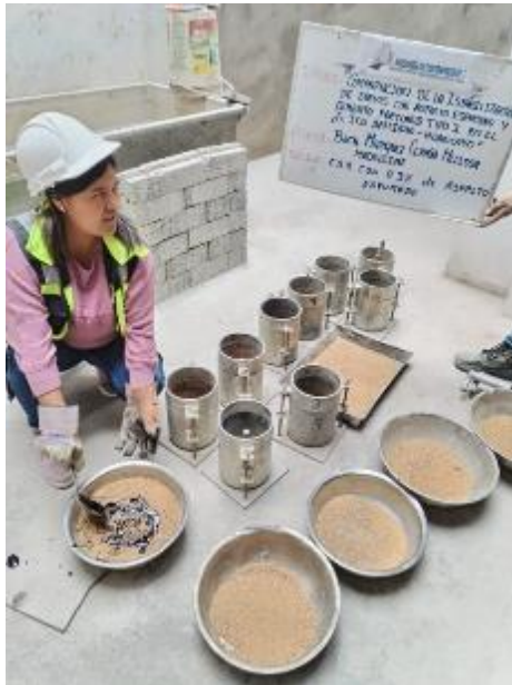
Fotografía 24: Ensayo de CBR del material convencional más el 3% de asfalto espumado
