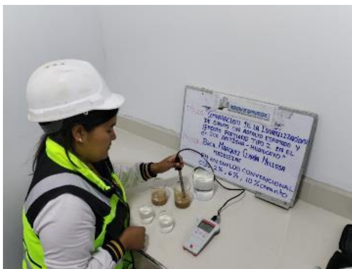
Fotografía 26: PH del suelo del material convencional más el cemento portland tipo I
