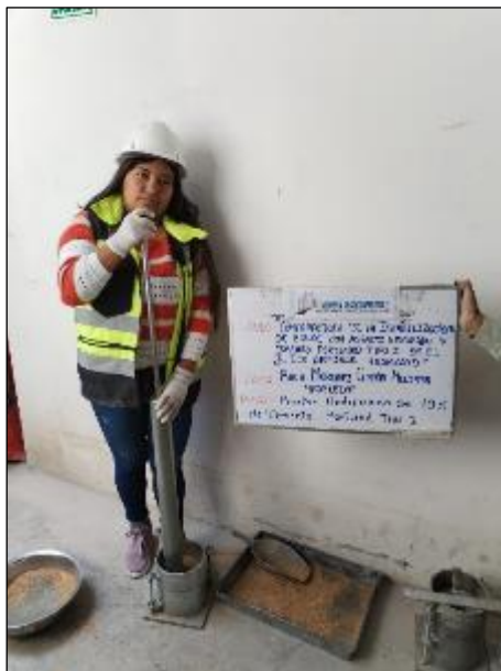
Fotografía 17: Ensayo del Proctor modificado del material convencional más 10% de cemento portland tipo I
