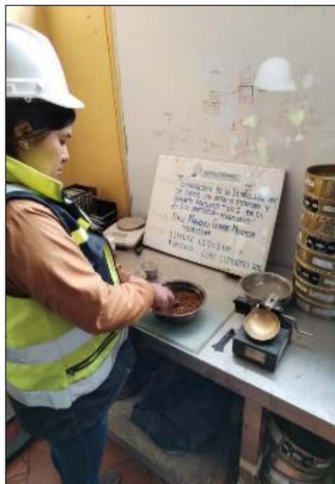
Fotografía 8: Ensayo de los límites de consistencia del material convencional más el cemento portland tipo I al 2%, referencia de la norma MTC E 110 y MTC E111
