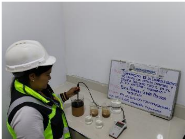
Fotografía 25: PH del suelo del material convencional más el asfalto espumado
