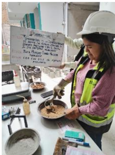
Fotografía 22: Ensayo de CBR del material convencional más el 1% de asfalto espumado
