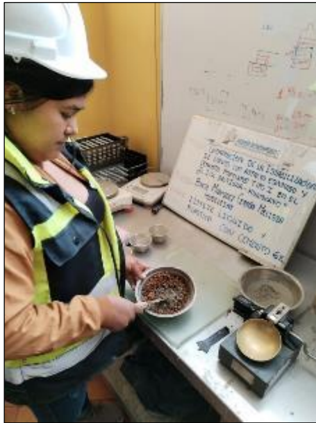
Fotografía 9: Determinación del límite plástico del material convencional más el cemento portland tipo I al 6%, MTC E 111
