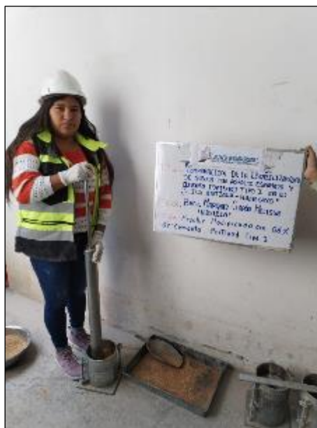
Fotografía 16: Ensayo del Proctor modificado del material convencional más 6% de cemento portland tipo I
