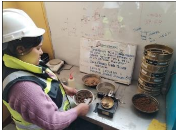
Fotografía 7: Ensayo del límite líquido del material convencional mas el 3% del asfalto espumado
