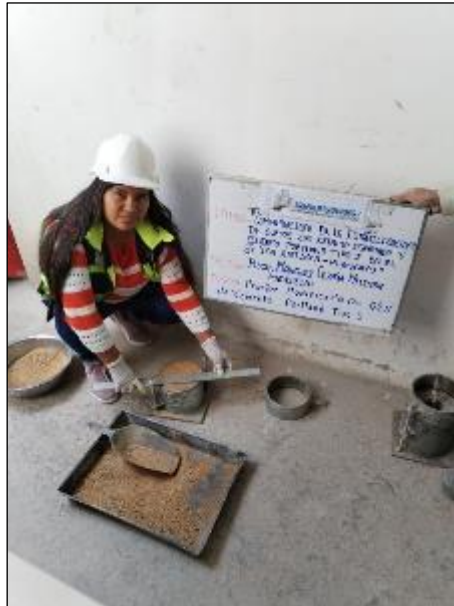
Fotografía 15: Ensayo del Proctor modificado del material convencional más 2% de cemento portland tipo I
