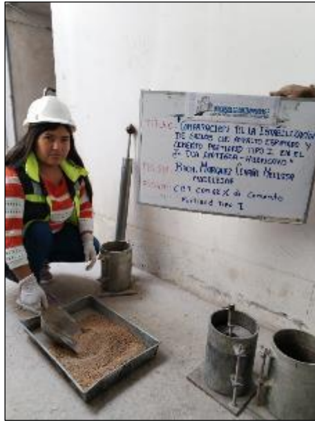
Fotografía 19: Ensayo de CBR del material convencional más el 2% de cemento portland tipo I
