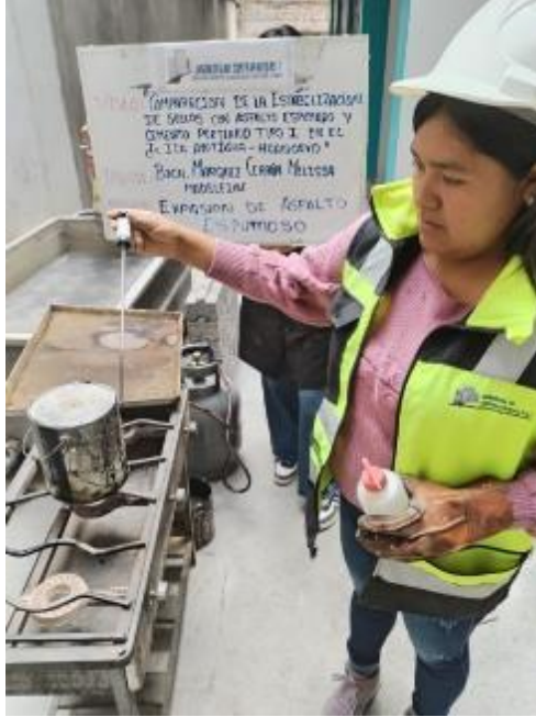
Fotografía 1: calentamiento del cemento asfáltico e inyección de agua al cemento asfáltico caliente
