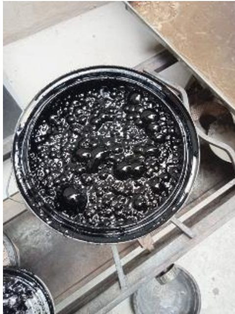
Fotografía 2: Desarrollo del asfalto espumado
