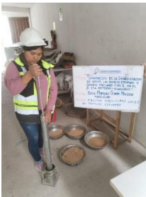
Fotografía 12: Ensayo del Proctor modificado del material convencional más 1% de asfalto espumado
