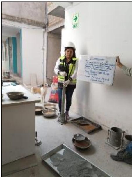
Fotografía 11: Ensayo del Proctor modificado del material convencional
