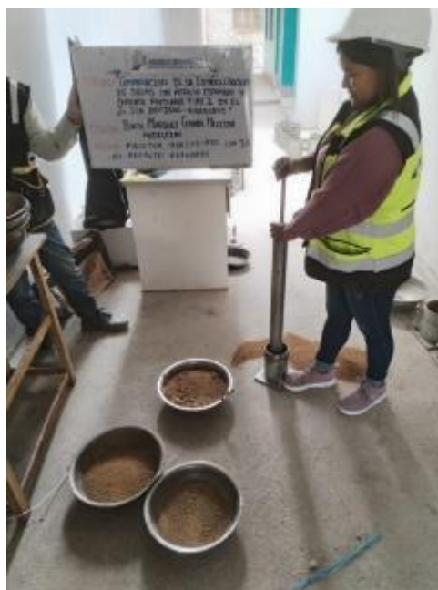
Fotografía 14: Ensayo del Proctor modificado del material convencional más 3% de asfalto espumado
