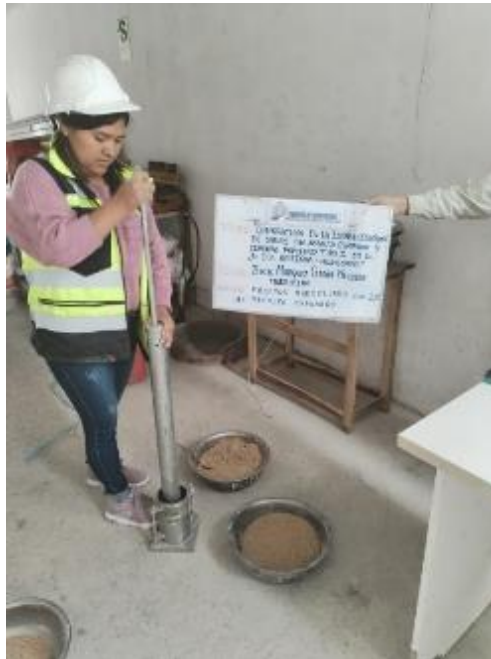
Fotografía 13: Ensayo del Proctor modificado del material convencional más 2% de asfalto espumado
