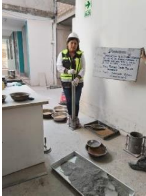
Figura 4: Proctor modificado del material convencional
