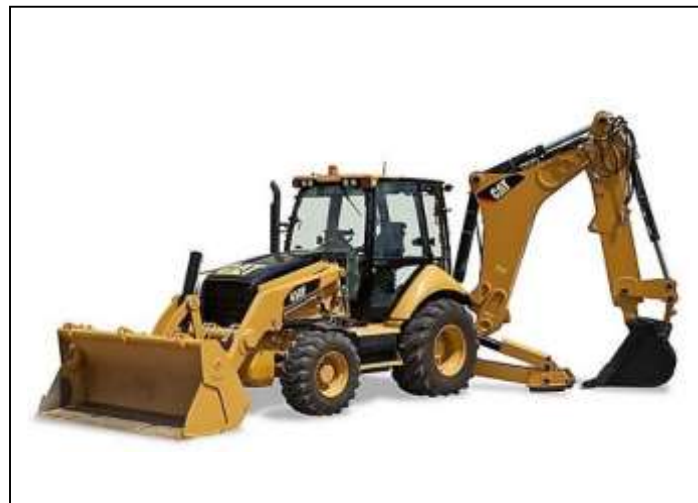
Figura 6. Retroexcavadora CAT sobre llantas. Fuente: Manual Caterpillar.
