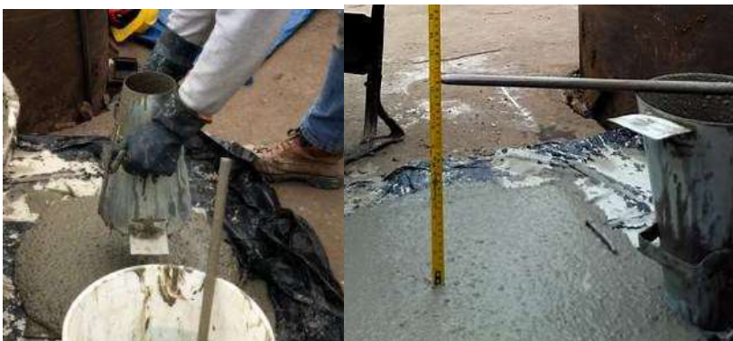
Figura N° 3: Ensayo de cono de Abrams del concreto.
