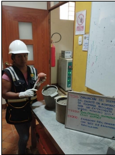
Fotografía 29: Control de la exudación del concreto con 30% de escombro reciclado, según referencia de la norma NTP 339.077.
