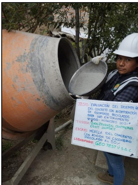
Fotografía 32: Vista de materiales tales como el cemento para la elaboración del concreto con 50% de escombros reciclados, según referencia de la norma NTP 339.183.
