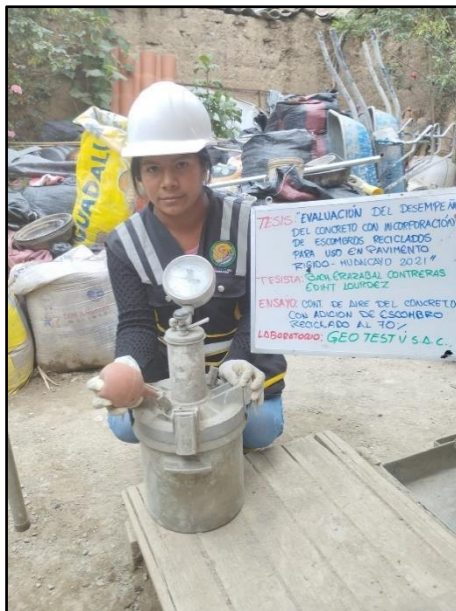
Fotografía 50: Control del contenido de aire del concreto fresco con adición del 70% de escombros reciclado por el método de presión. Según NTP 339.083.
