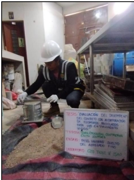
Fotografía 8: Determinación del Peso unitario suelto y el porcentaje de los vacíos del agregado fino, según referencia de la norma NTP 400.017.
