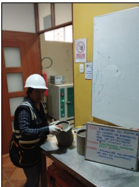
Fotografía 41: Control de la exudación del concreto con 50% de escombro reciclado, según referencia de la norma NTP 339.077.
