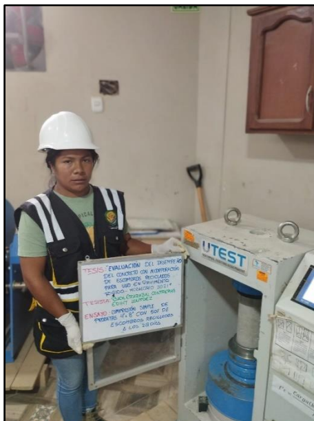
Fotografía 70: Testigos cilíndricos incorporados con 50% de escombros reciclados para la resistencia a la compresión de los 28 días de edad, según referencia de la norma NTP 339.034 / ASTM C39.
