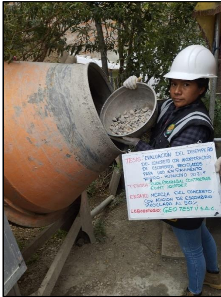
Fotografía 33: Vista de materiales tales como el agregado grueso para la elaboración del concreto con 50% de escombros reciclados, según referencia de la norma NTP 339.183.
