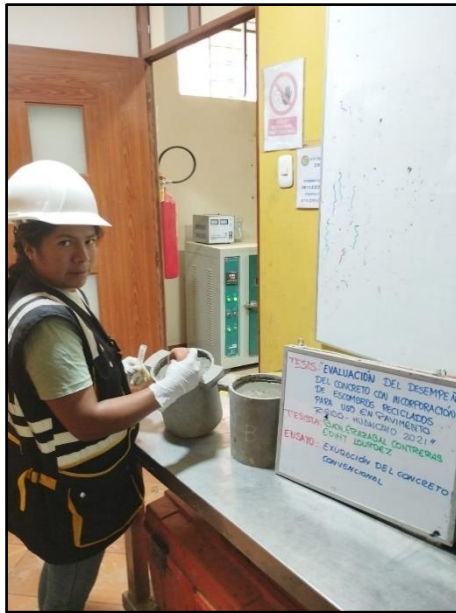
Fotografía 17: Control de la exudación del concreto convencional, según referencia de la norma NTP 339.077.
