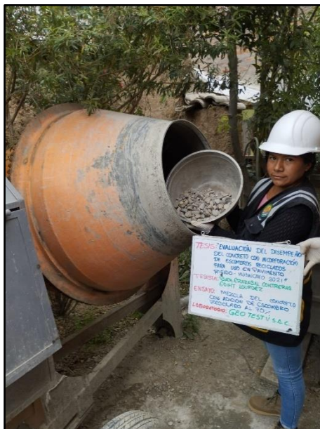
Fotografía 44: Vista de materiales tales como el agregado grueso para la elaboración del concreto con adición del 70% de escombros reciclados, según referencia de la norma NTP 339.183.
