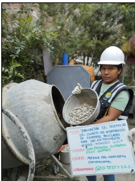
Fotografía 12: Vista de materiales tales como el agregado grueso para la elaboración del concreto convencional, según referencia de la norma NTP 339.183.
