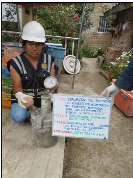
Fotografía 28: Control del contenido de aire del concreto fresco con 30% de escombros reciclado, por el método de presión. Según NTP 339.083.
