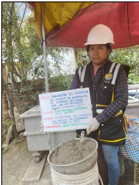
Fotografía 37: Medición de la temperatura del concreto saliendo de la mezcladora con 50% de escombros reciclado, según referencia de la norma NTP 339.184.
