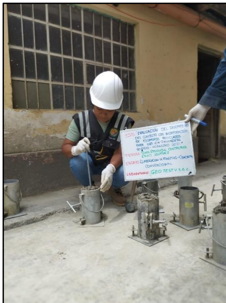
Fotografía 20: Elaboración de testigos cilíndricos convencional para sus respectivos tipos de ensayos, según referencia de la norma NTP 339.034 / ASTM 0C39.
