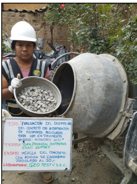
Fotografía 22: Vista de materiales tales como el agregado grueso para la elaboración del concreto con 30% de escombros reciclados, según referencia de la norma NTP 339.183.
