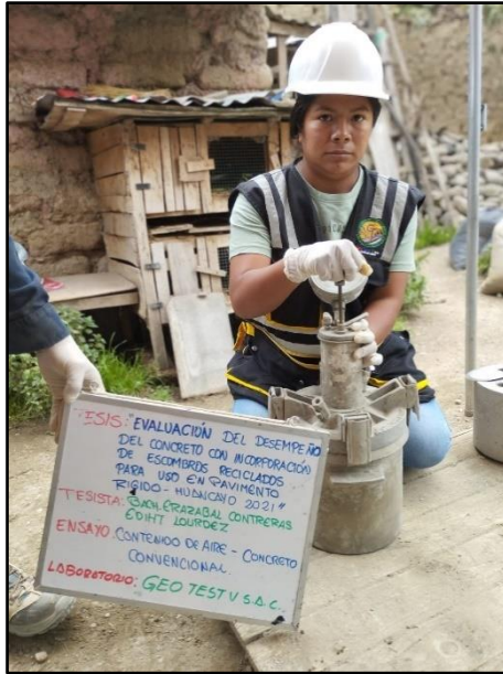
Fotografía 19: Control del contenido de aire del concreto fresco convencional por el método de presión. Según NTP 339.083.
