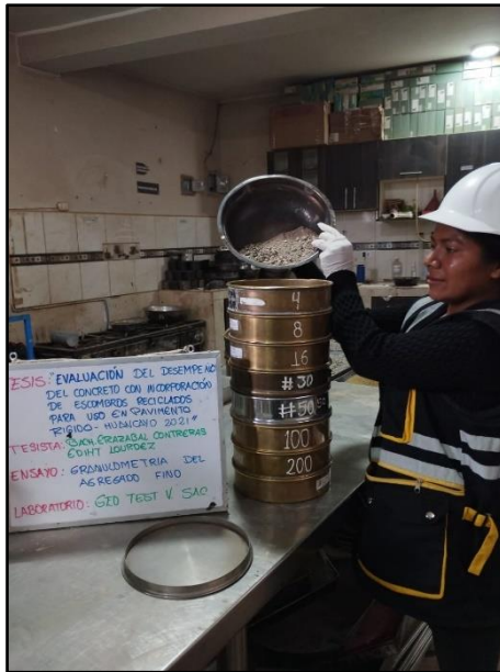
Fotografía 1: Ensayo de análisis granulométrico del agregado fino, según referencia de la norma NTP 400.012.
