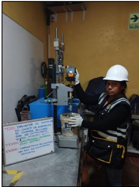
Fotografía 51: Control de penetración de diferentes diámetros de agujas para la verificación de tiempo para el fraguado con 70% de escombros reciclados, según referencia de la norma NTP 400.037.
