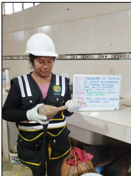
Fotografía 4: Fiola herramienta normalizado peso específico y absorción del agregado fino, según referencia de la norma NTP 400.022.
