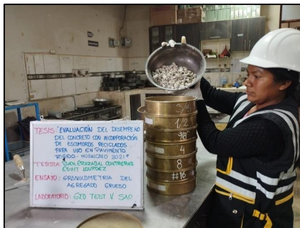
Fotografía 2: Ensayo de granulometría del agregado grueso, según referencia de la norma NTP 400.012.
