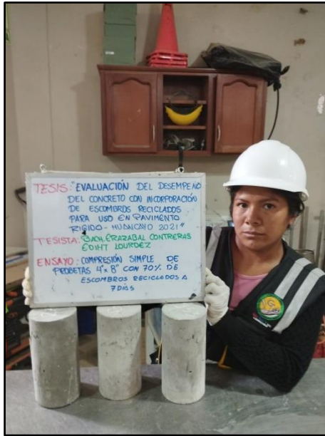
Fotografía 73: Testigos cilíndricos incorporados con 70% de escombros reciclados para la resistencia a la compresión de los 7 días de edad, según referencia de la norma NTP 339.034 / ASTM C39.
