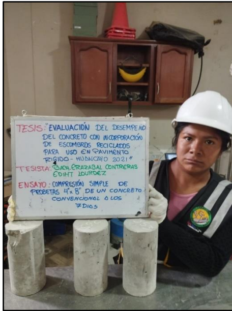
Fotografía 55: Testigos cilíndricos convencionales para la resistencia a la compresión de los 7 días de edad, según referencia de la norma NTP 339.034 / ASTM C39.
