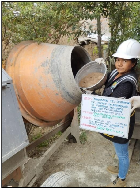
Fotografía 45: Vista de materiales tales como el agregado fino para la elaboración del concreto con adición del 70% de escombros reciclados, según referencia de la norma NTP 339.183.
