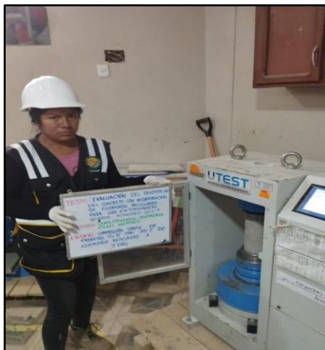
Fotografía 72: Testigos cilíndricos incorporados con 70% de escombros reciclados para la resistencia a la compresión de los 7 días de edad, según referencia de la norma NTP 339.034 / ASTM C39.
