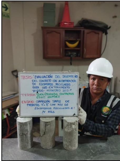
Fotografía 75: Testigos cilíndricos incorporados con 70% de escombros reciclados para la resistencia a la compresión de los 14 días de edad, según referencia de la norma NTP 339.034 / ASTM C39.
