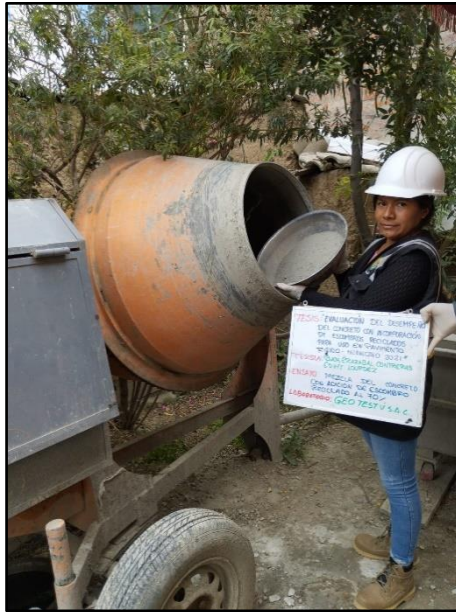
Fotografía 43: Vista de materiales tales como el cemento para la elaboración del concreto con adición del 70% de escombros reciclados, según referencia de la norma NTP 339.183.
