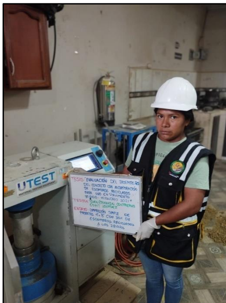
Fotografía 64: Testigos cilíndricos incorporados con 30% de escombros reciclados para la resistencia a la compresión de los 28 días de edad, según referencia de la norma NTP 339.034 / ASTM C39.
