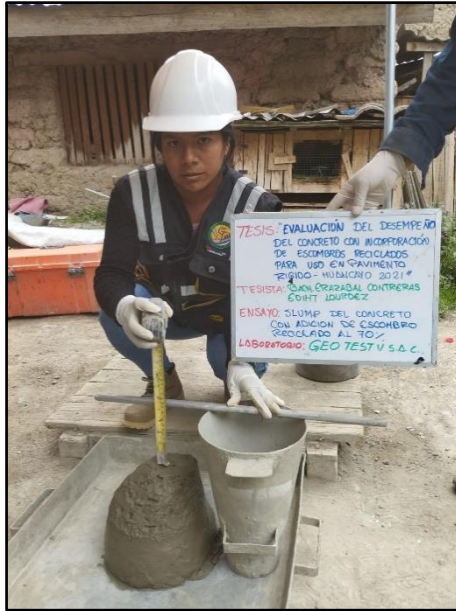
Fotografía 49: Medición del asentamiento del concreto fresco con adición del 70% de escombros reciclado. Según NTP 339.035.
