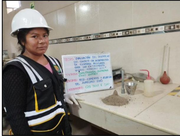
Fotografía 3: Ensayo con el molde cónico, metálico de 40\pm 3 mm de diámetro, y la varilla de apisonamiento de 340\pm 15 g, normalizado peso específico y absorción del agregado fino, según referencia de la norma NTP 400.022.
