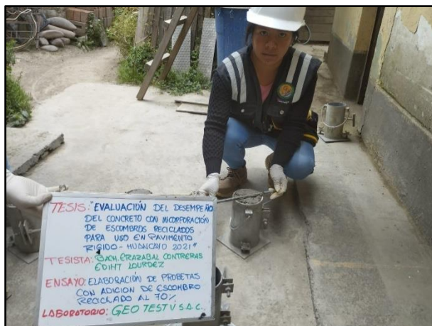
Fotografía 53: Elaboración de testigos cilíndricos con adición del 70% de escombros reciclados para sus respectivos tipos de ensayos, según referencia de la norma NTP 339.034 / ASTM C39.
