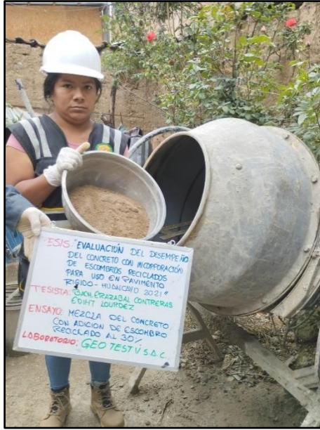
Fotografía 23: Vista de materiales tales como el agregado fino para la elaboración del concreto con 30% de escombros reciclados, según referencia de la norma NTP 339.183.
