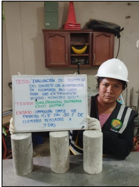
Fotografía 61: Testigos cilíndricos incorporados con 30% de escombros reciclados para la resistencia a la compresión de los 7 días de edad, según referencia de la norma NTP 339.034 / ASTM C39.
