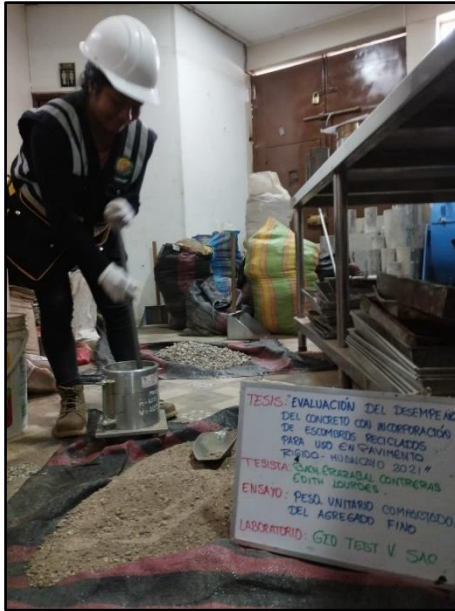
Fotografía 7: Determinación del Peso unitario compactado y el porcentaje de los vacíos del agregado fino, según referencia de la norma NTP 400.017.
