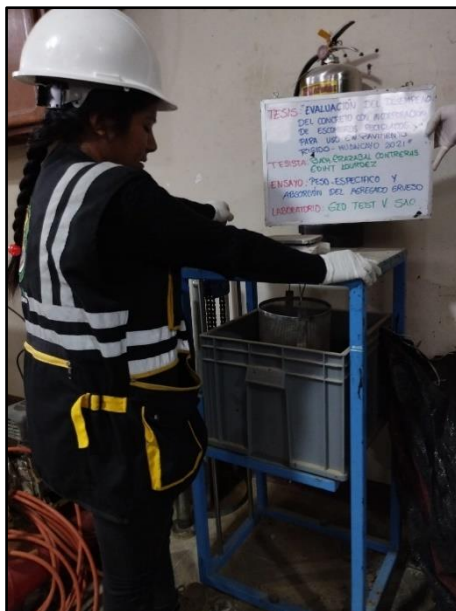
Fotografía 6: Peso del agregado sumergido en la canastilla normalizado, con la temperatura del agua de 23°C, según referencia de la norma NTP 400.022.
