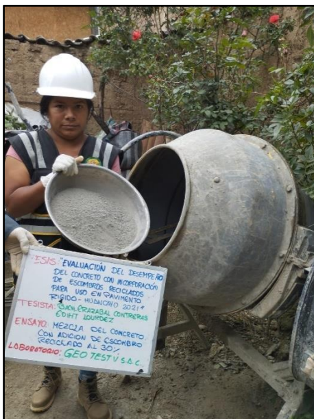
Fotografía 21: Vista de materiales tales como el cemento para la elaboración del concreto con 30% de escombros reciclados, según referencia de la norma NTP 339.183.
