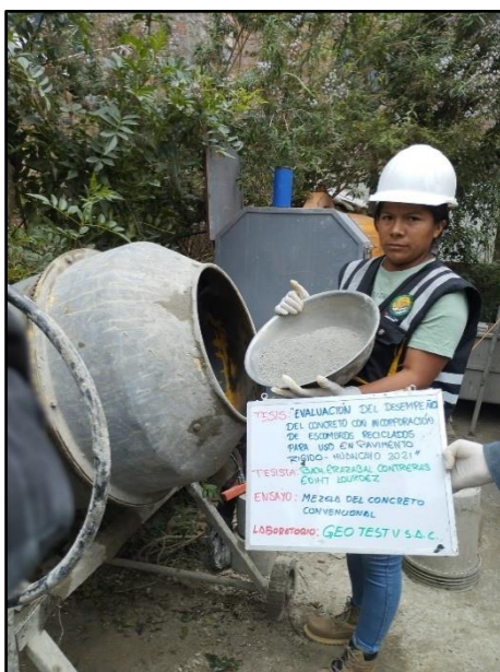
Fotografía 11: Vista de materiales tales como el cemento para la elaboración del concreto convencional, según referencia de la norma NTP 339.183.
