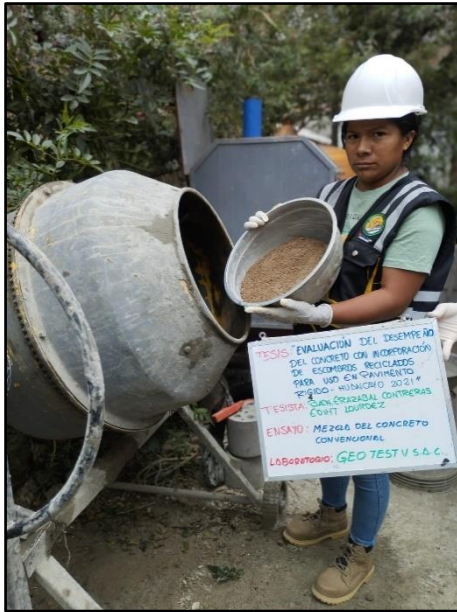
Fotografía 13: Vista de materiales tales como el agregado fino para la elaboración del concreto convencional, según referencia de la norma NTP 339.183.
