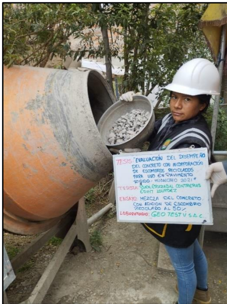
Fotografía 36: Vista de materiales tales como el escombros reciclado al 50% para la elaboración del concreto, según referencia de la norma NTP 339.183.
