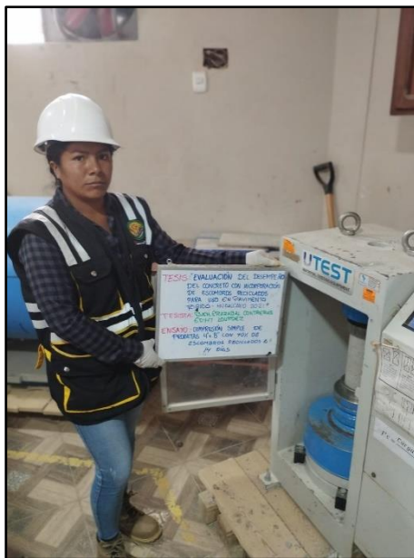
Fotografía 74: Testigos cilíndricos incorporados con 70% de escombros reciclados para la resistencia a la compresión de los 14 días de edad, según referencia de la norma NTP 339.034 / ASTM C39.
