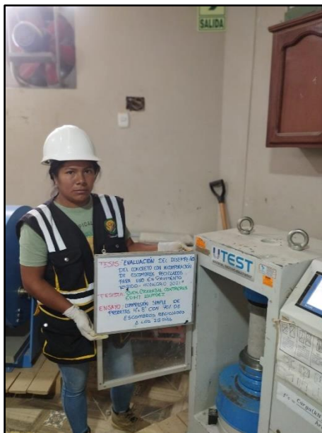
Fotografía 76: Testigos cilíndricos incorporados con 70% de escombros reciclados para la resistencia a la compresión de los 28 días de edad, según referencia de la norma NTP 339.034 / ASTM C39.
