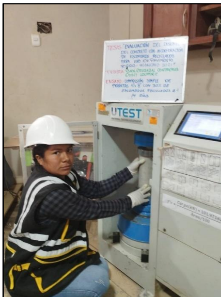
Fotografía 62: Testigos cilíndricos incorporados con 30% de escombros reciclados para la resistencia a la compresión de los 14 días de edad, según referencia de la norma NTP 339.034 / ASTM C39.
