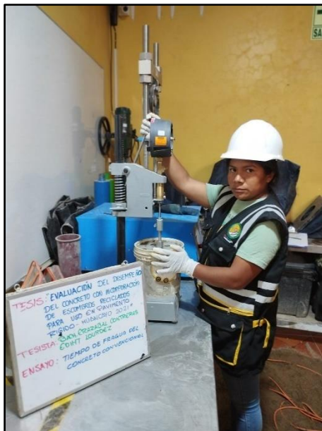
Fotografía 18: Control de penetración de diferentes diámetros de agujas para la verificación de tiempo para el fraguado convencional, según referencia de la norma NTP 400.037.
