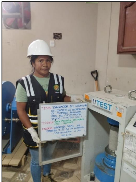
Fotografía 58: Testigos cilíndricos convencionales para la resistencia a la compresión de los 28 días de edad, según referencia de la norma NTP 339.034 / ASTM C39.
