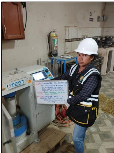
Fotografía 68: Testigos cilíndricos incorporados con 50% de escombros reciclados para la resistencia a la compresión de los 14 días de edad, según referencia de la norma NTP 339.034 / ASTM C39.
