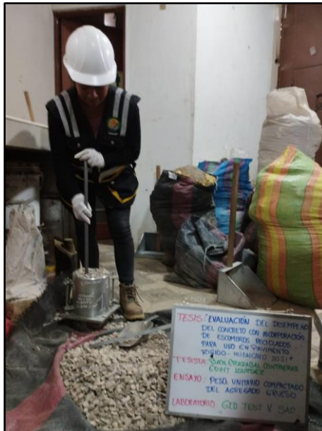
Fotografía 9: Determinación del Peso unitario compactado y el porcentaje de los vacíos del agregado grueso, según referencia de la norma NTP 400.017.
