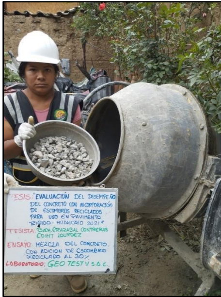
Fotografía 25: Vista de materiales tales como el escombro reciclado al 30% para la elaboración del concreto, según referencia de la norma NTP 339.183.
