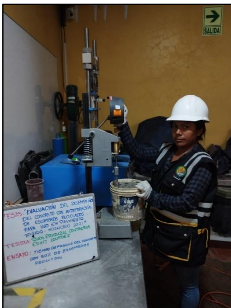
Fotografía 40: Control de penetración de diferentes diámetros de agujas para la verificación de tiempo para el fraguado con 50% de escombros reciclados, según referencia de la norma NTP 400.037.
