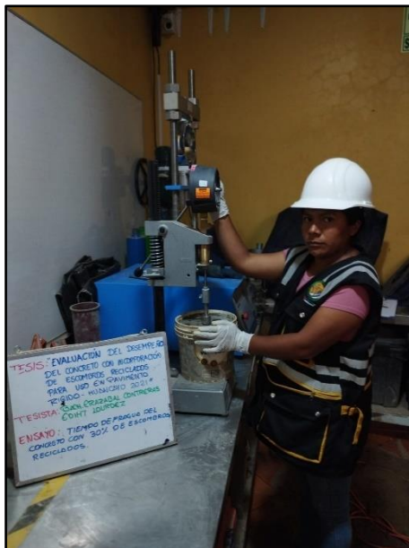
Fotografía 30: Control de penetración de diferentes diámetros de agujas para la verificación de tiempo para el fraguado con 30% de escombro reciclado, según referencia de la norma NTP 400.037.
