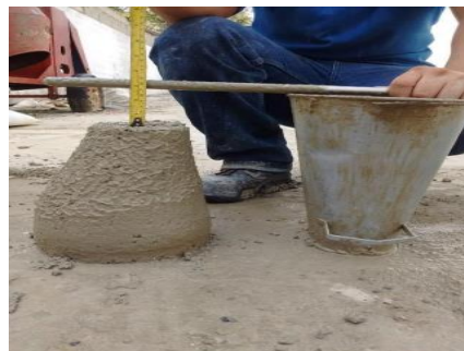
Figura 27. Asentamiento del concreto
