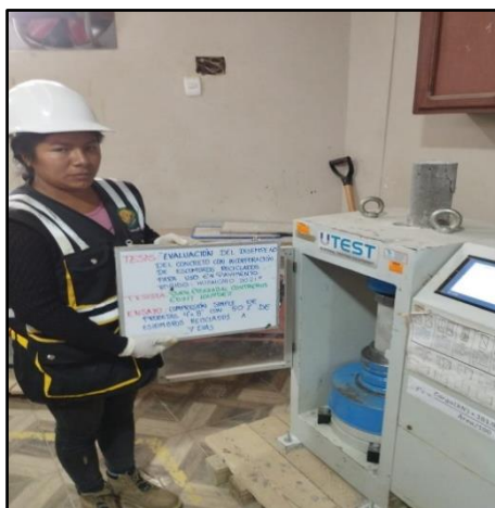
Fotografía 66: Testigos cilíndricos incorporados con 50% de escombros reciclados para la resistencia a la compresión de los 7 días de edad, según referencia de la norma NTP 339.034 / ASTM C39.
