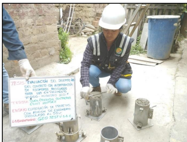
Fotografía 42: Elaboración de testigos cilíndricos con 50% de escombro reciclado para sus respectivos tipos de ensayos, según referencia de la norma NTP 339.034 / ASTM C39.
