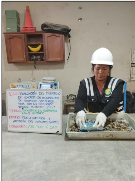
Fotografía 5: Realización del ensayo para determinar el Método de ensayo normalizado para peso específico y absorción del agregado grueso, según referencia de la norma NTP 400.022.
