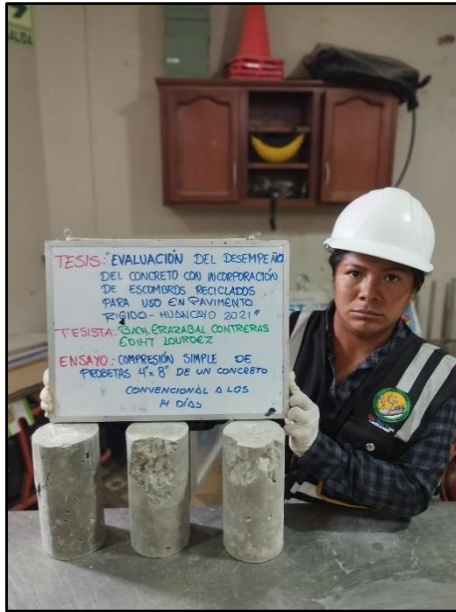
Fotografía 57: Testigos cilíndricos convencionales para la resistencia a la compresión de los 14 días de edad, según referencia de la Norma NTP 339.034 / ASTM C39.
