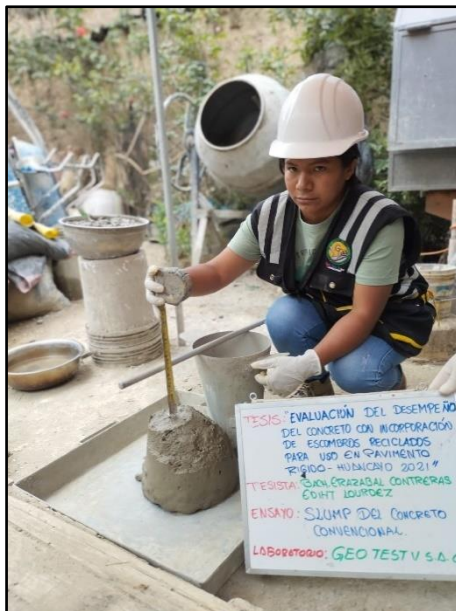
Fotografía 16: Medición del asentamiento del concreto convencional. Según NTP 339.035.
