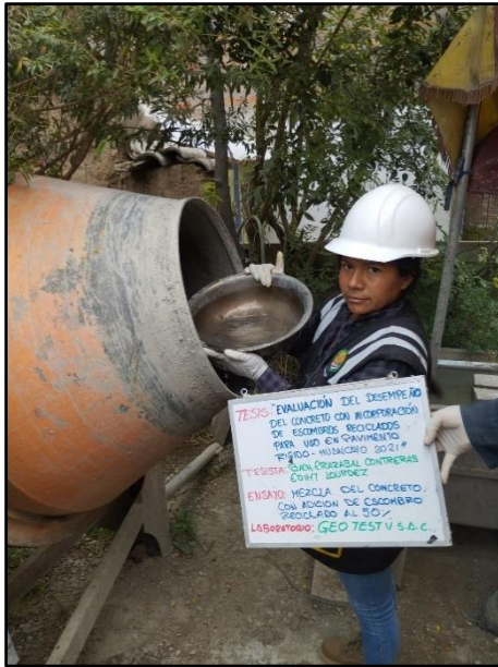
Fotografía 35: Vista de materiales tales como el agua para la elaboración del concreto con 50% de escombros reciclado, según referencia de la norma NTP 339.183.
