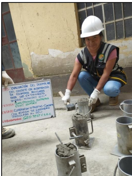
Fotografía 31: Elaboración de testigos cilíndricos con 30% de escombros reciclados para sus respectivos tipos de ensayos, según referencia de la norma NTP 339.034 / ASTM C39.
