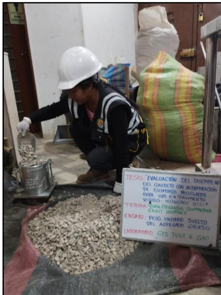
Fotografía 10: Determinación del Peso unitario suelto y el porcentaje de los vacíos del agregado grueso, según referencia de la norma NTP 400.017.
