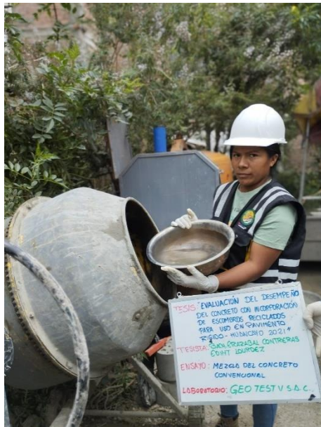
Fotografía 14: Vista de materiales tales como el agua para la elaboración del concreto convencional, según referencia de la norma NTP 339.183.
