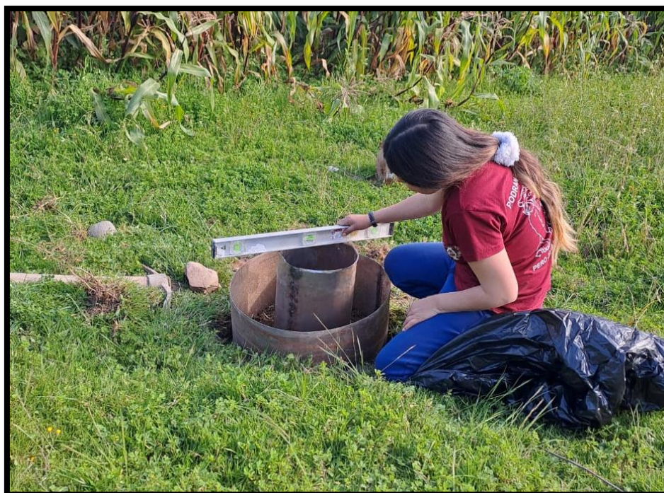
Fotografía 4. : Iniciando el método del cilindro para la medición de infiltración
