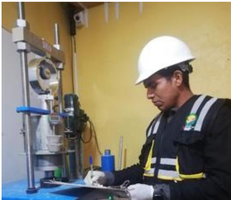
Fotografía N° 4: se observa la prueba de la prensa de CBR
