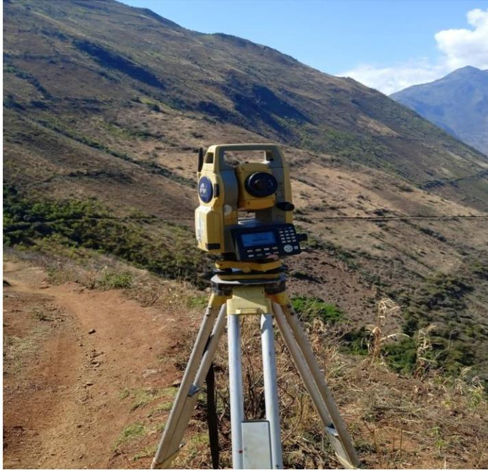
Fotografía N°5: se observa el equipo topográfico utilizado para realizar el levantamiento topográfico
