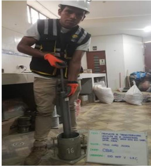
Fotografía N° 3: se observa el trabajo realizando el CRB
