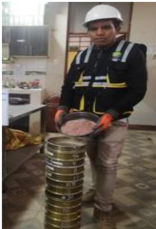
Fotografía N° 2: se observa el tamizado de tierra de las calicatas extraídas
