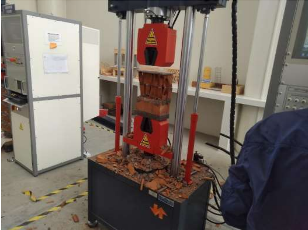
Fotografía 39. Otro prisma después del ensayo de resistencia a la compresión axial.
