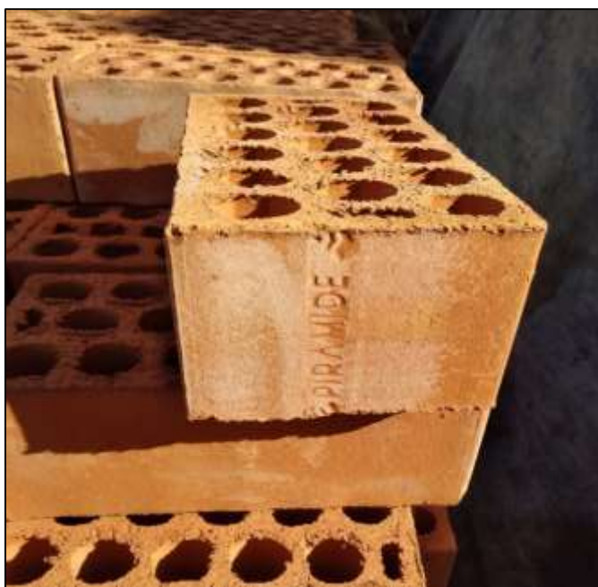
Figura 2.4. Ladrillo industrial King Kong de 18 huecos de la marca “Pirámide”.
