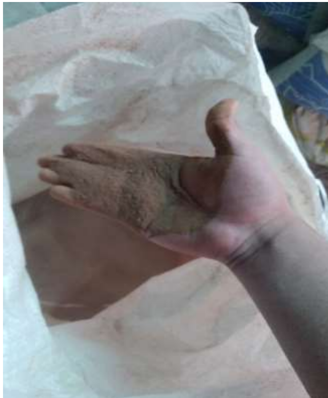
Fotografía 6. Se comprueba que el cerámico se redujo a un polvo fino.
