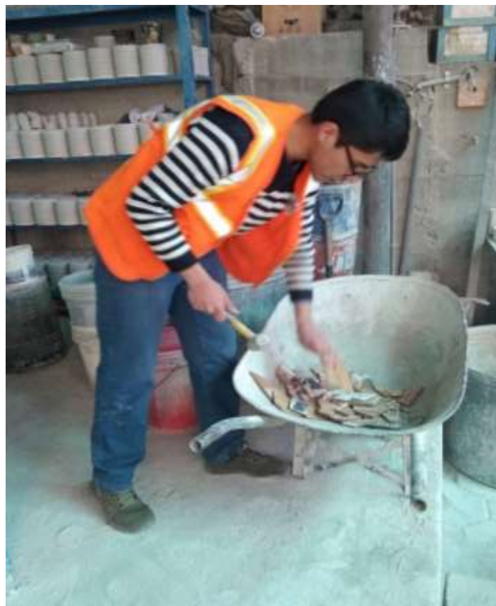
Fotografía 2. Triturado manual del cerámico.
