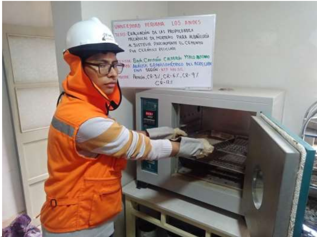
Fotografía 11. Secado de muestra de arena gruesa.
