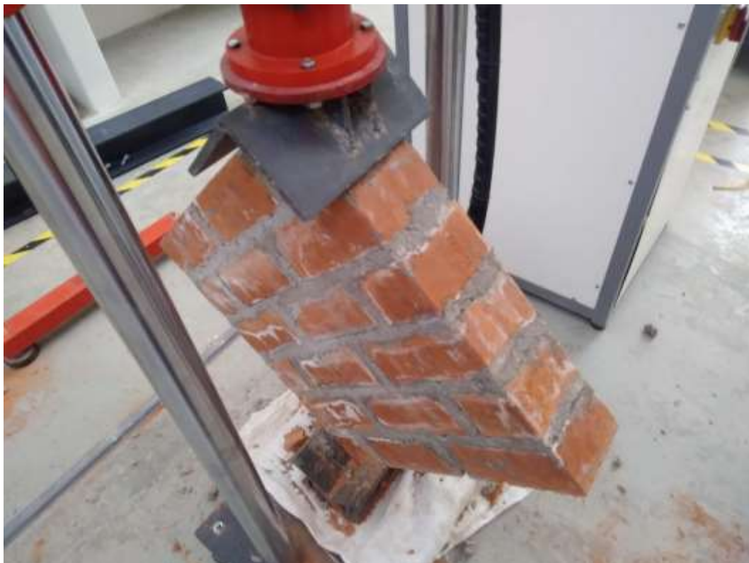
Fotografía 42. Ensayo de resistencia a la compresión diagonal de murete de albañilería.
