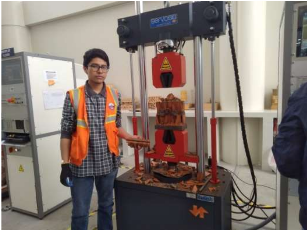
Fotografía 37. Prisma fracturado luego de ensayo de resistencia a la compresión.
