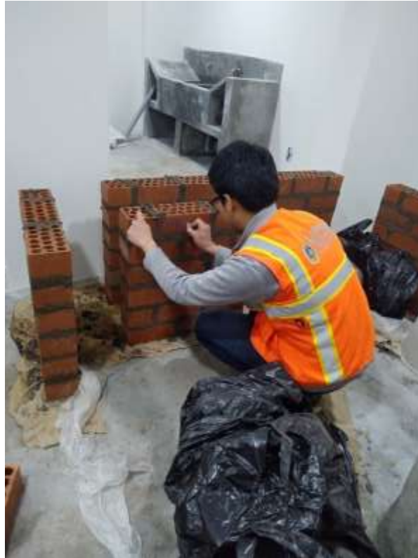
Fotografía 27. Marcado y comprobación del proceso de curado de los muretes.
