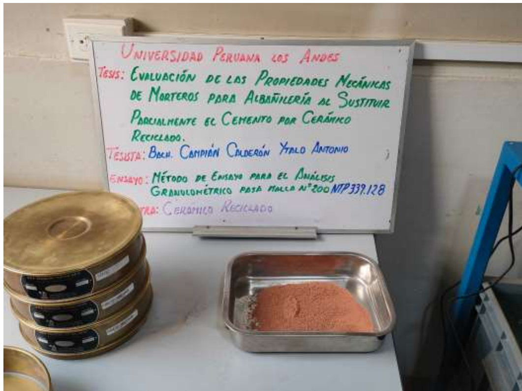
Fotografía 16. Ensayo de caracterización granulométrica para la separación del cerámico reciclado.
