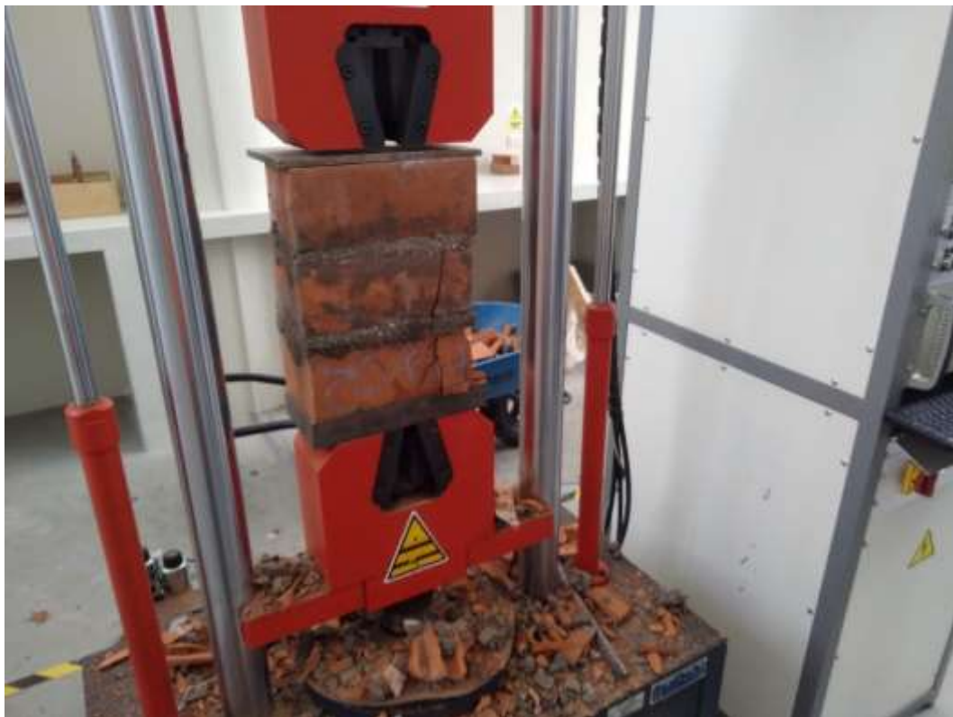
Fotografía 38. Ensayo de resistencia a la compresión de prisma de albañilería.
