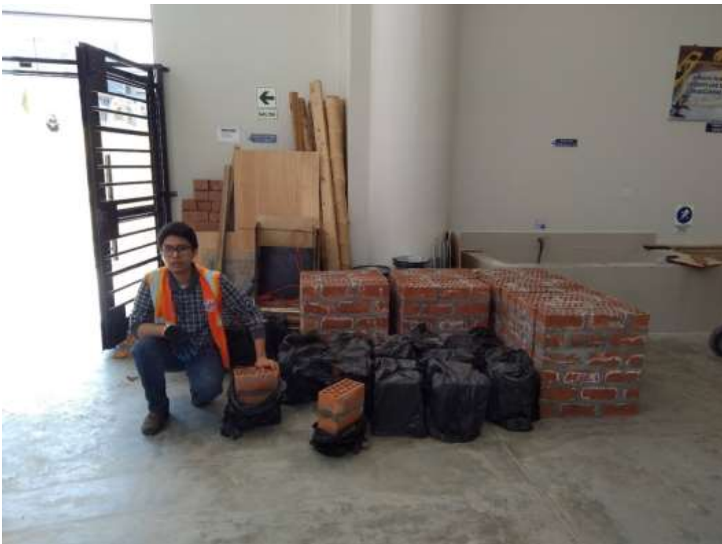
Fotografía 33. Prismas y muretes en el laboratorio de estructuras de la Facultad de Ingeniería de la UPLA.
