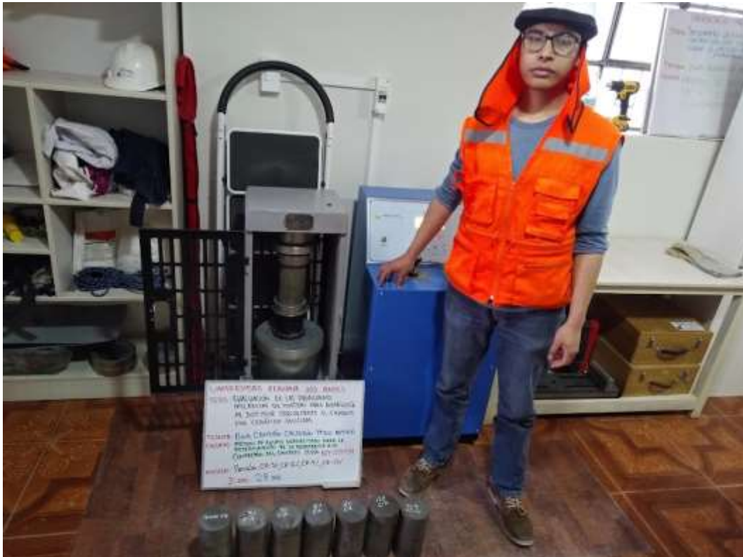
Fotografía 35. Testigo de mortero listos para el ensayo de resistencia a la compresión.
