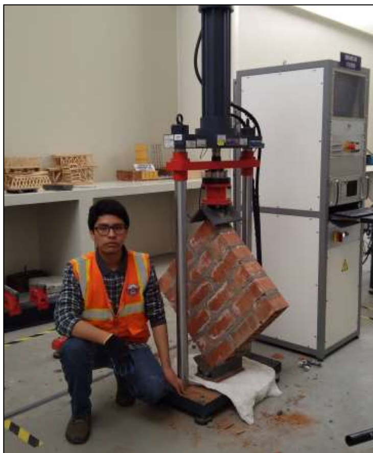
Figura 2.8. Ensayo de resistencia a la compresión diagonal de murete de albañilería.
