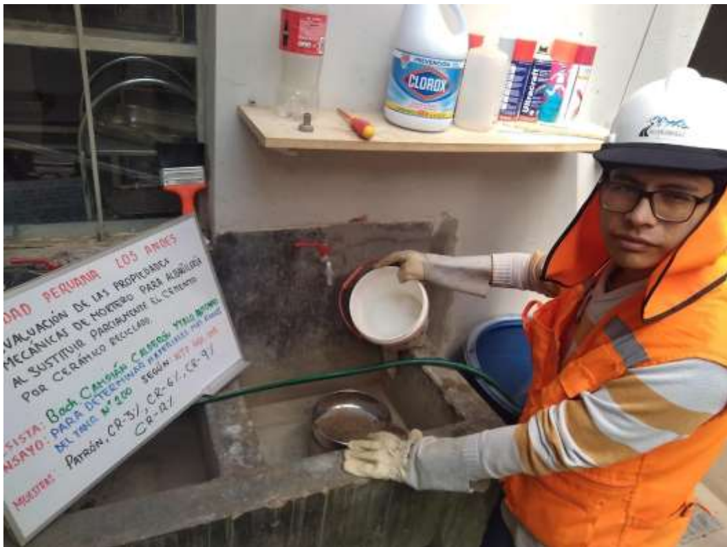
Fotografía 10. Lavado de la arena gruesa.
