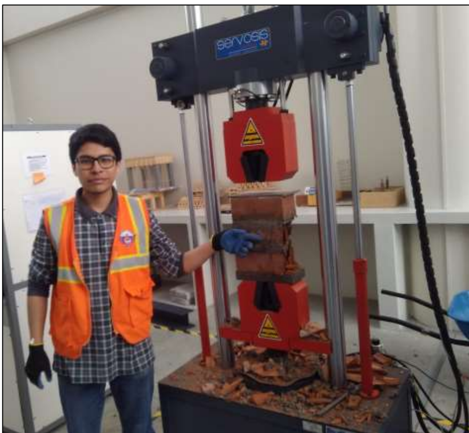
Figura 2.7. Ensayo de resistencia a la compresión axial de prisma de albañilería.
