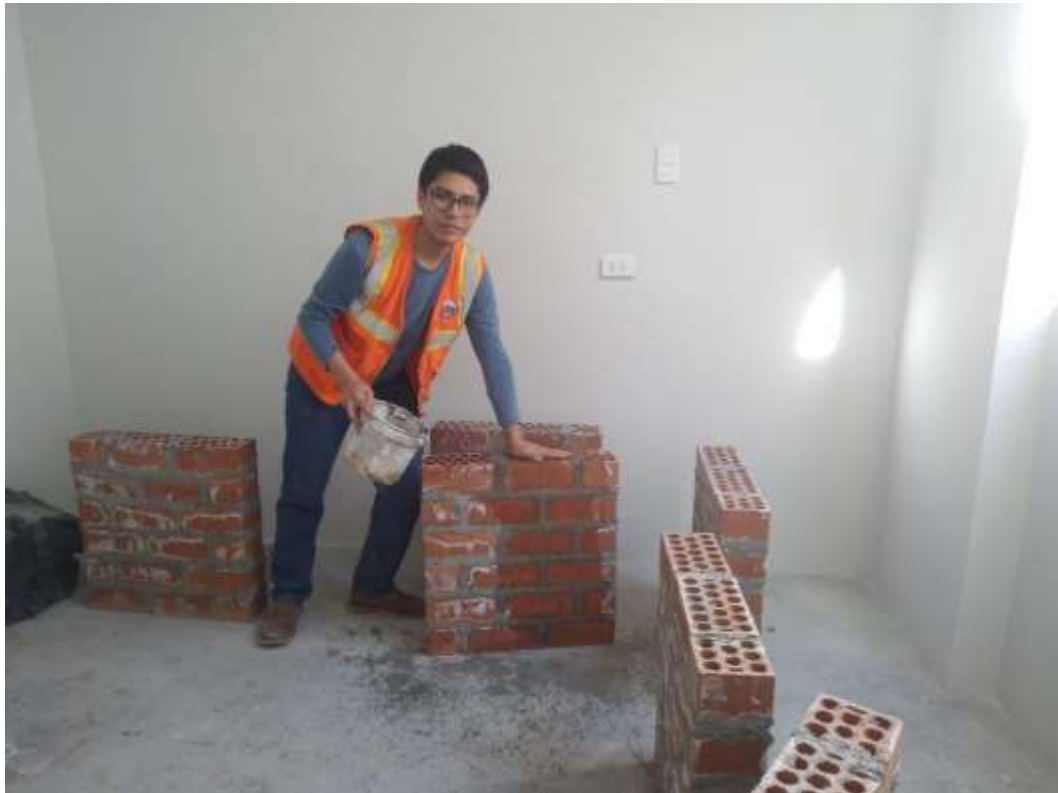
Fotografía 31. Proceso de curado de los muretes.
