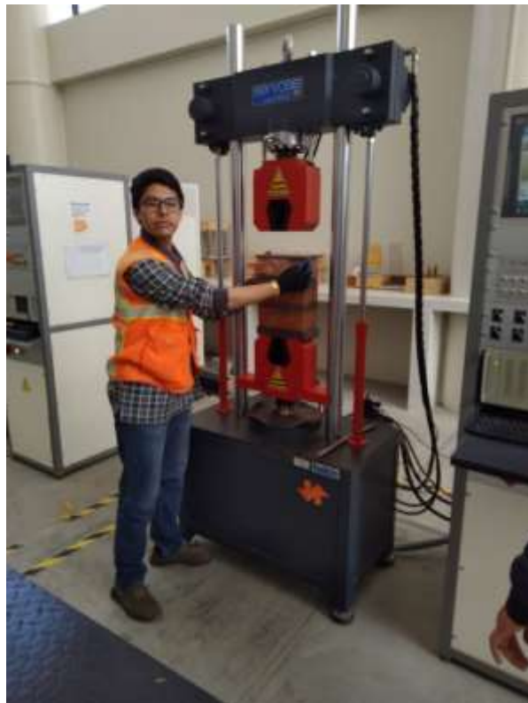
Fotografía 40. Colocación de prisma en el equipo de compresión.
