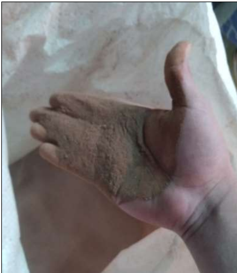
Figura 2.2. Polvo cerámico pasante del tamiz de la malla N° 200.
