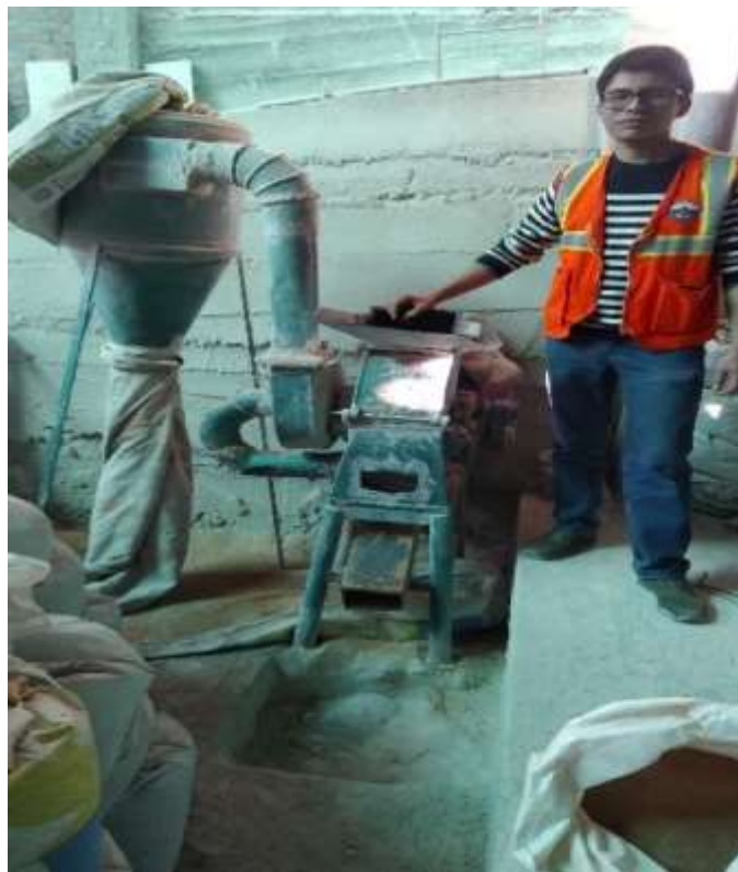
Fotografía 4. Equipo de triturado de materiales cerámicos y refractarios.
