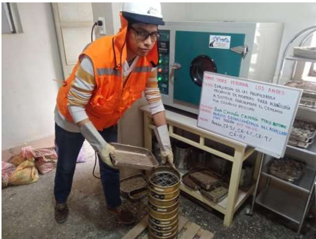
Fotografía 12. Colocación del material en los tamices para caracterización granulométrica.
