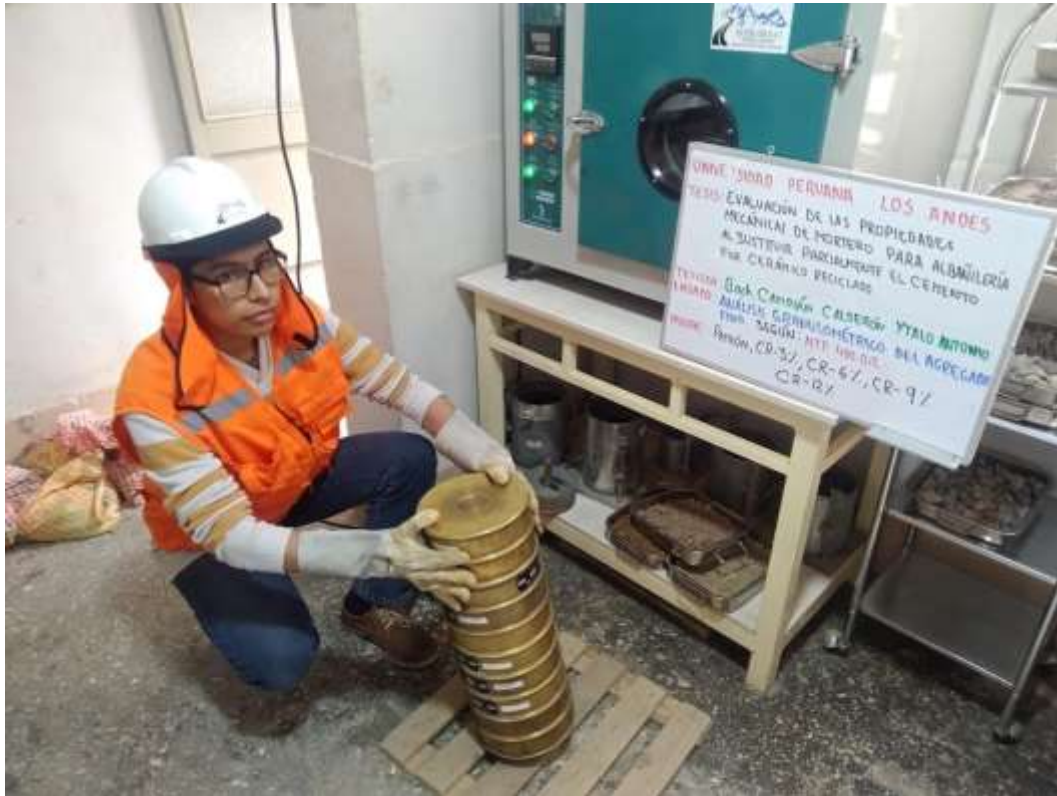
Fotografía 13. Ensayo de caracterización granulométrica del agregado fino.
