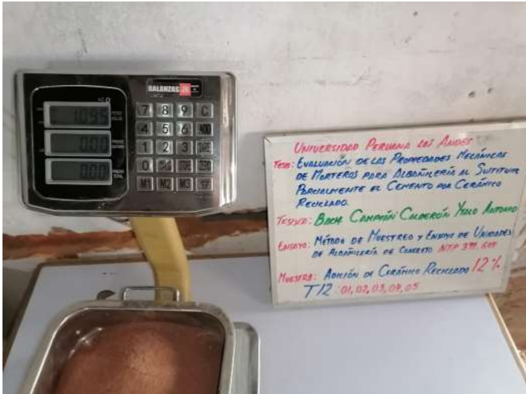
Fotografía 17. Dosificación del cerámico reciclado para la elaboración del mortero.
