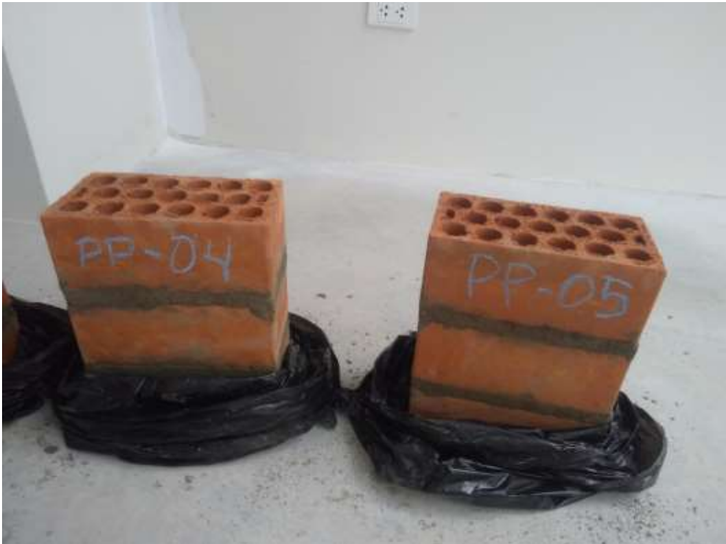
Fotografía 25. Dos prismas de albañilería del grupo patrón.
