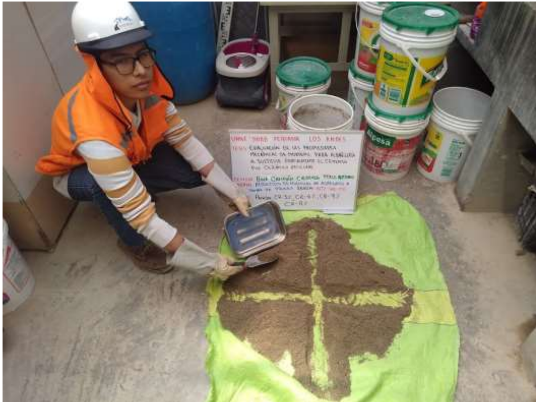
Fotografía 9. Cuarteo de muestra de arena gruesa
