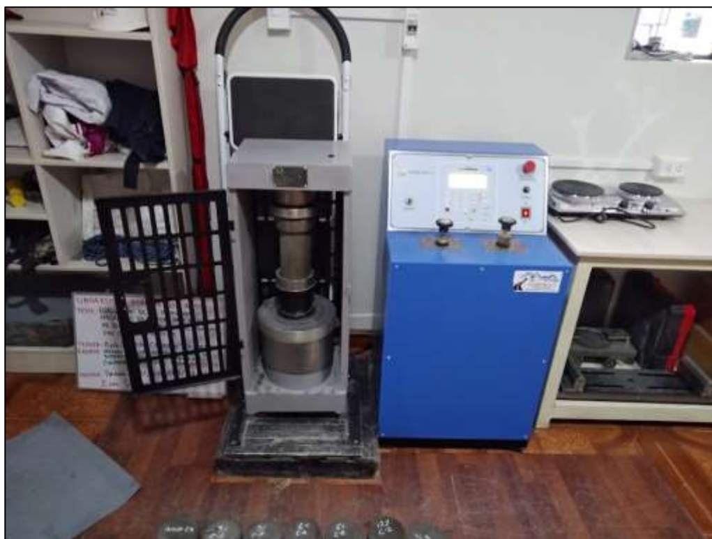
Figura 2.6. Ensayo de resistencia a la compresión axial de mortero de albañilería.
