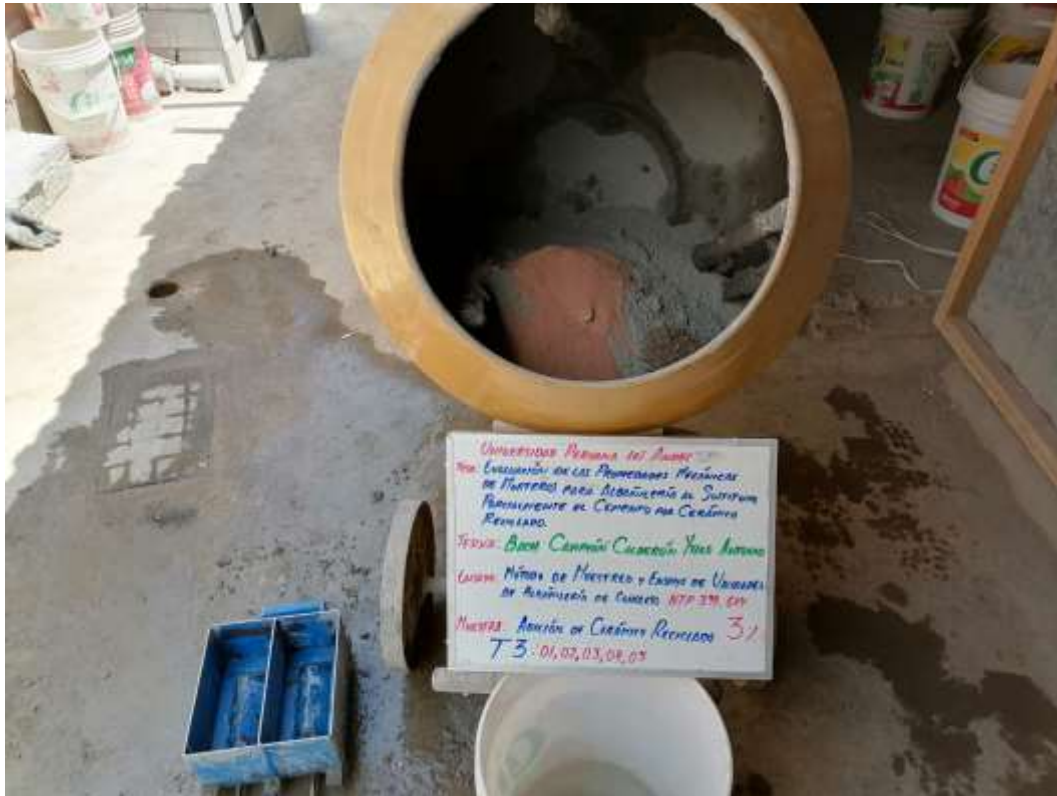
Fotografía 19. Mezclado del mortero con 3 % de sustitución del cemento por cerámico reciclado.
