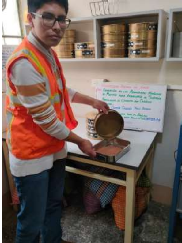
Fotografía 15. Ensayo de caracterización granulométrica del cerámico reciclado.
