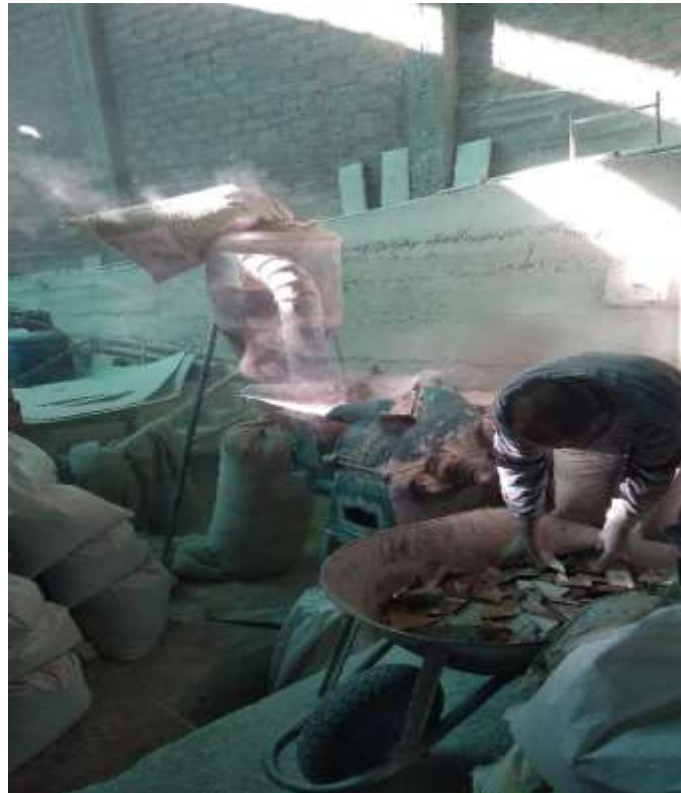
Fotografía 3. Triturado del cerámico hasta la obtención del polvo pasante de la malla N° 200.
