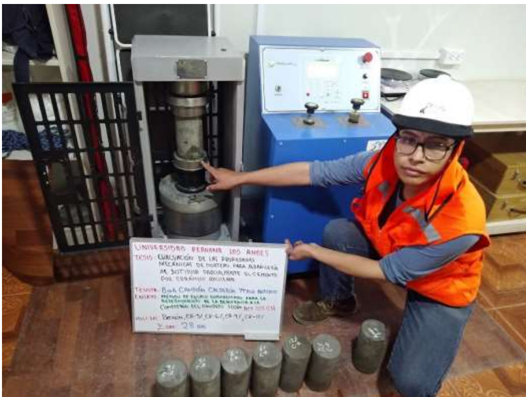
Fotografía 34. Testigo de mortero después de ensayo de resistencia a la compresión.
