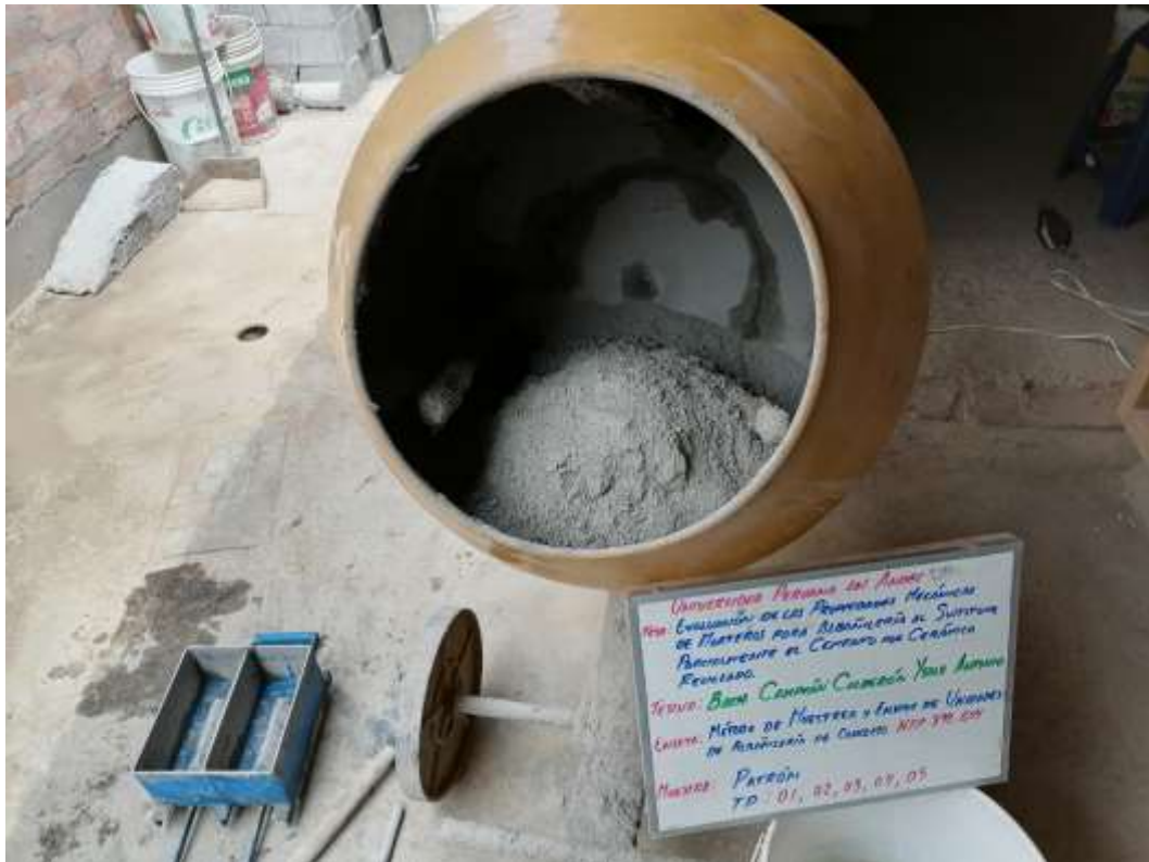
Fotografía 18. Mezclado del mortero patrón.
