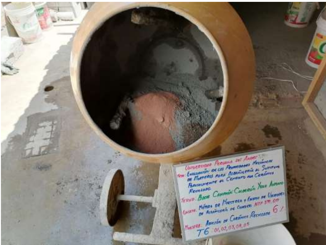
Fotografía 20. Mezclado del mortero con 6 % de sustitución del cemento por cerámico reciclado.
