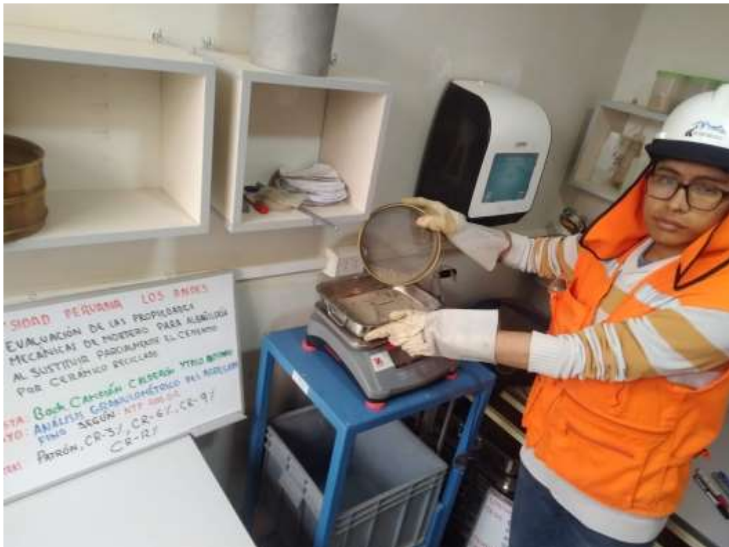
Fotografía 14. Medida del peso del material retenido en cada tamiz.
