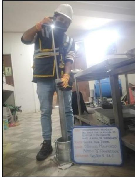
**Fotografía N° 7:** Apisonamiento del material convencional con 56 golpes por capa; MTC E 115.
