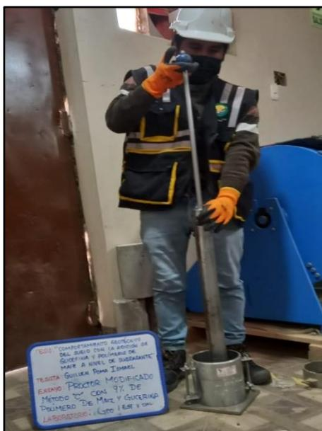
**Fotografía N° 30:** Apisonamiento de suelo con 6% de polímero de maíz y glicerina dentro del molde en 5 capas, en un molde con 56 golpes, MTC E 115.
