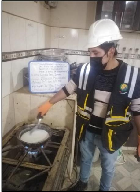
**Fotografía N° 8:** Preparación de la mezcla en un 3% a base de polímero de maíz y glicerina para la investigación correspondiente, MTC E 115.
