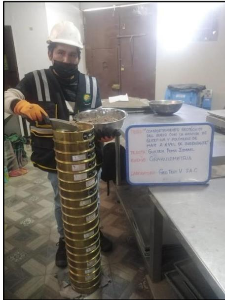
**Fotografía N° 1:** Prueba granulométrica del suelo
