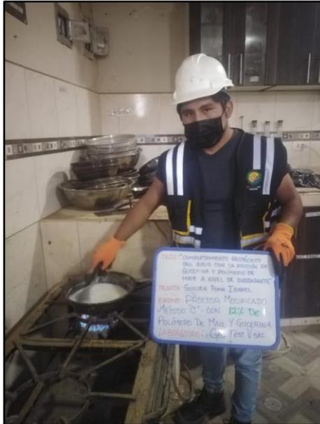
**Fotografía N° 31:** Preparación de la mezcla en un 9% a base de polímero de maíz y glicerina para la investigación correspondiente, MTC E 115.
