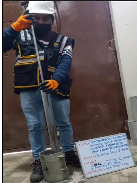
**Fotografía N° 37:** Compactación de material en el molde en 5 capas, con 56 golpes, en el segundo molde por 25 golpes y en el tercer molde 12 golpes con adición del 9% de polímero de maíz y glicerina, MTC E 132.
