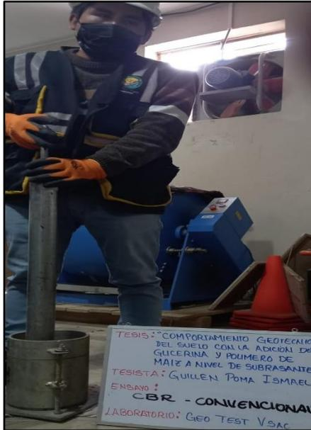
**Fotografía N° 18:** Apisonamiento de suelo en 5 capas, en molde con 56 golpes, en el segundo molde de 25 golpes y en el tercer molde con 12 golpes, MTC E 132.
