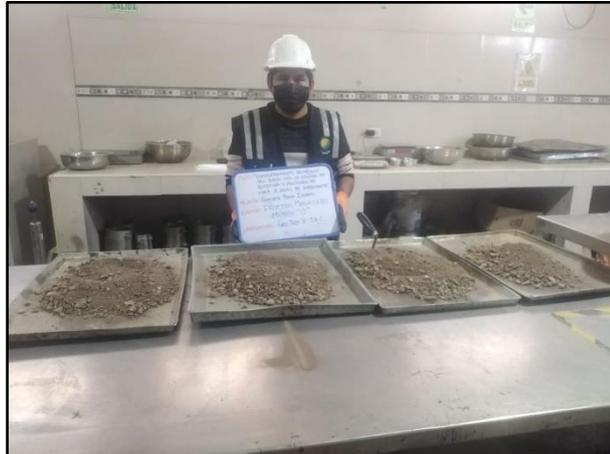
**Fotografía N° 6:** Preparación del material para el ensayo MTC E 115.
