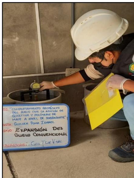
**Fotografía N° 40:** Prueba de expansión del suelo a las 96 hr y 24hr de suelo natural, SN+6%, SN+9% y SN+12% de polímero de maíz y glicerina, MTC E 132.
