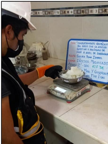
**Fotografía N° 32:** Medida de la preparación en una cantidad referente a la masa del material para el uso del 9% del polímero de maíz y glicerina; MTC E 115.
