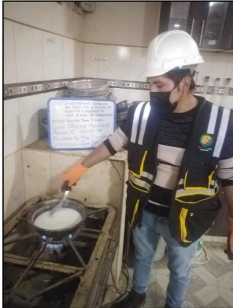
**Fotografía N° 25:** Preparación de la mezcla en un 3% a base de polímero de maíz y glicerina para la investigación correspondiente, MTC E 115.
