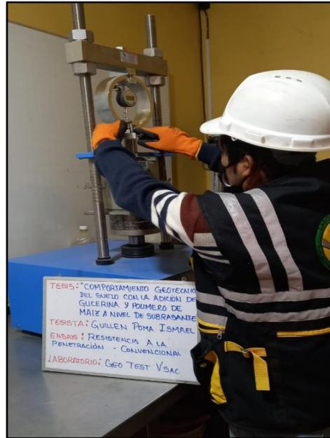
**Fotografía N° 24:** Prueba para la determinación de un índice de resistencia del suelo, Lectura de penetración en el dial, 0.025 plg a 0.500 plg natural, SN+3%, SN+6% y SN+9% polímero de maíz y glicerina.
