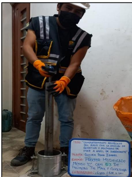
**Fotografía N° 33:** Apisonamiento del suelo con 9% de polímero de maíz y glicerina en 5 capas, en un molde con 56 golpes, MTC E 115.
