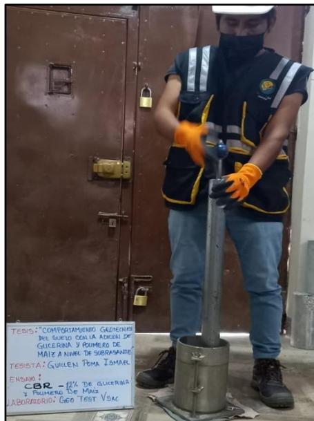
**Fotografía N° 38:** Compactación de material en el molde en 5 capas, con 56 golpes, en el segundo molde por 25 golpes y en el tercer molde 12 golpes con adición del 12% de polímero de maíz y glicerina, MTC E 132.
