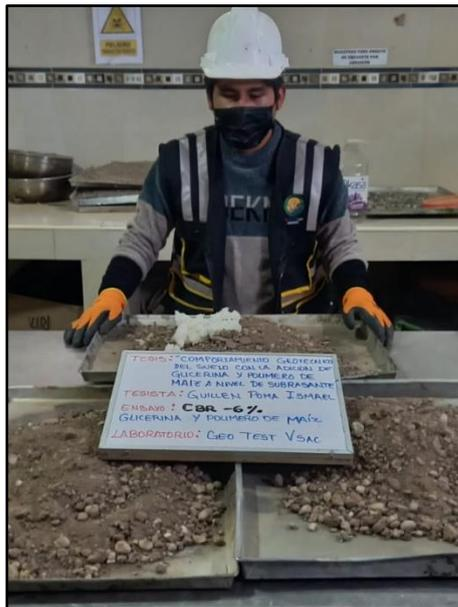
**Fotografía N° 19:** Compactación de material en el molde en 5 capas, con 56 golpes, en el segundo molde por 25 golpes y en el tercer molde 12 golpes con adición del 6% de polímero de maíz y glicerina, MTC E 132.
