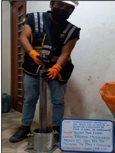
**Fotografía N° 16:** Apisonamiento del suelo con 9% de polímero de maíz y glicerina en 5 capas, en un molde con 56 golpes, MTC E 115.
