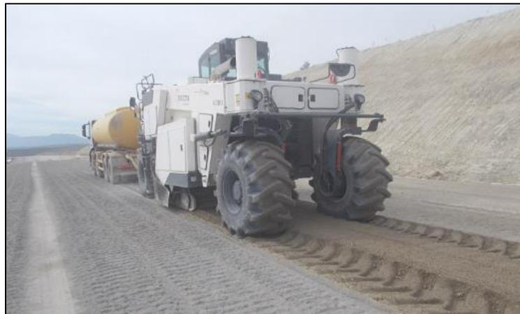
**Figura N° 9:** Estabilización de suelos con cemento
