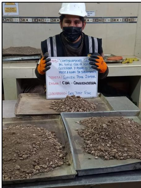
**Fotografía N° 17:** Preparación de los materiales para CBR en 5 capas y 56 golpes, en el segundo molde por 25 golpes y en el tercer molde 12 golpes, MTC E 132.
