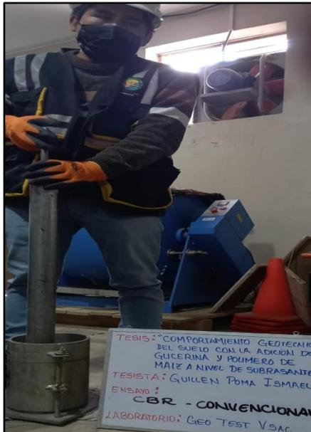
**Fotografía N° 35:** Apisonamiento de suelo en 5 capas, en molde con 56 golpes, en el segundo molde de 25 golpes y en el tercer molde con 12 golpes, MTC E 132.
