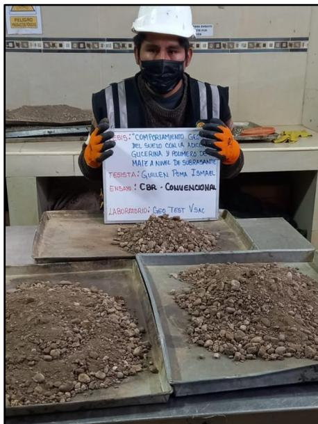
**Fotografía N° 34:** Preparación de los materiales para CBR en 5 capas y 56 golpes, en el segundo molde por 25 golpes y en el tercer molde 12 golpes, MTC E 132.
