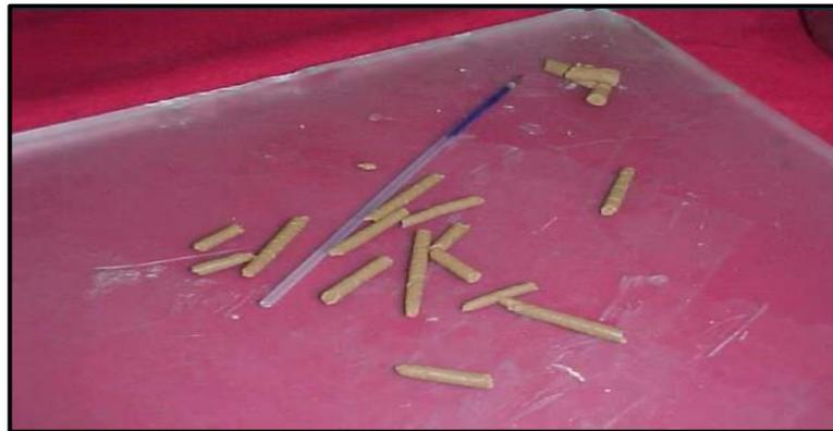
**Figura N° 26:** Muestra obtenida del límite plástico
