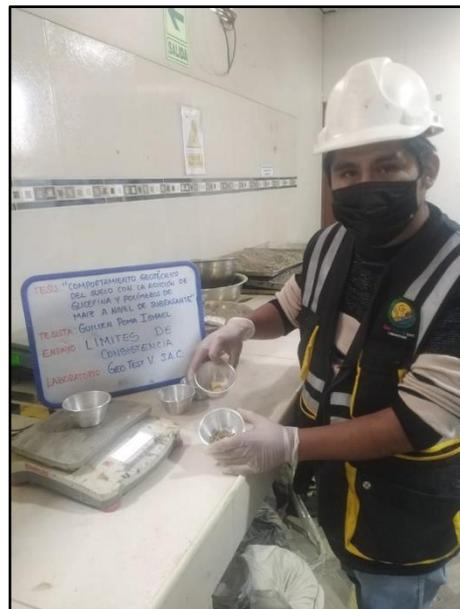
**Fotografía N° 4:** Prueba de LP sin el uso de aditivos.
