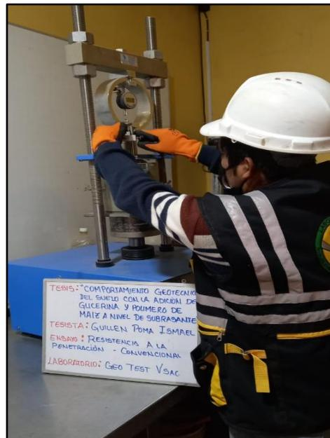
**Fotografía N° 41:** Prueba para la determinación de un índice de resistencia del suelo, Lectura de penetración en el dial, 0.025 plg a 0.500 plg natural, SN+3%, SN+6% y SN+9% polímero de maíz y glicerina.
