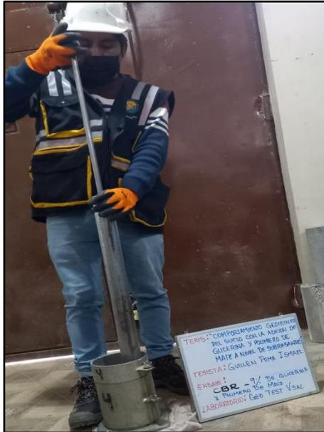
**Fotografía N° 20:** Compactación de material en el molde en 5 capas, con 56 golpes, en el segundo molde por 25 golpes y en el tercer molde 12 golpes con adición del 9% de polímero de maíz y glicerina, MTC E 132.
