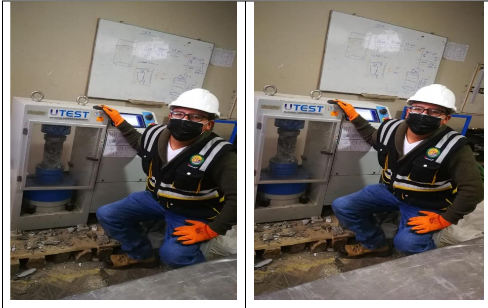
Fotografía N° 7: Ensayo de resistencia a la compresión de concreto convencional y con 1%, 2% y 3% de escoria. NTP 339.034
