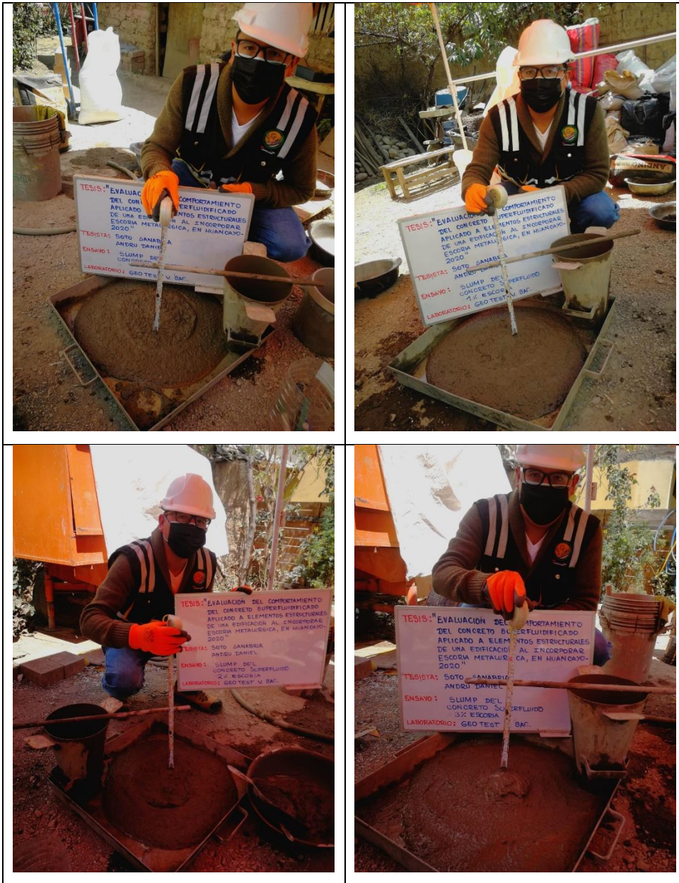
Fotografía N° 2: Ensayo de asentamiento del concreto convencional y con 1%, 2% y 3% de escoria.
