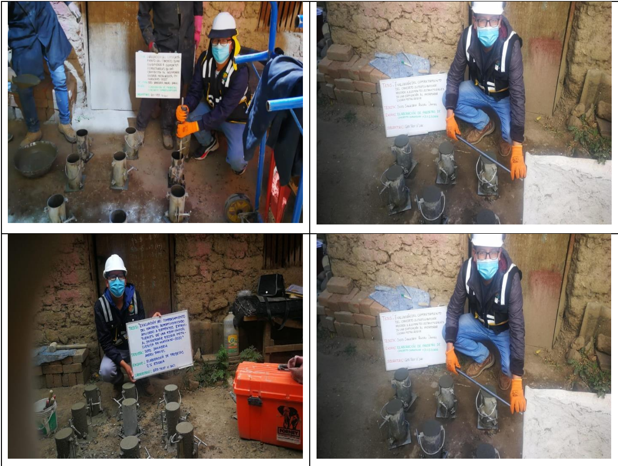
Fotografía N° 1: Elaboración de muestras cilíndricas de concreto convencional y con 1%, 2% y 3% de escoria.
