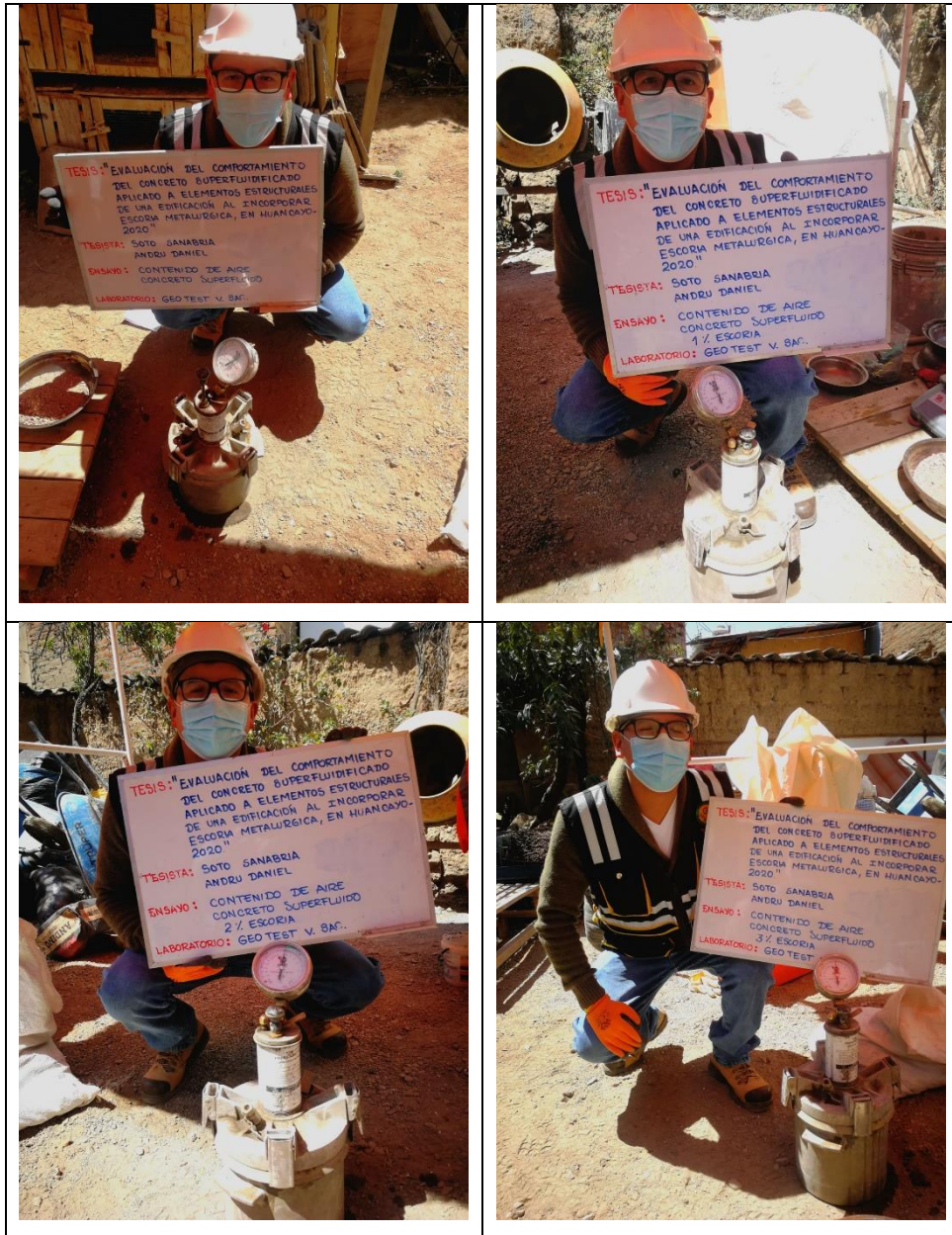
Fotografía N° 3: Ensayo de contenido de aire del concreto convencional y con 1%, 2% y 3% de escoria. NTP 339.083
