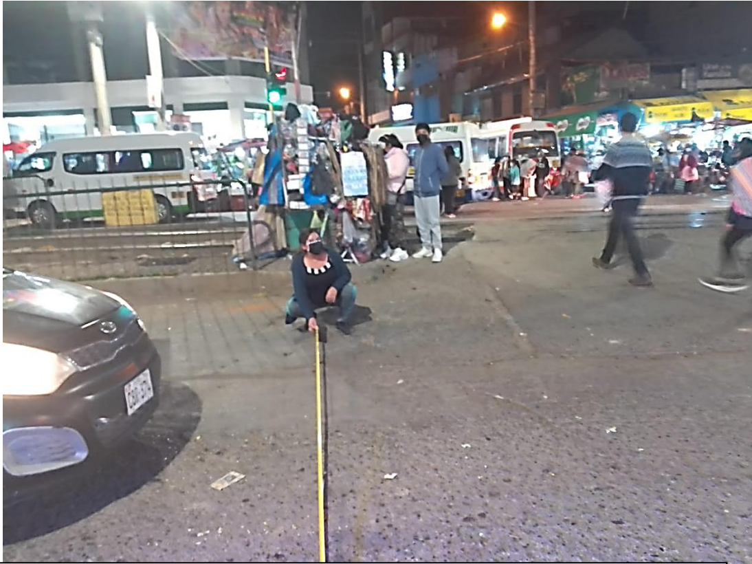
FOTOGRAFIA 1: Tomando medida de la sección transversal de la intersección Av.Ferrocarril y Jr. Cajamarca, dirección N-S.
