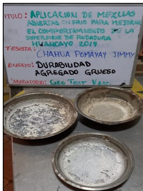
Fotografía N° 14: Secado e inmersión, teniendo en cuenta la temperatura del horno a 105°C o 110°C mediante el ensayo de Durabilidad al sulfato de magnesio, según referencia de la norma (ASTM C 88M-18).
