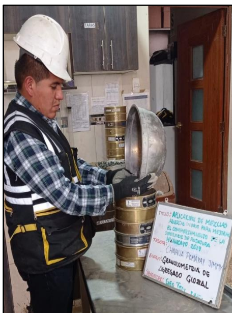
Fotografía N°5: Granulometría del agregado global conformado por la combinación teórica de agregados finos y agregado grueso el diseño de mezcla asfáltica abierta en frío, según referencia de la norma (ASTM C 136).
