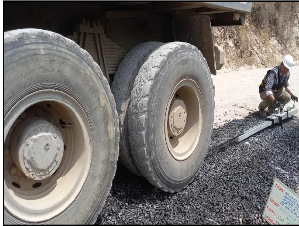
Fotografía N° 37: Determinación de deflexiones de capa de rodadura de mezcla asfáltica abierta en frío con equipo viga Benkelman, según referencia de la norma (ASTM D 4695).
