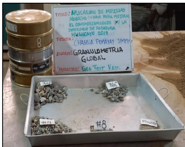
Fotografía N° 6: Tamaño encontrados de partículas en granulometría física de la combinación teórica de agregados del diseño MAF-2 (mezcla asfáltica en frío), según referencia de la norma (ASTM C 136).
