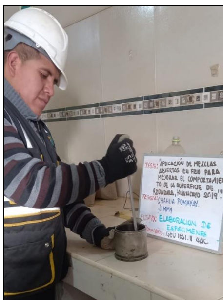
Fotografía N° 18: Elaboración de probetas con porcentaje de emulsión asfáltica tipo CMS-2H, para mezcla abierta fría, según referencia del The Asphalt Institute; Manual Series N.º 14 (MS 14), U.S.A.
