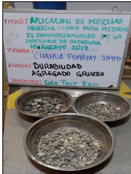
Fotografía N° 13: Determinar el porcentaje de pérdida del agregado grueso a la desintegración por medio de soluciones mediante el ensayo de Durabilidad al sulfato de magnesio, según referencia de la norma (ASTM C 88M-18).
