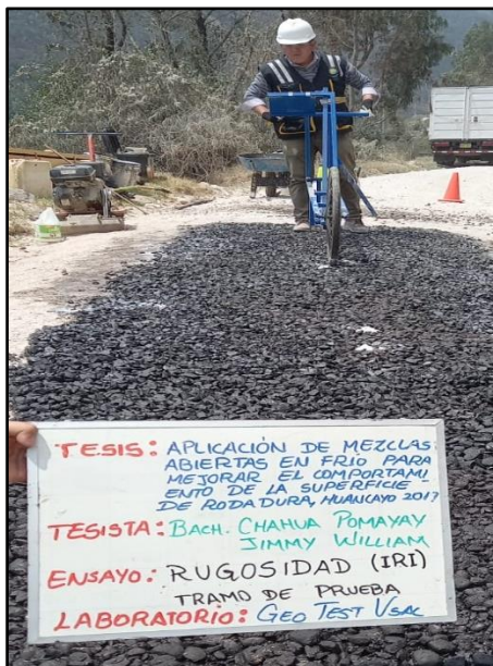
Fotografía N° 34: Recolección de datos en una vuelta de rugosidad de capa de rodadura con equipo merlín, según la referencia de la norma (ASTM E 1926).
