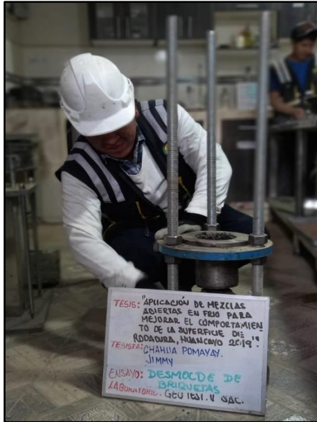
Fotografía N° 19: Desmolde de probetas luego de ser curadas, mezcla asfáltica abierta en fría, según referencia del The Asphalt Institute; Manual Series N.º 14 (MS 14), U.S.A.
