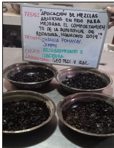
Fotografía N° 16: Elaboración de material con adición de emulsión asfáltica para ensayo de cobertura con porcentaje de agua: 0.0%;0.5%,1.0% y 2.0%, según referencia del The Asphalt Institute; Manual Series N.º 14 (MS 14), U.S.A.
