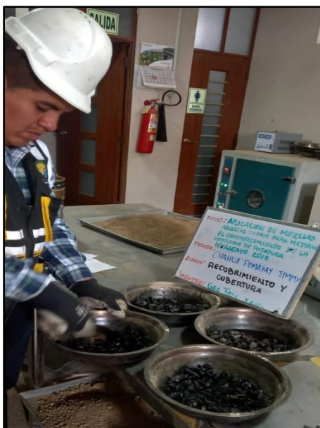
Fotografía N° 17: Recubrimiento de emulsión asfáltica con porcentaje de agua: 0.0%;0.5%,1.0% y 2.0%, según referencia del The Asphalt Institute; Manual Series N.º 14 (MS 14), U.S.A.
