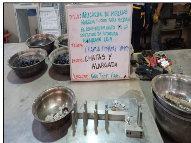
Fotografía N° 10: Uso del calibrador proporcional para determinación de los porcentajes de partículas chatas o alargadas en el agregado grueso, según referencia de la norma (ASTM D 4791).
