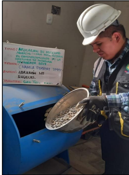
Fotografía N° 7: Determinar la resistencia a la degradación de las partículas del agregado grueso, con un total de peso 5000 gr, por el método “B” utilizando 11 esferas con la máquina de los ángeles mediante el ensayo de abrasión los ángeles, según referencia de la norma (ASTM C 131).
