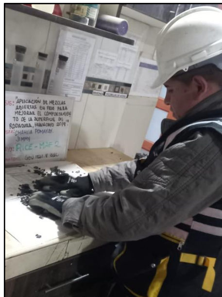
Fotografía N° 24: Material de mezcla asfáltica abierta para ensayo de máxima densidad teórica (rice), según referencia de la norma (ASTM D 2041).
