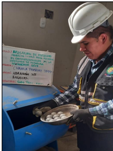
Fotografía N° 8: Ensayo de desgaste por abrasión los ángeles de partículas de agregado grueso, método “B” con 11 esferas según referencia de la norma (ASTM C 131).
