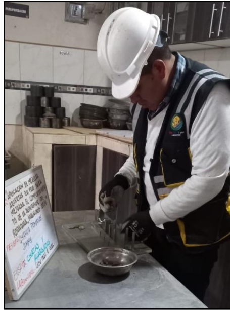
Fotografía N° 9: Ensayo de chatas y alargadas para la determinación de cuantas partículas son chatas y alargadas y cuantas partículas no son chatas y alargadas en el agregado grueso, según referencia de la norma (ASTM C 131).
