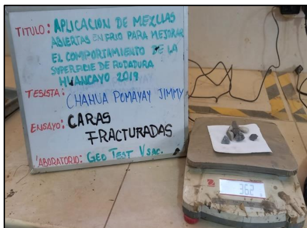
Fotografía N° 12: Determinar el porcentaje de masa del agregado grueso con partículas fracturadas, según referencia de la norma (ASTM D5821).
