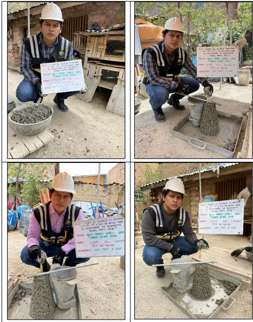
Fotografía N° 2: Medición de la temperatura del concreto permeable con 8% de vacíos. Asimismo, medición de asentamiento del concreto permeable con el 12% de vacíos.
