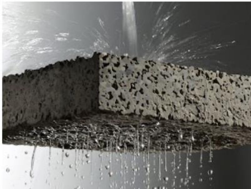
Figura 2. Evacuación de las aguas de la superficie a través del concreto permeable Fuente: Elaboración propia
