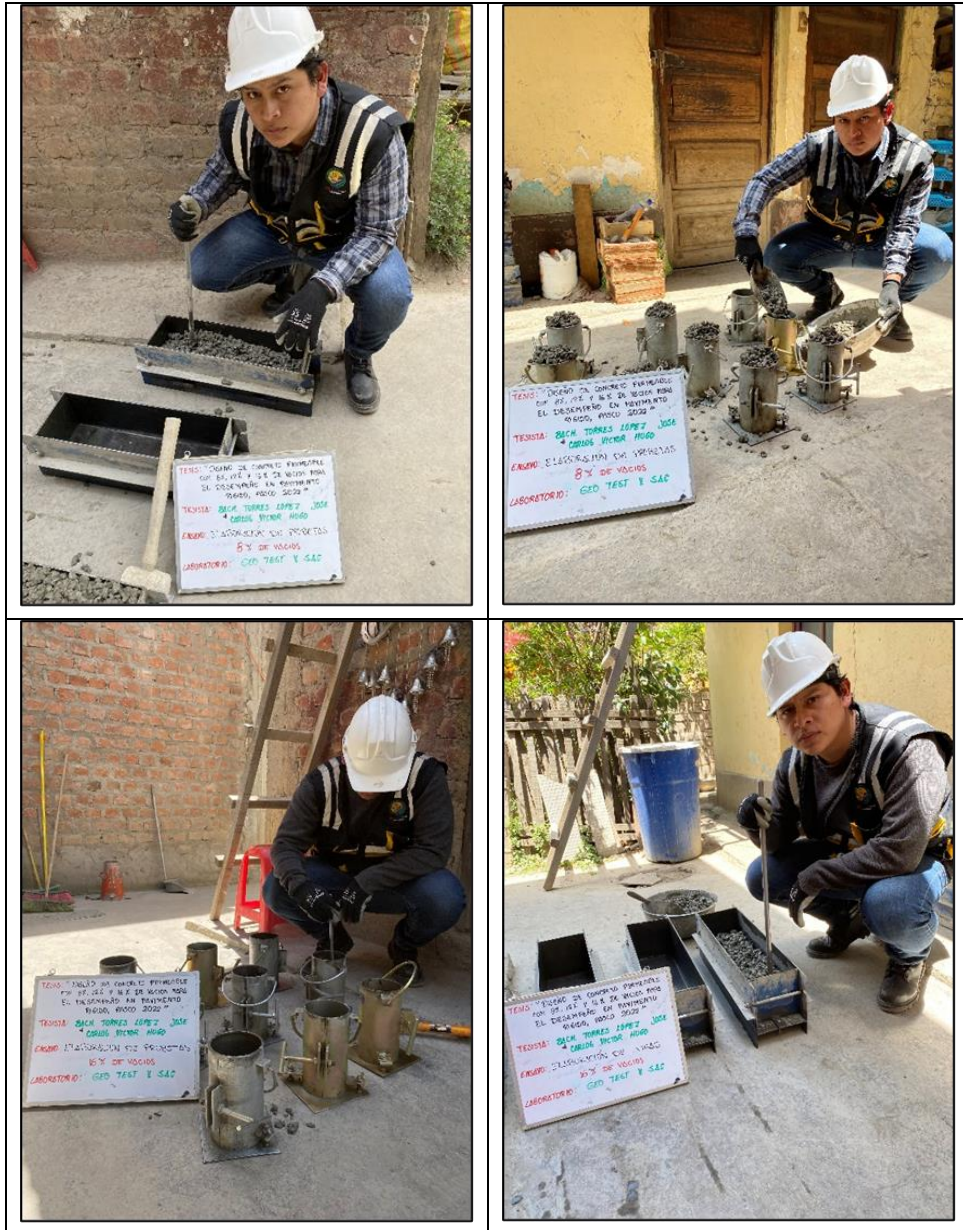
Fotografía N° 3: Elaboración de vigas y testigos cilíndricos de concreto permeable con 8% y 16% de vacíos.
