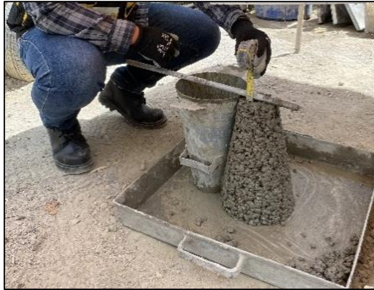
Figura 7. Medición de la trabajabilidad del concreto por el método cono de Abrams
