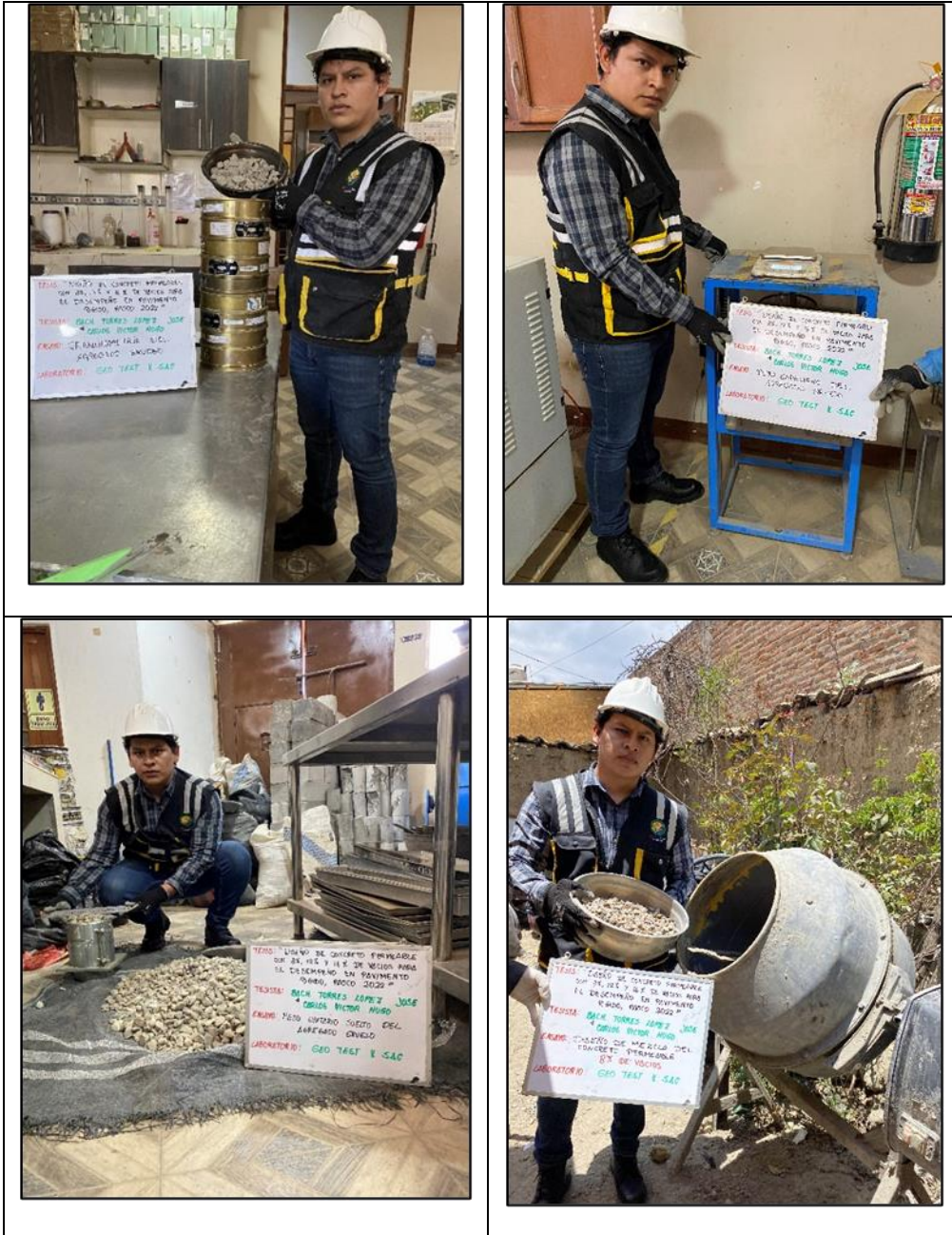
Fotografía N° 1: Ensayos de granulometría, peso unitario, peso específico de los agregados.
