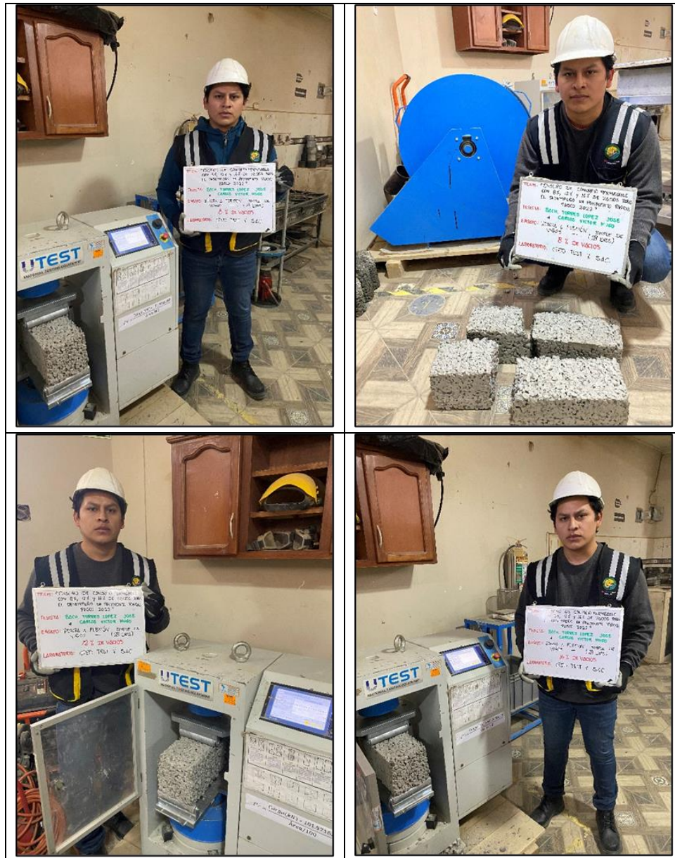
Fotografía N° 5: Resistencia a la flexión de muestra convencional y con 8%, 12% y 16% de vacíos.
