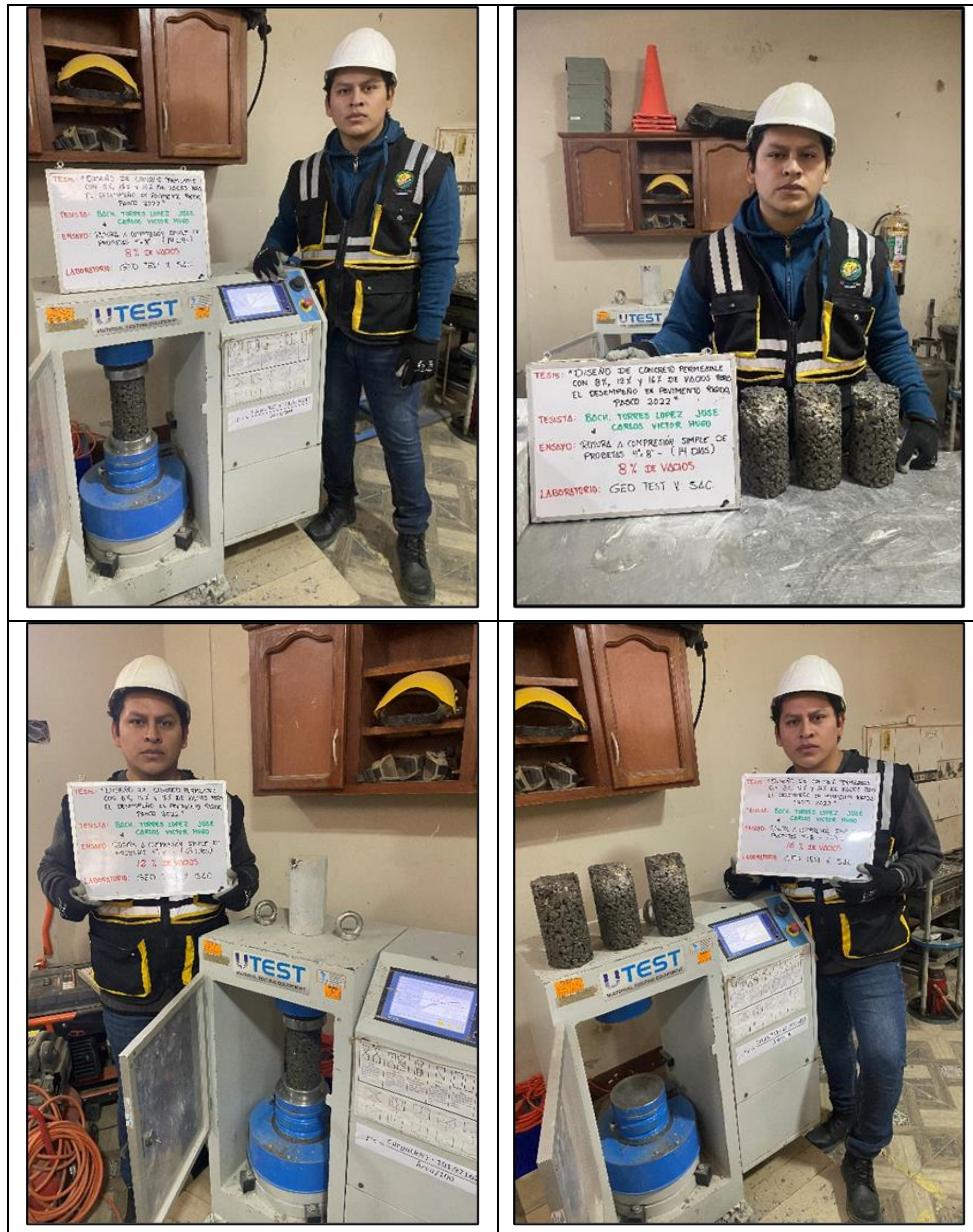
Fotografía N° 4: Resistencia a la compresión de muestra convencional y con 8%, 12% y 16% de vacíos.
