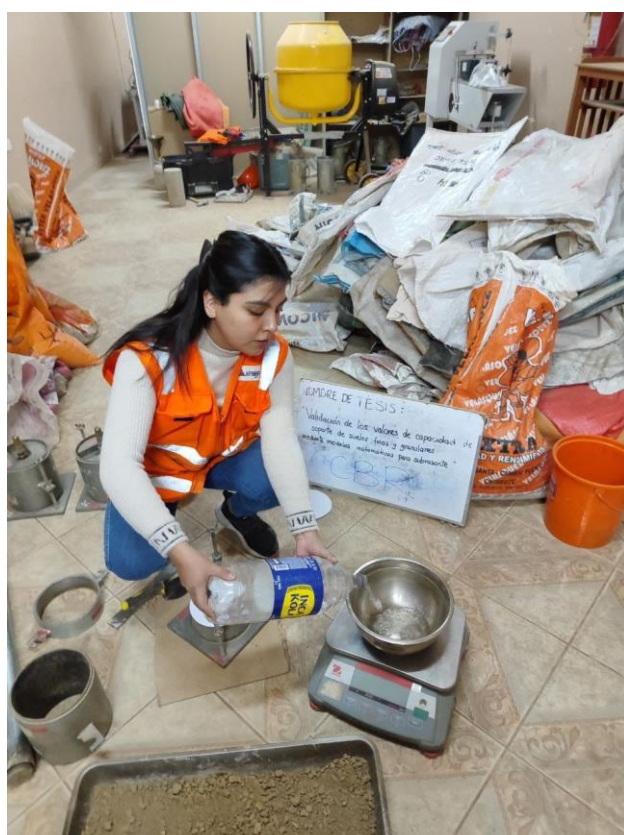
Fotografía 26. Medida de cantidad de agua para preparación de muestra para prueba CBR.
