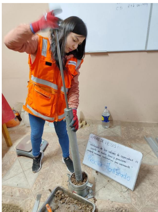
Fotografía 24. Compresión en el ensayo de Proctor modificado.
