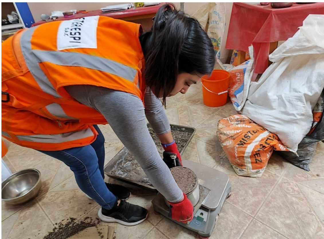
Fotografía 25. Pesaje de muestra para ensayo Proctor modificado.
