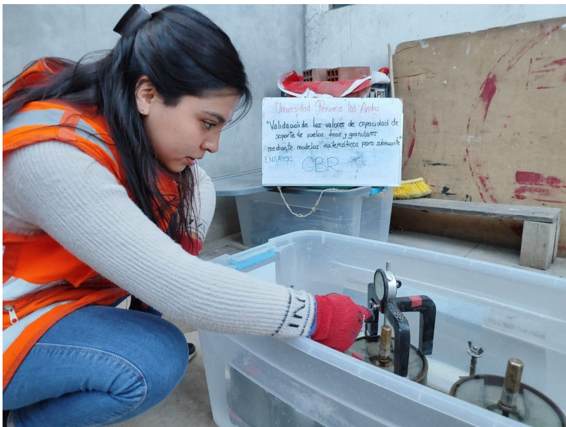
Fotografía 29. Lectura de dial en la prueba CBR.
