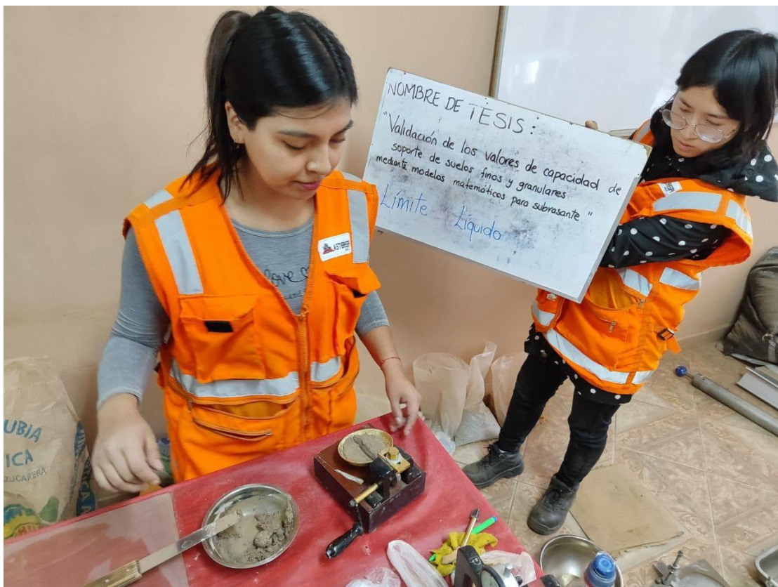
Fotografía 15. Uso de la copa de Casagrande en la prueba de límite líquido.
