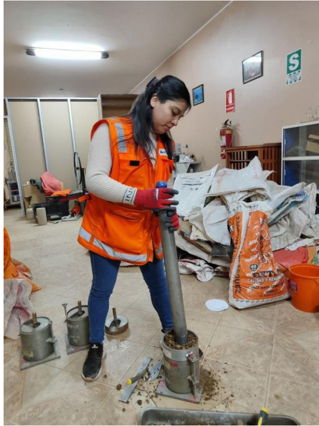
Fotografía 27. Compactación de muestra para ensayo CBR.
