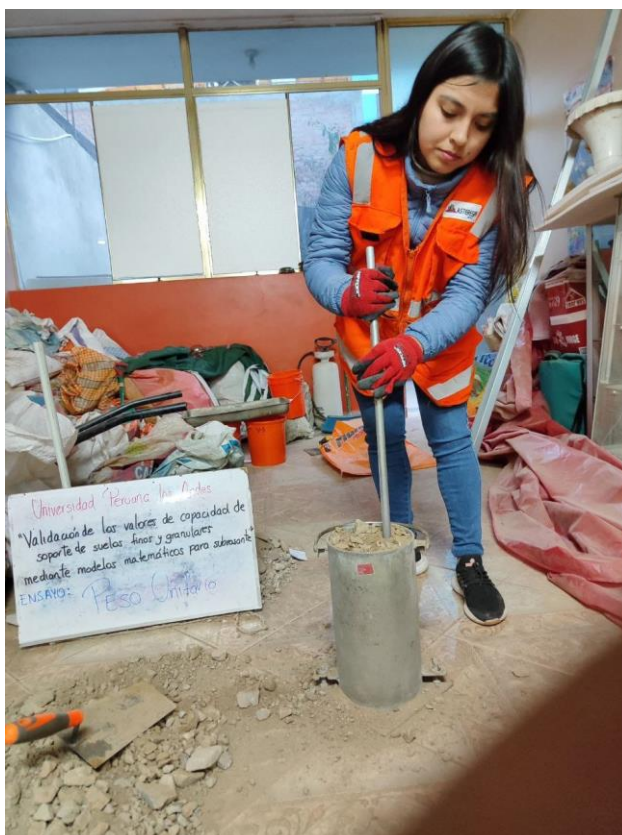
Fotografía 20. Preparación del ensayo de peso unitario del material de subrasante.
