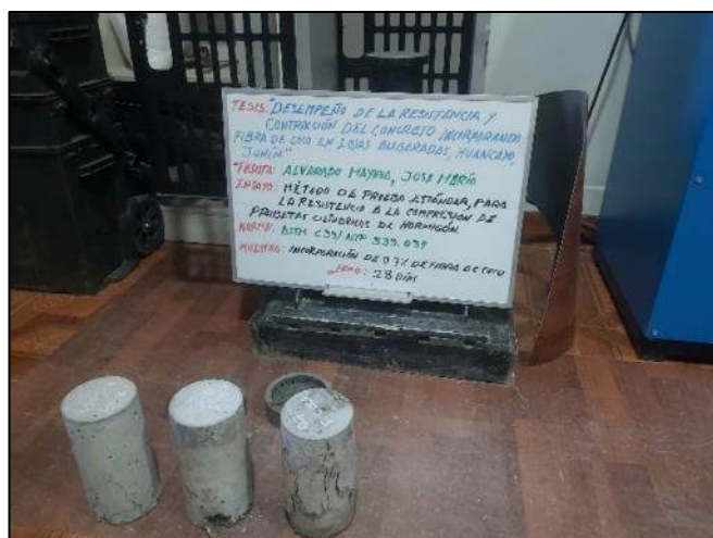
Fotografía 26. Rupturas de probetas a los 28 días de curado.
