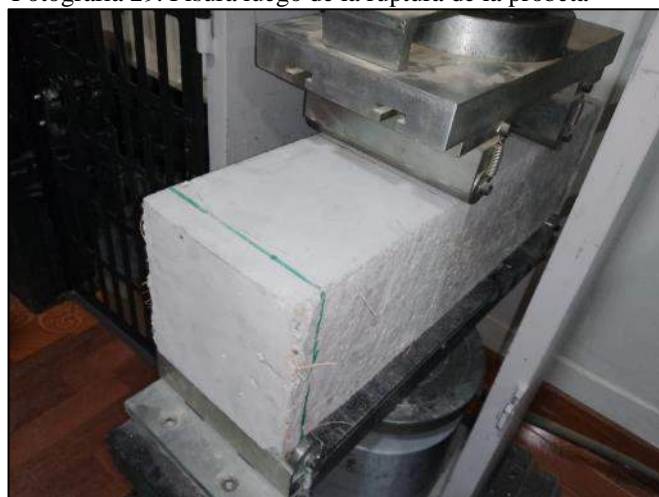
Fotografía 30. Evaluación de la resistencia a compresión a los 28 días.
