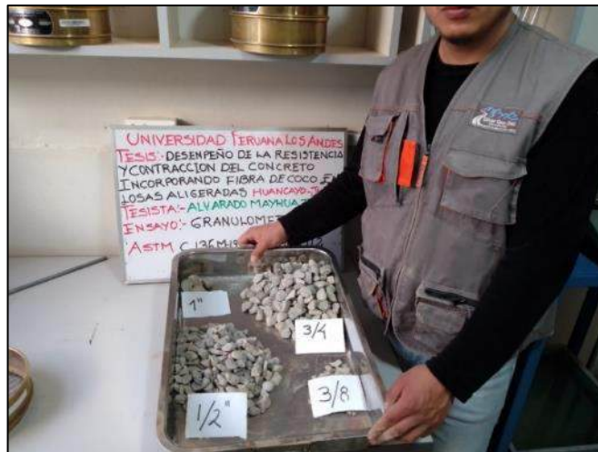
Fotografía 2. Selección granulométrica de agregados gruesos según ASTM C136.
