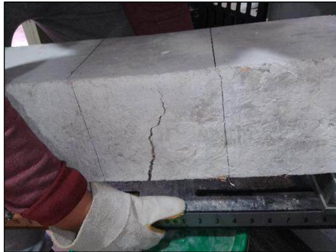
Fotografía 32. Ruptura de muestras luego de la evaluación a flexión.
