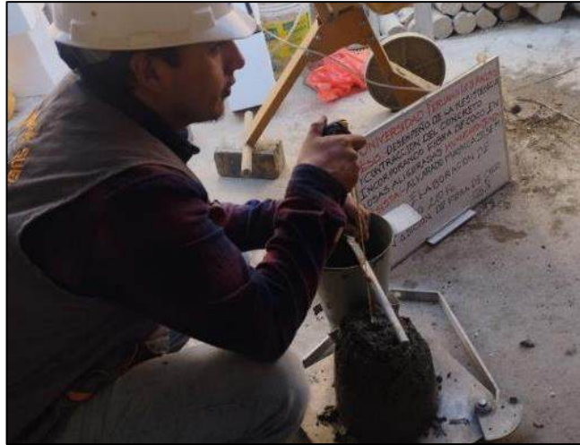
Fotografía 13. Medición del asentamiento del concreto con la adición de fibra de coco
