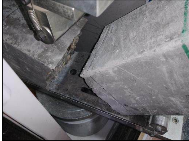
Fotografía 31. Retirado de muestra luego de la ruptura por flexión.
