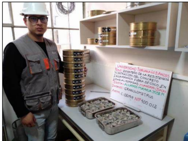
Fotografía 3. Realización del análisis granulométrico según NTP 400.012.
