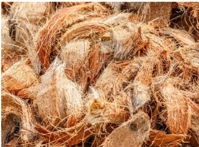
Figura 2.1. Fibra extraída de las cascaras de coco. Fuente: Chen (2023).
