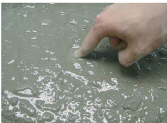
Figura 2.8. Exudación del concreto. Fuente: SIKA (2006).
