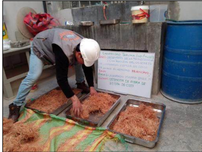
Fotografía 1. Se realiza la producción de las fibras de coco.
