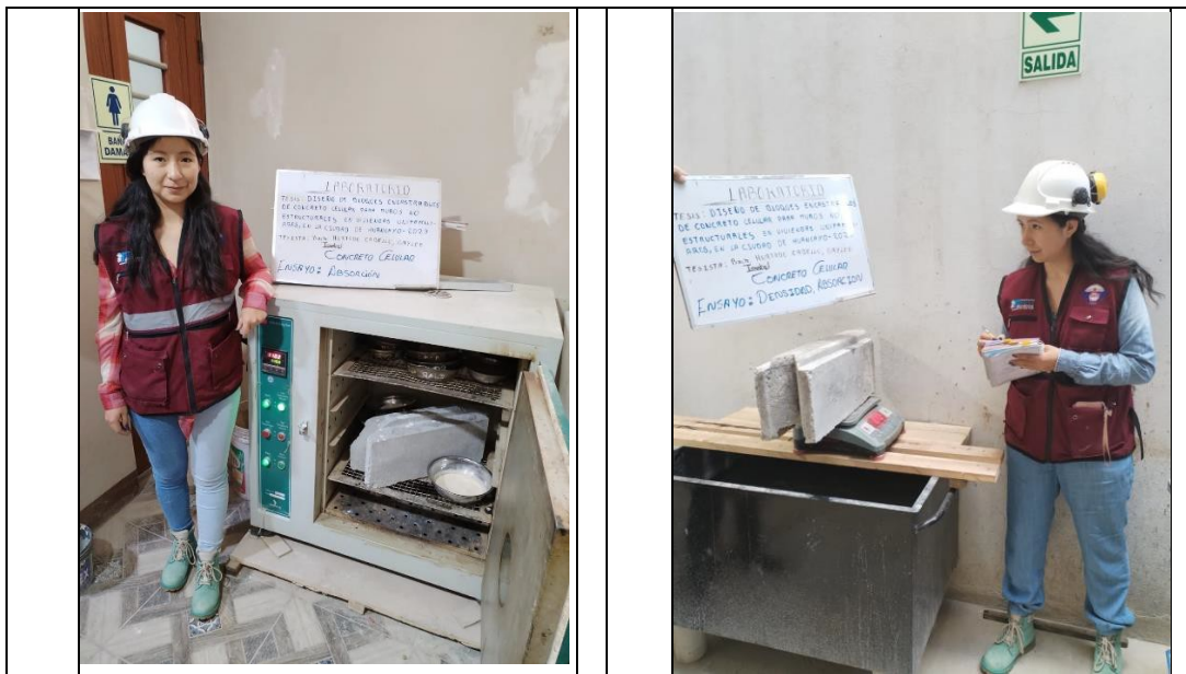
Fotografía No. 12: Prueba de densidad, absorción y % vacíos en CC. NTP 339.184.
