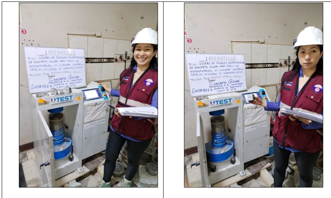
Fotografía No. 14: Prueba del esfuerzo a compresión de morteros de mortero en especímenes de cubos de 50mm. NTP 339.051.
