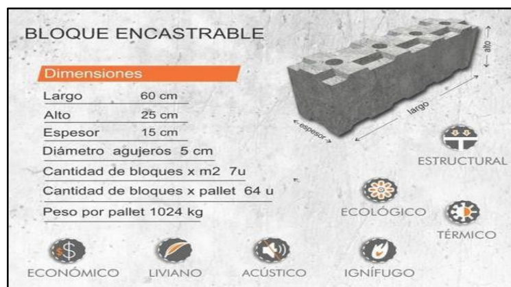
Figura 12. Dimensiones del bloque encastrable.
