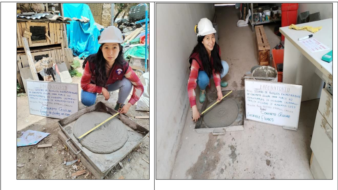
Fotografía No. 8: Ensayo de fluides del concreto convencional y concreto celular. NTP 339.219.
