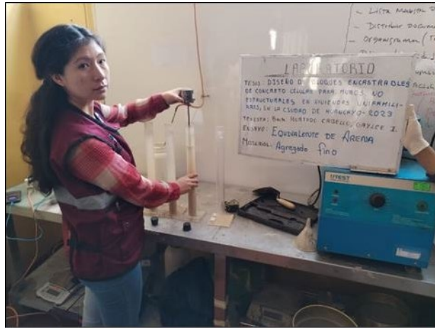
Fotografía No. 3: Prueba para determinar el valor de equivalente de arena. NTP 339.146. FUENTE: Propia
