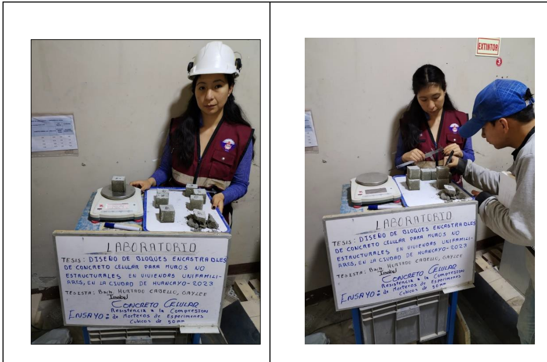
Fotografía No. 13: Prueba de fluctuación dimensional en el CC y celular.
