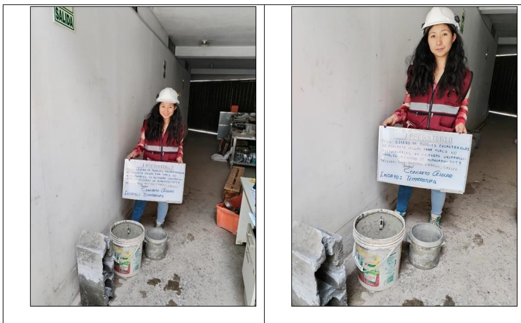
Fotografía No. 10: Ensayo de temperatura de concreto celular y convencional. NTP 339.184.
