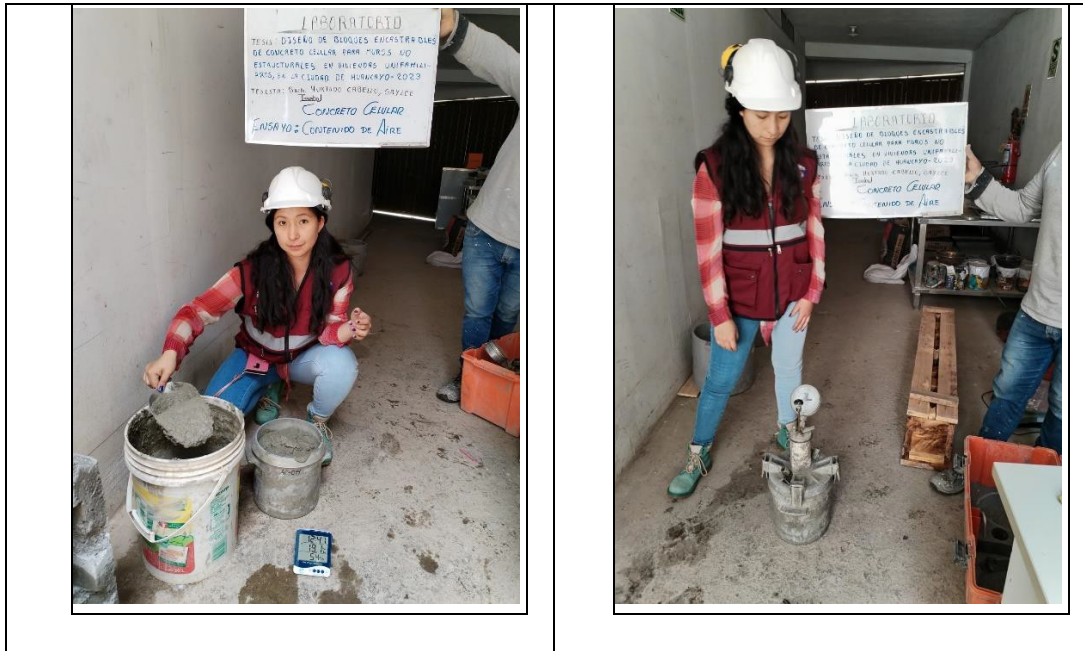
Fotografía No. 9: Ensayo de contenido de aire por el método de presión en concreto celular y convencional. NTP 339.083.
