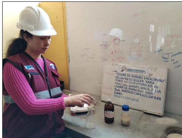
Fotografía No. 3: Prueba para determinar el valor de equivalente de arena. NTP 339.146. FUENTE: Propia
