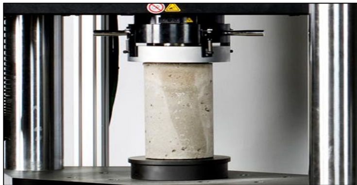
Figura 13. Ensayo a la compresión.
