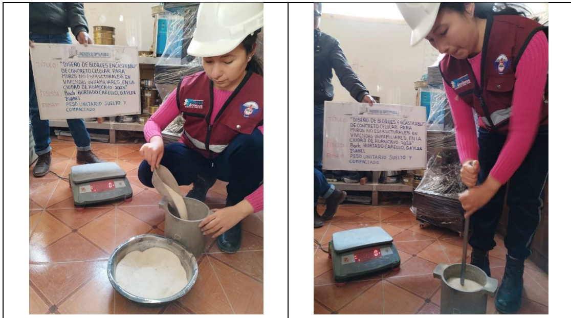
Fotografía No. 6: Prueba del cálculo de PUC y PUS. NTP 400.017.
