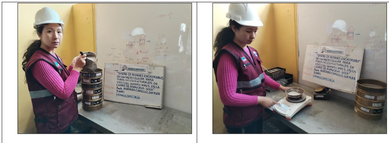
Fotografía No. 1: Evaluación de las dimensiones granulométricas del agregado.
