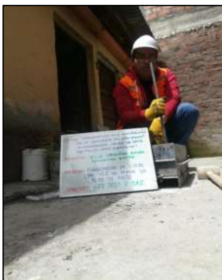
Fotografía N° 4: Elaboración de testigos rectangular con adición del 12% de ceniza de pepa de palta para sus respectivos tipos de ensayos, según referencia de la norma NTP 339.034 / ASTM C39.
