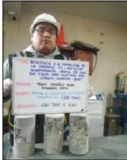
Fotografía N° 5: Testigos cilíndricos convencionales para la ESFUERZO a la compresión de los 28 días de edad, según referencia de la norma NTP 339.034 / ASTM C39.
