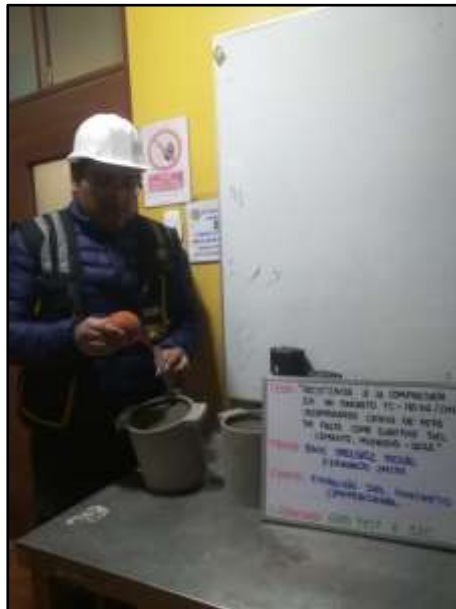
Fotografía N° 2: Control de la exudación del concreto convencional, según referencia de la norma NTP 339.077.
