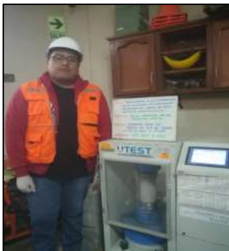
Fotografía N° 8: Testigo cilíndrico incorporado el 12% de ceniza de pepa de palta para la ESFUERZO a la compresión de los 14 días de edad, según referencia de la norma NTP 339.034 / ASTM C39.
