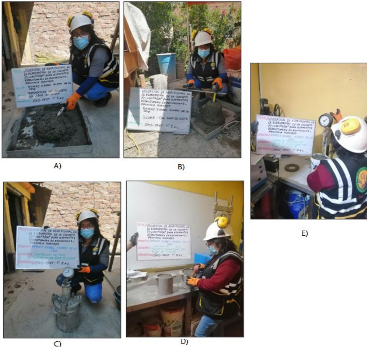
Fotografía N° 17: Pruebas en mezcla de concreto fresco: a) Temperatura, b) Consistencia, c) Contenido de aire, d) Exudación y e) Tiempo de fraguado.
