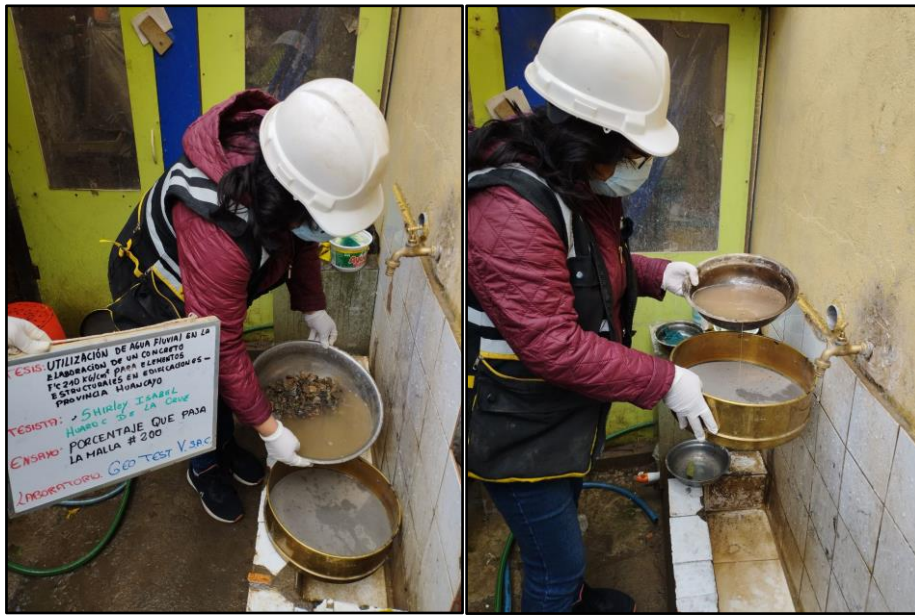
Fotografía N° 3: Evaluación de material fino pasante por la malla N°200.
