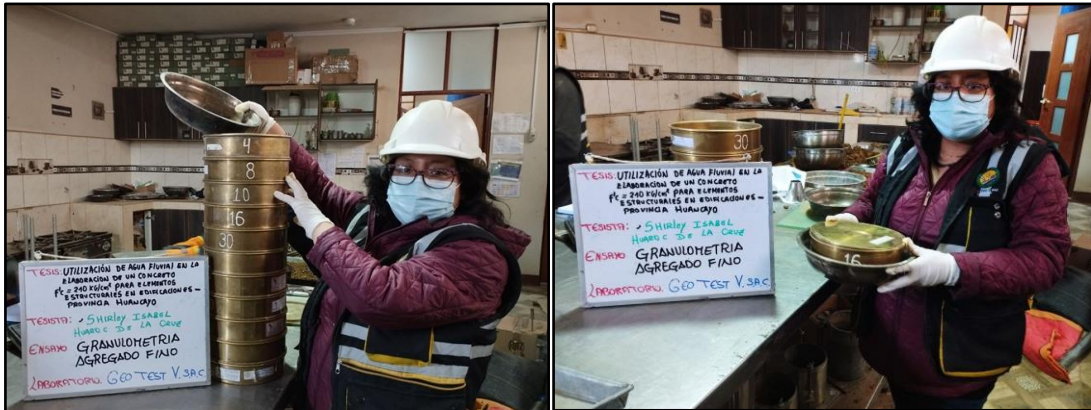
Fotografía N° 1: Evaluación granulométrica del árido fino.
