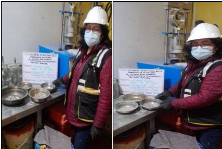
Fotografía N° 10: Prueba de desintegración del AG, evaluando la alterabilidad de los agregados ante condiciones atmosféricas.
