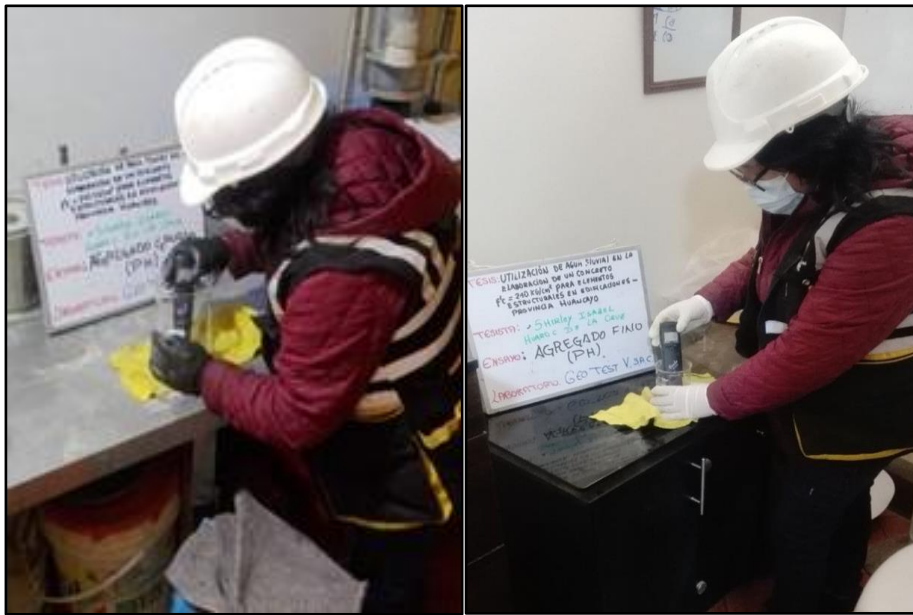
Fotografía N° 11: Análisis del PH MTC E 129. a) agregado grueso b) agregado fino.
