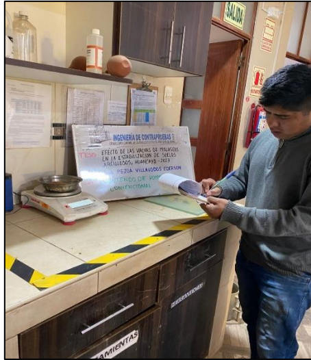
Fotografía N° 4: Registrando los resultados del pesado de la muestra convencional y modificados para el cálculo del Ensayo Contenido de Humedad, ASTM D2216.
