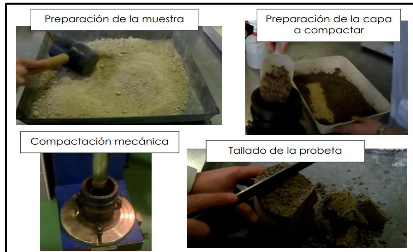
Figura N° 3. Procedimiento para realizar el ensayo de Proctor modificado.
