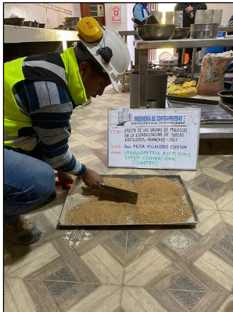
Fotografía N° 5: Cuarteo de la muestra convencional del Granulometría en suelos, según referencia de la Norma ASTM D6913.
