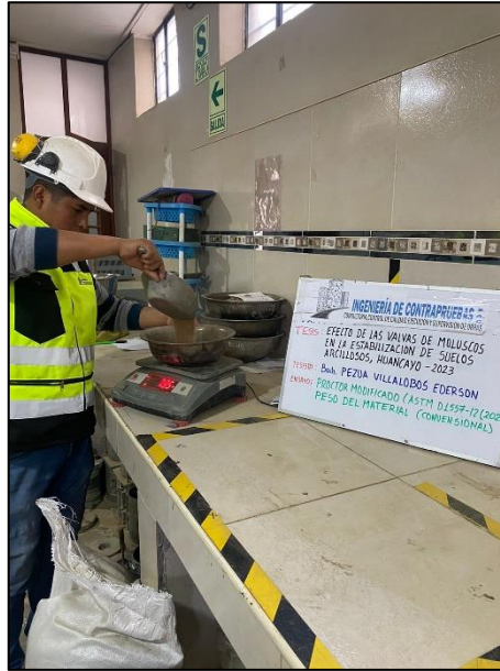
Fotografía N° 7: Pesado de la muestra convencional para el Ensayo Proctor Modificado en suelos, según referencia de la Norma ASTM 1557.
