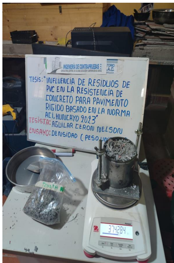
Foto 10 Evaluando la densidad de los residuos de PVC
