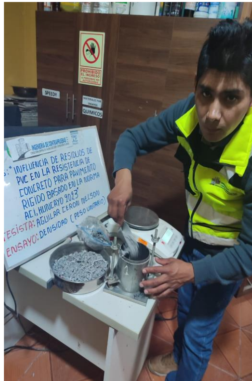
Foto 8 Analizando la densidad de los residuos PVC
