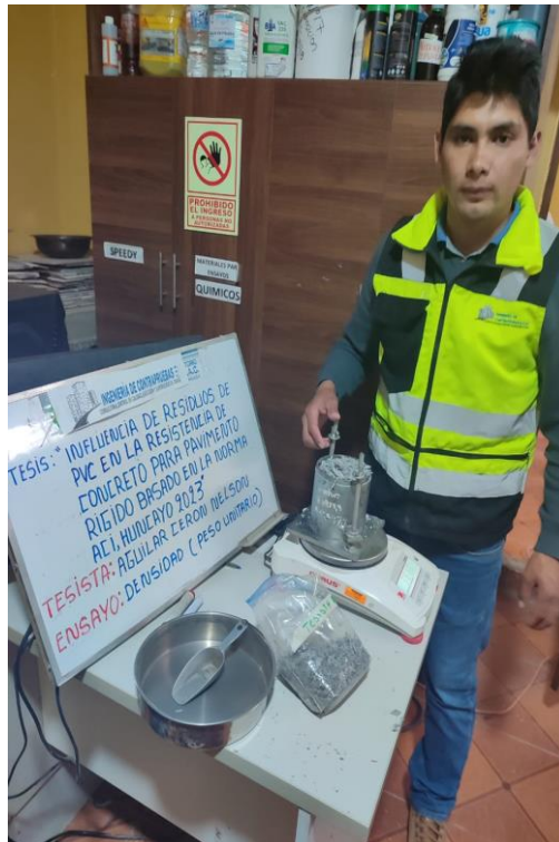
Foto 12 Pesaje de agregado retenido en los tamices
