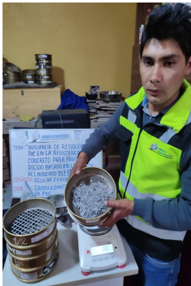
Foto 13. Analizando el tamaño de los residuos de PVC
