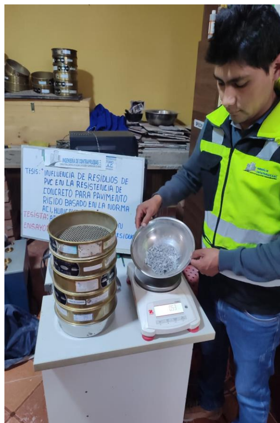
Foto 12 Pesaje de agregado retenido en los tamices
