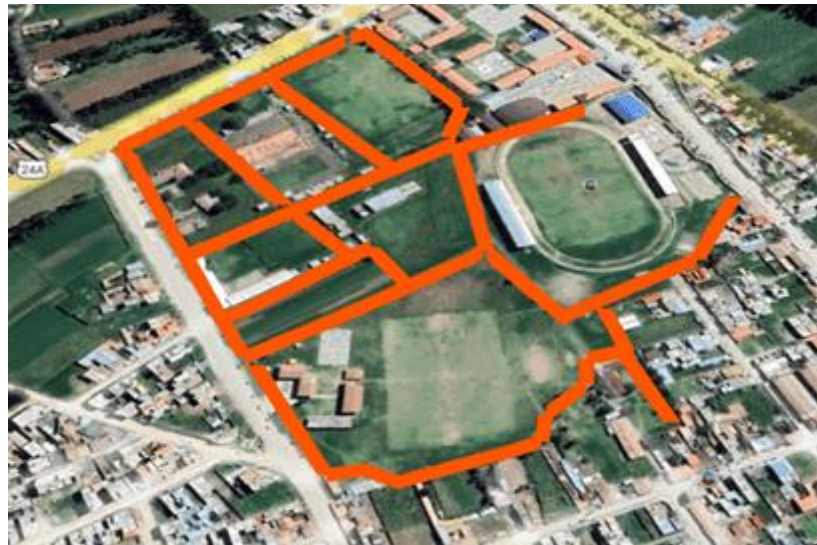
Figura N° 43: Áreas propuestas con zanjas de infiltración
