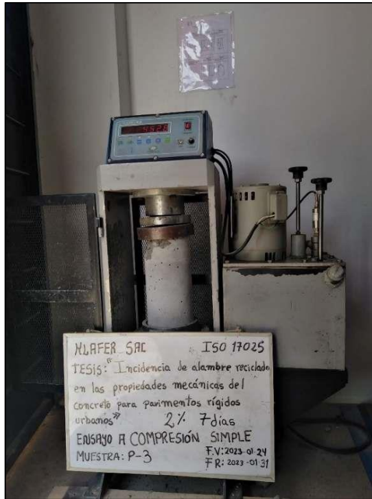
Fotografía N° 11 : Ensayo a compresión simple de la muestra 3 del diseño 2 % resultando su carga máxima de 452.8 KN a la edad de 7 días.
