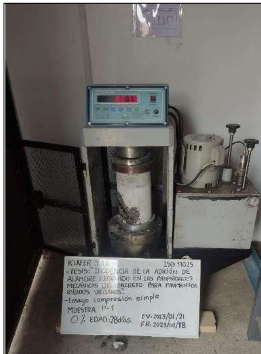
Fotografía N° 40: Ensayo a compresión simple de la probeta 1 del diseño patrón resultando su carga máxima de 557.5 KN a la edad de 28 días.
