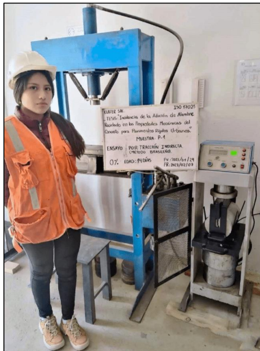
Fotografía N° 34: Ensayo a tracción indirecta de la muestra 1 del diseño patrón, resultando su carga máxima de 145.9 KN a la edad de 14 días.
