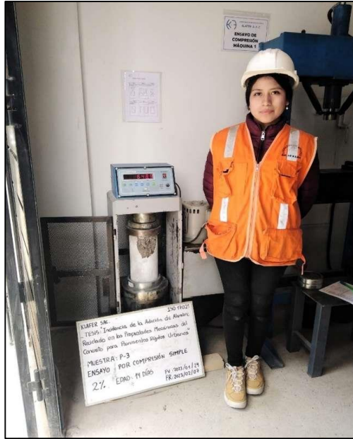
Fotografía N° 17 : Ensayo a compresión simple de la muestra 3 del diseño 2 % resultando su carga máxima de 648.9 KN a la edad de 14 días.
