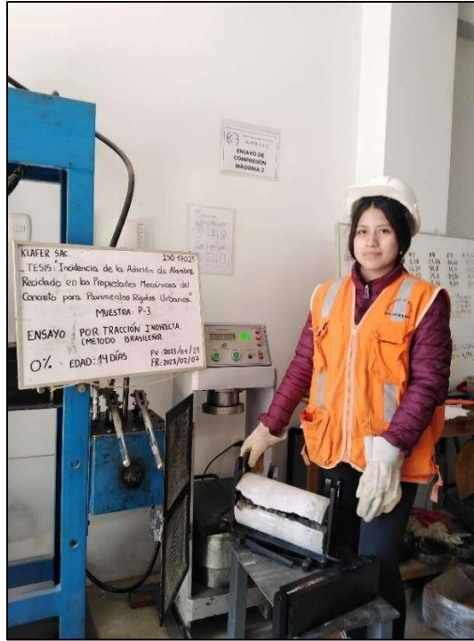
Fotografía N° 37: Ensayo a tracción indirecta de la muestra 3 del diseño patrón, resultando su carga máxima de 172.8 KN a la edad de 14 días.
