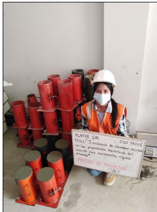
Fotografía N° 12 : Elaboración de testigos de concreto, con la adición de 2% de alambre reciclado; para la edad de 14 días.
