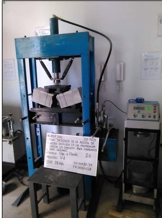
Fotografía N° 33: Ensayo a la flexión de la viga 2 del diseño 2 %, resultando su máxima carga aplicada 175.5 KN a la edad de 28 días.
