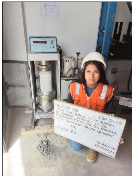
Fotografía N° 24: Ensayo a compresión simple de la muestra 2 del diseño patrón resultando su carga máxima 459.2 KN a la edad de 14 días.
