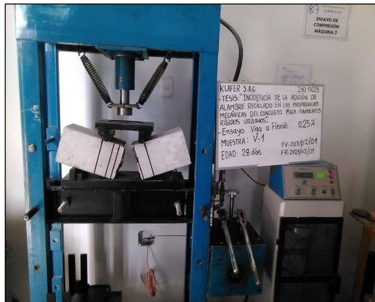
Fotografía N° 28: Vigas del diseño de 0.25 % para el ensayo a la flexión.
