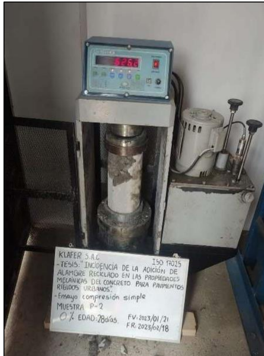
Fotografía N° 41: Ensayo a compresión simple de la probeta 2 del diseño patrón resultando su carga máxima de 629.2 KN a la edad de 28 días.
