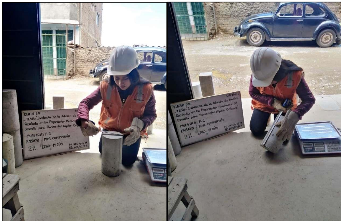
Fotografía N° 16 : Medida de la altura y del diámetro de la probeta diseño 2 % a la edad de 14 días.
