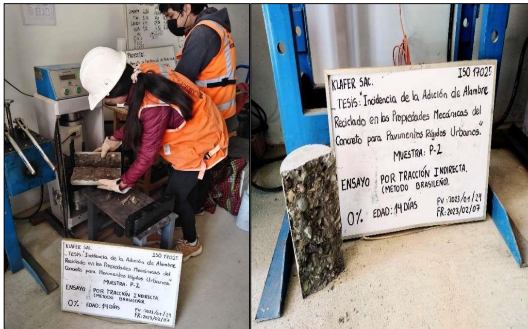
Fotografía N° 36: Ensayo a tracción indirecta de la muestra 2 del diseño patrón, resultando su carga máxima de 166.9 KN a la edad de 14 días.
