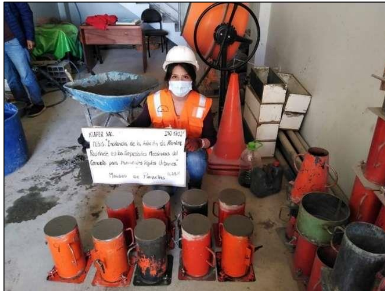
Fotografía N° 1 :Vista general de la elaboración de testigos de concreto, con la adición de 0.25% de alambre reciclado.
