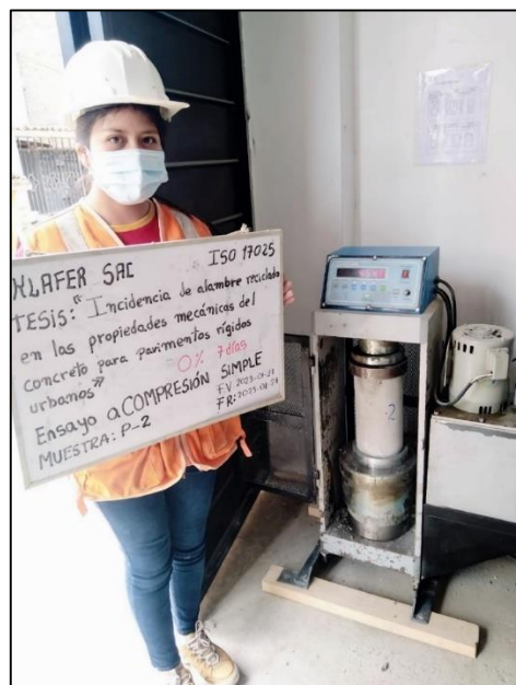
Fotografía N° 4 : Ensayo a compresión simple del diseño patrón resultando su carga máxima de 414.6 KN a la edad de 7 días.
