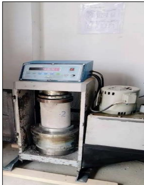
Fotografía N° 6 : Ensayo a compresión simple del diseño patrón resultando su carga máxima de 454.8 KN a la edad de 7 días.
