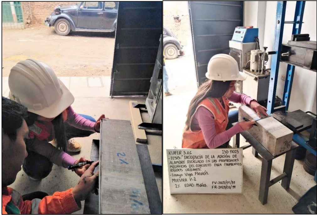
Fotografía N° 31: Ensayo a la flexión de la viga 1 del diseño 2%, resultando su máxima carga aplicada 164.3 KN a la edad de 14 días.
