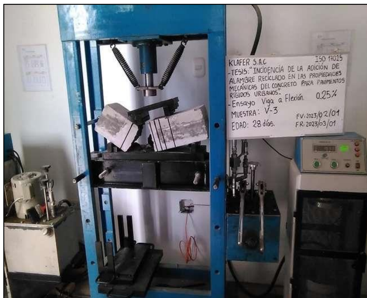
Fotografía N° 30: Ensayo a la flexión de la viga 3 del diseño 0.25 %, resultando su máxima carga aplicada 136.9 KN a la edad de 28 días.
