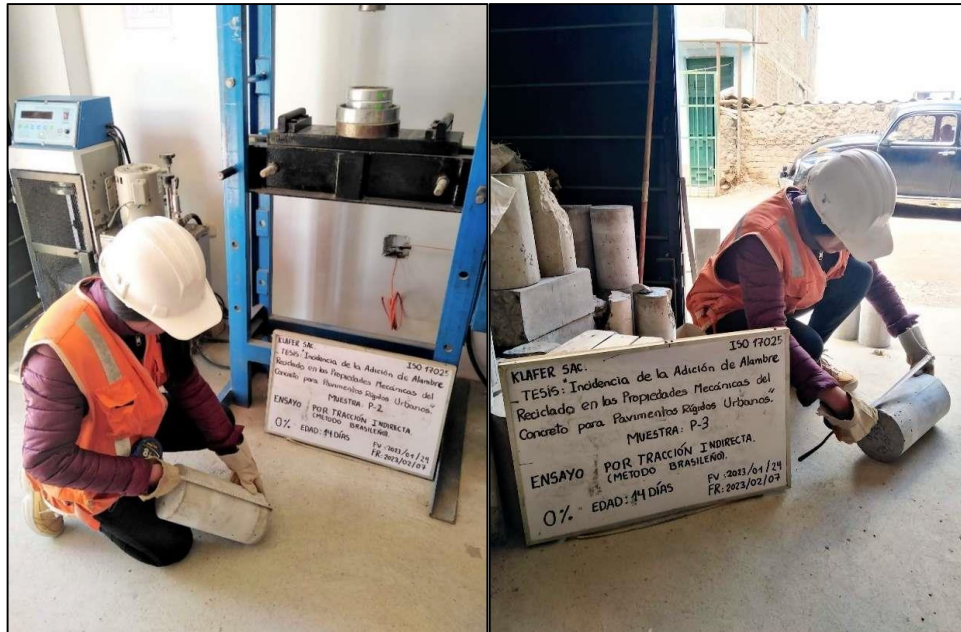
Fotografía N° 35: Toma de medidas de la probeta 2 y 3 de diseño patrón, a edad de 14 días.
