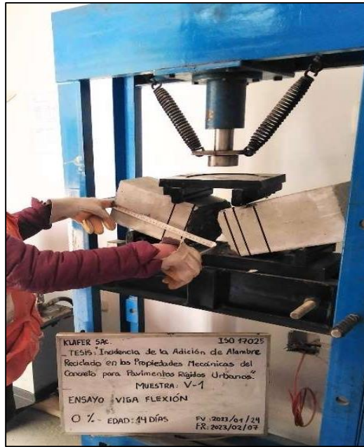
Fotografía N° 25: Ensayo a la flexión de la viga 1 del diseño patrón a la edad de 14 días.
