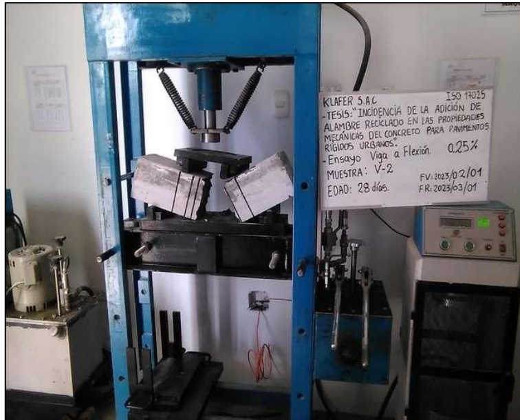
Fotografía N° 29: Ensayo a la flexión de la viga 2 del diseño 0.25 %, resultando su máxima carga aplicada 173.2 KN a la edad de 28 días.
