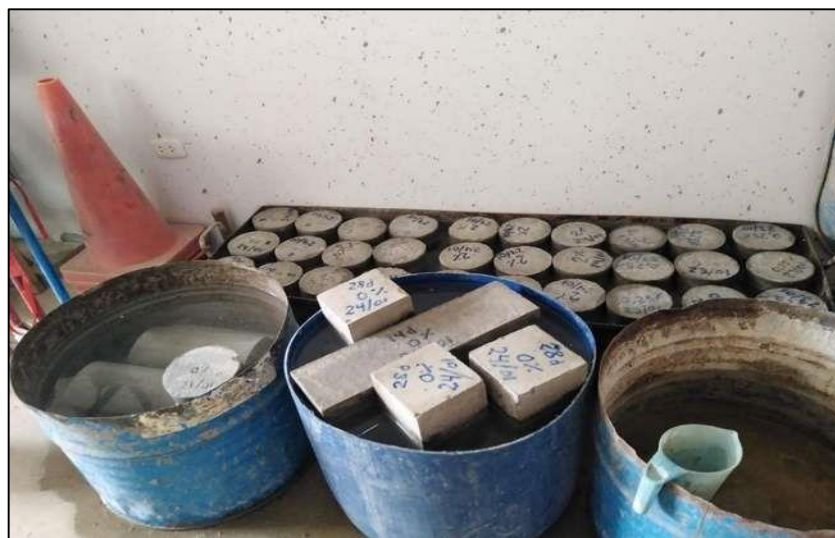
Fotografía N° 8 : Pozas de curado de testigos de concreto.
