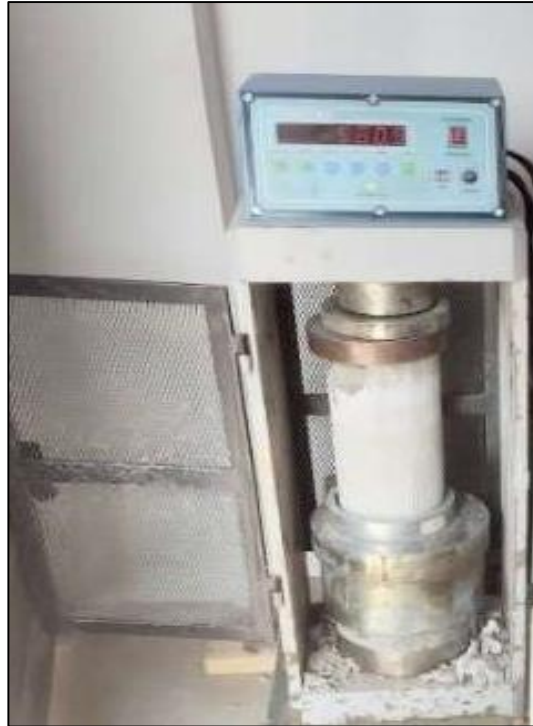
Fotografía N° 23: Ensayo a compresión simple de la muestra 1 del diseño patrón resultando su carga máxima 550.1 KN a la edad de 14 días.
