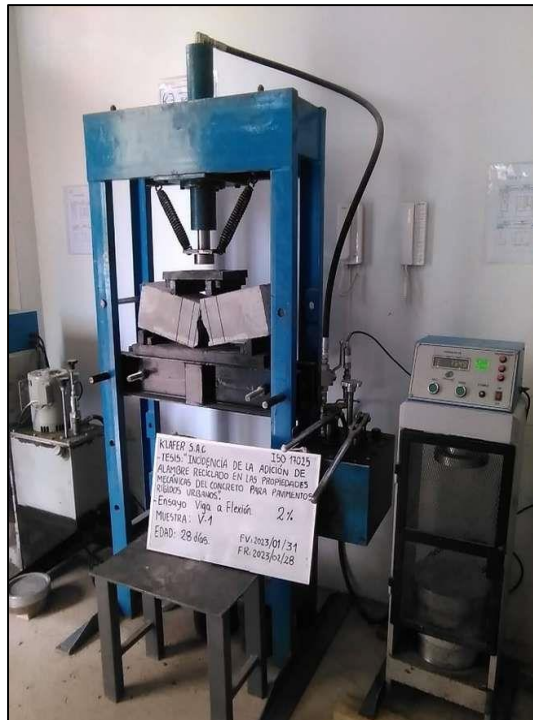
Fotografía N° 32: Ensayo a la flexión de la viga 1 del diseño 2 %, resultando su máxima carga aplicada 164.3 KN a la edad de 28 días.
