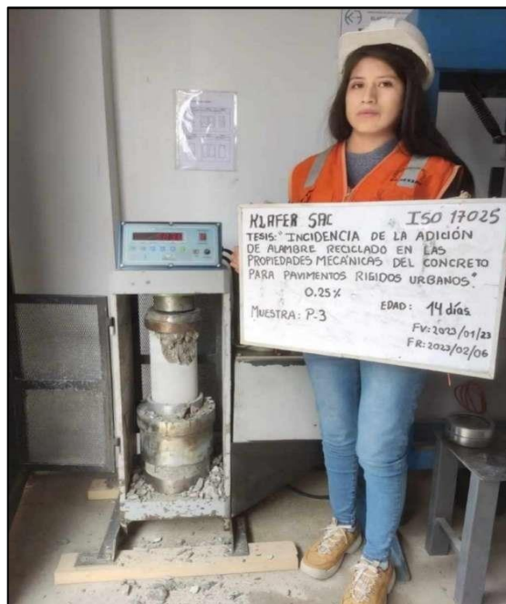
Fotografía N° 22: Ensayo a compresión simple de la muestra 3 del diseño 0.25% resultando su carga máxima 583.6 KN a la edad de 14 días.
