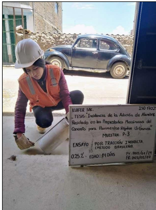
Fotografía N° 37: Ensayo a tracción indirecta de la muestra 3 del diseño patrón, resultando su carga máxima de 172.8 KN a la edad de 14 días.
