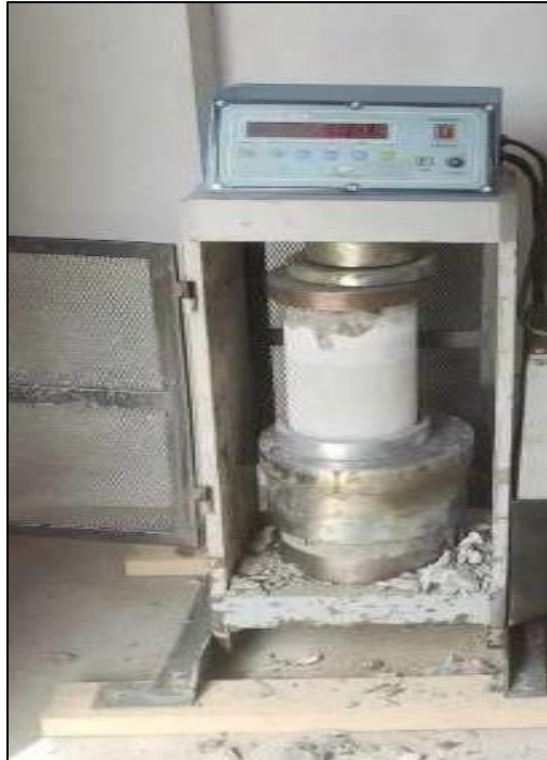
Fotografía N° 21: Ensayo a compresión simple de la muestra 1 del diseño 0.25% resultando su carga máxima 560 KN a la edad de 14 días.
