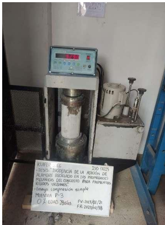
Fotografía N° 42: Ensayo a compresión simple de la probeta 3 del diseño patrón resultando su carga máxima de 629 KN a la edad de 28 días.
