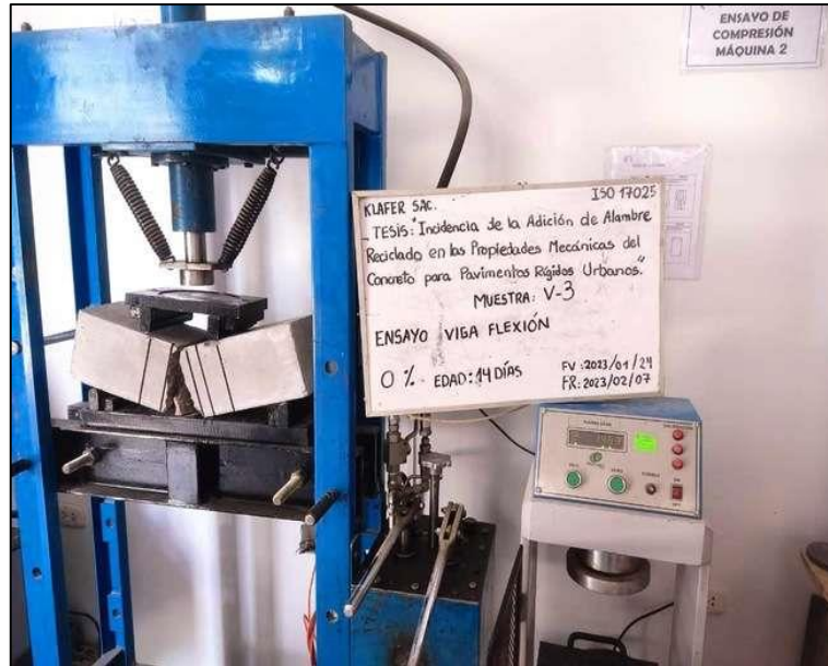
Fotografía N° 27: Ensayo a la flexión de la viga 3 del diseño patrón, resultando su máxima carga aplicada 146.3 KN a la edad de 14 días.
