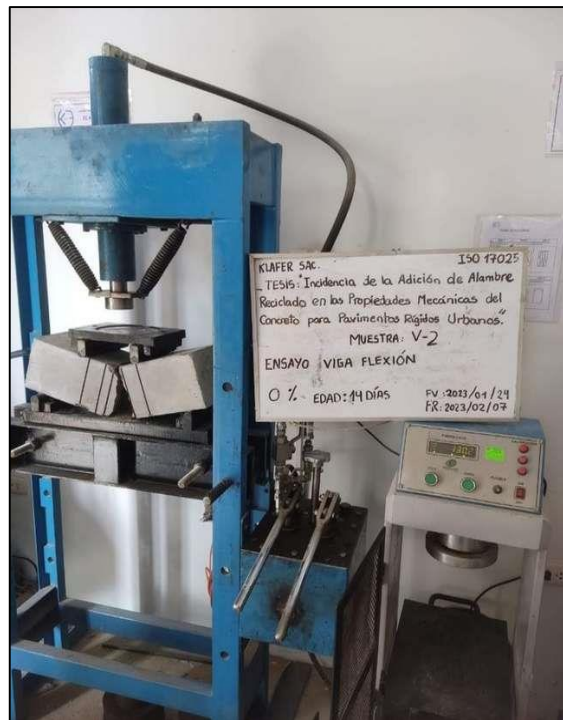
Fotografía N° 26: Ensayo a la flexión de la viga 2 del diseño patrón, resultando su máxima carga aplicada 130.2 KN a la edad de 14 días.
