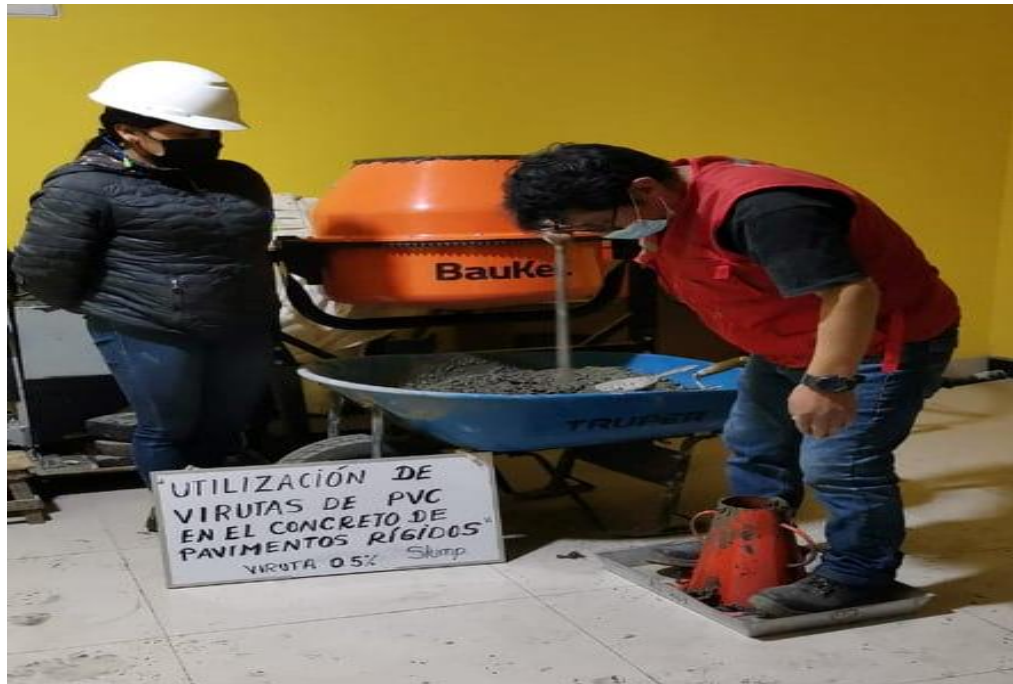
Figura 40. Ensayo de cono de Abrams
