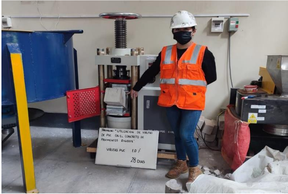
Figura 50. Ensayo de resistencia a la flexión con la adición de 1.0% de virutas de PVC
