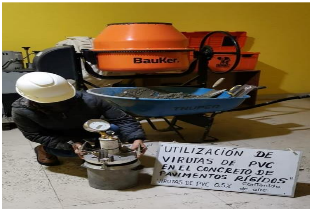
Figura 41. Sellando la olla Washington e incorporación de agua
