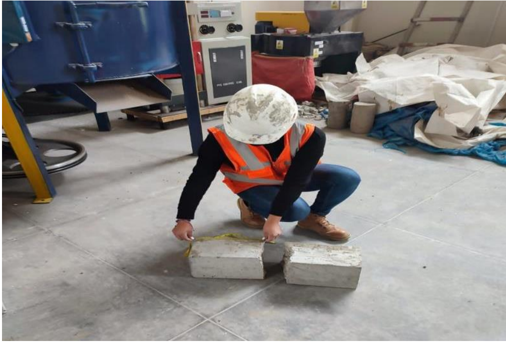
Figura 54. Medida del lado derecho de la viga a la muestra con adición al 1.5%
