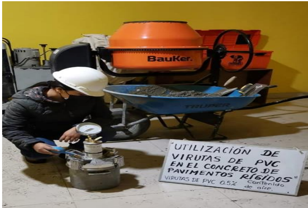
Figura 42. Utilizando el equipo para sacar el ensayo de porcentajes de vacíos
