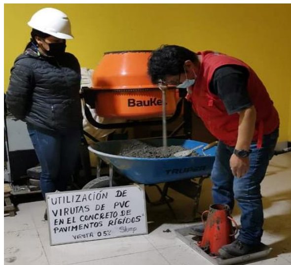
Figura 13. Ensayo de cono de Abrams
