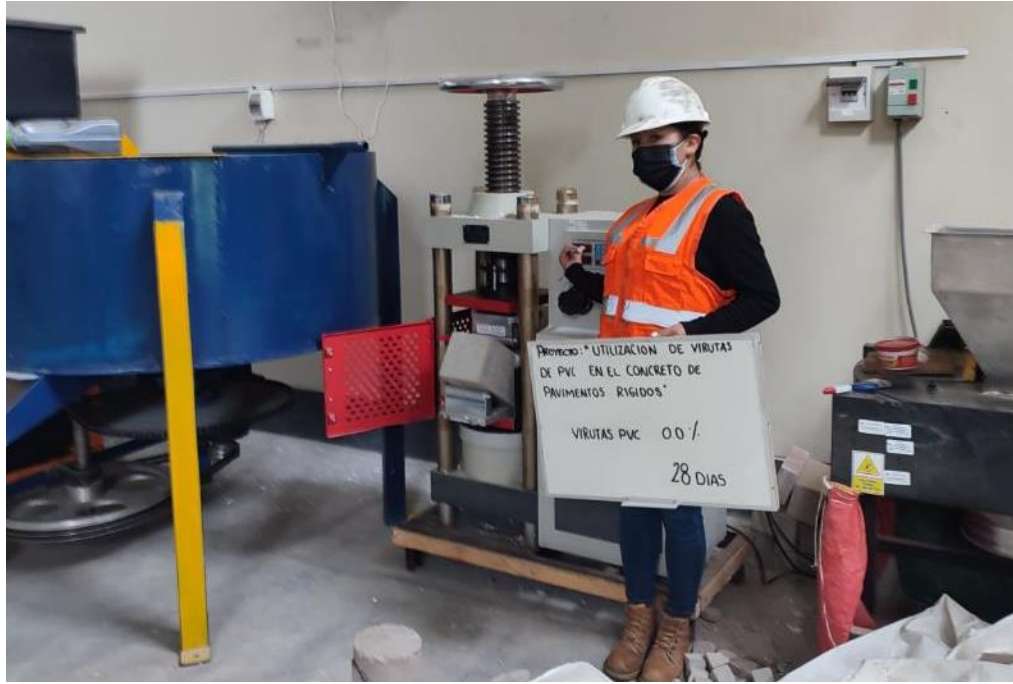
Figura 48. Ensayo de ruptura a los 28 días con el 0.0% de virutas de PVC
