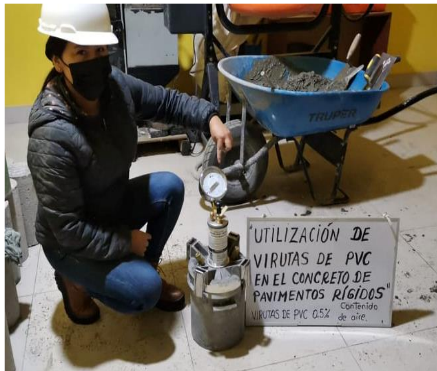
Figura 17. Ensayo de contenido de aire
