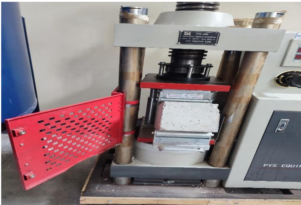
Figura 53. Equipo de ensayo de resistencia a la flexión del hormigón en vigas simplemente apoyadas con carga en el centro del tramo
