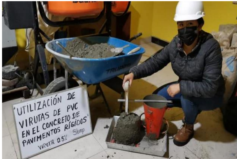
Figura 14. Prueba del asentamiento del concreto fresco (slump)
