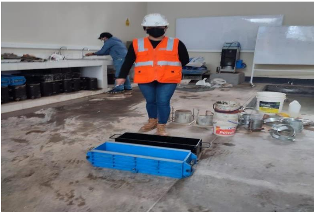
Figura 47. Moldes para vigas para determinar la resistencia a la flexión
