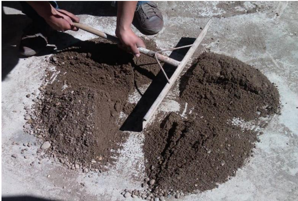
Figura 29. Cuarteo de la muestra
