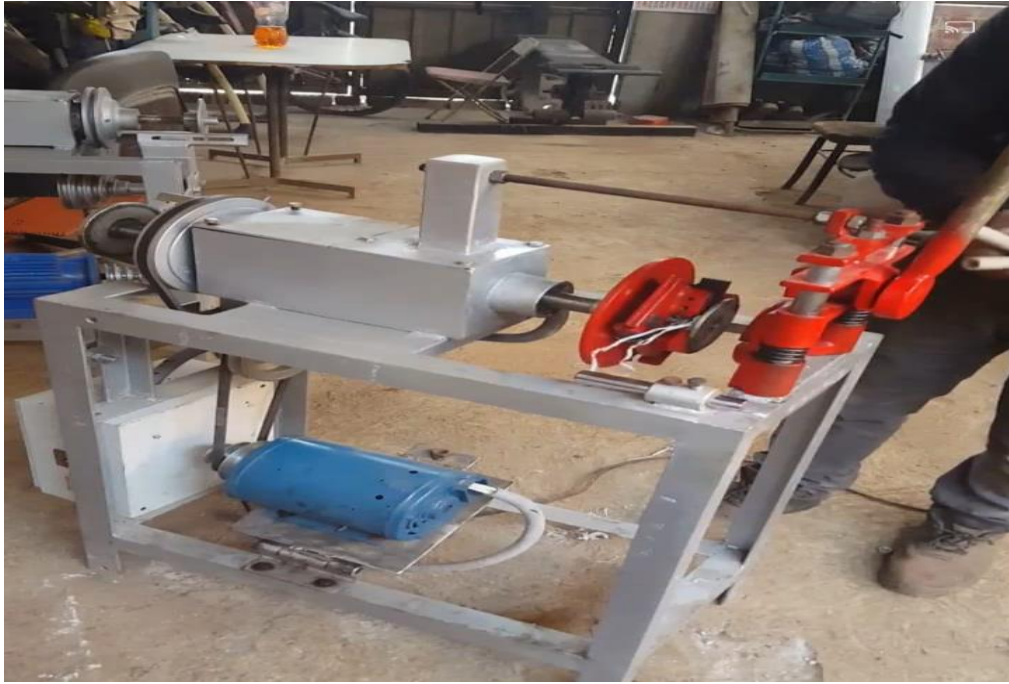
Figura 24. Elaboración de niples de PVC
