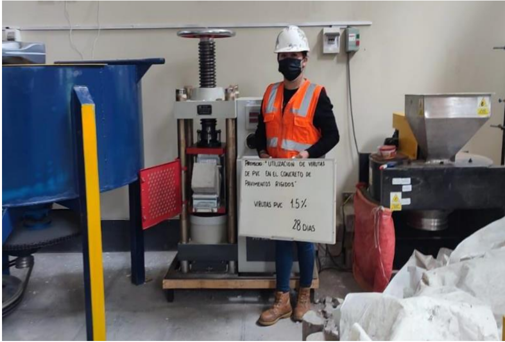
Figura 52. Ensayo de resistencia a la flexión con la adición del 1.5% de virutas de PVC
