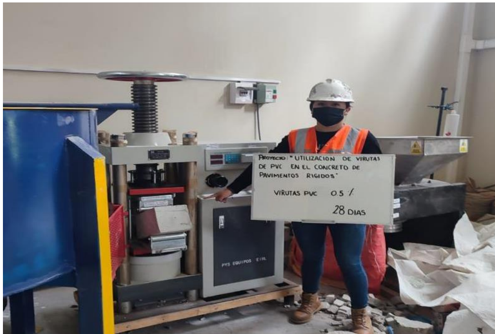
Figura 49. Ensayo de resistencia a la flexión con la adición de 0.5% de virutas de PVC
