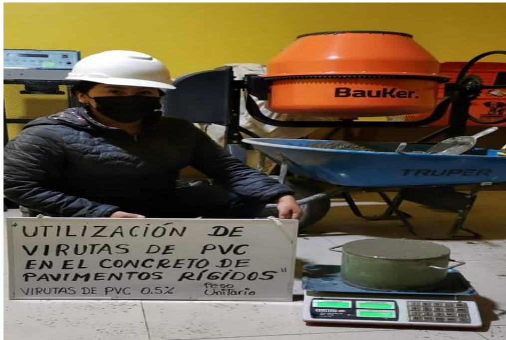
Figura 38. Ensayo de peso unitario
