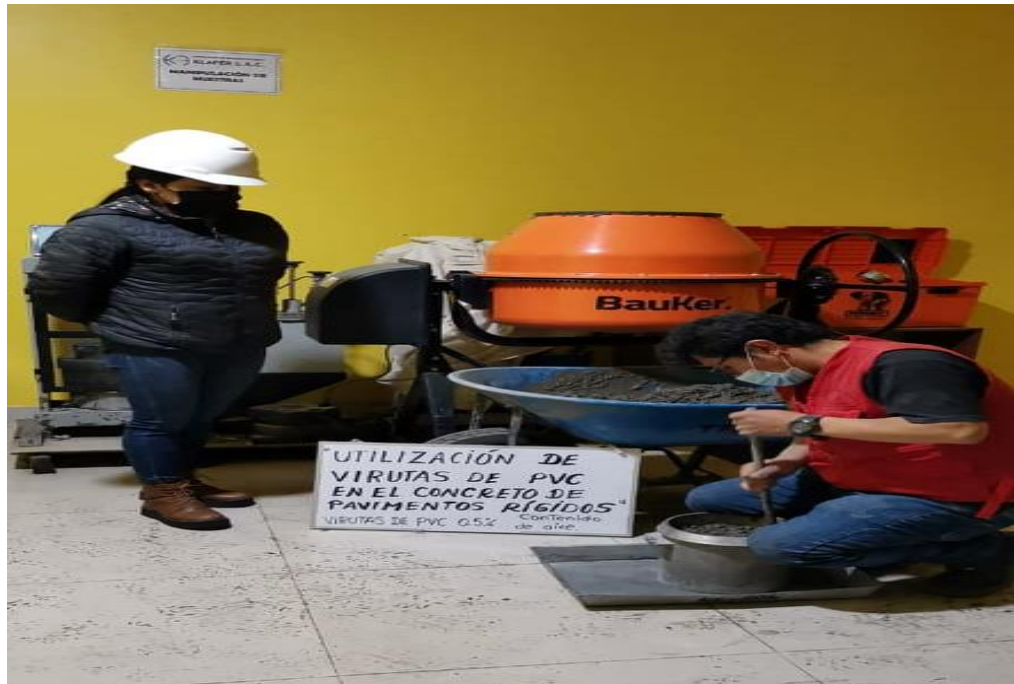
Figura 38. Ensayo de peso unitario
