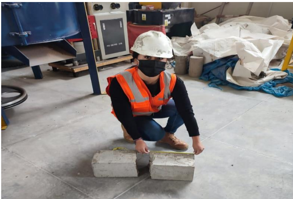
Figura 55. Medida del lado izquierdo de la viga a la muestra con adición al 1.5%
