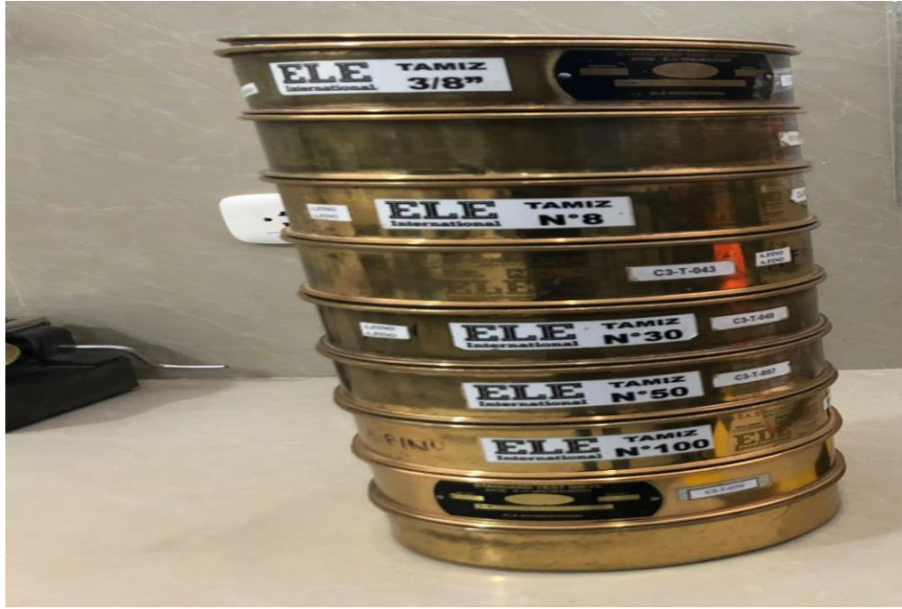
Figura 28. Juego de tamices para la granulometría
