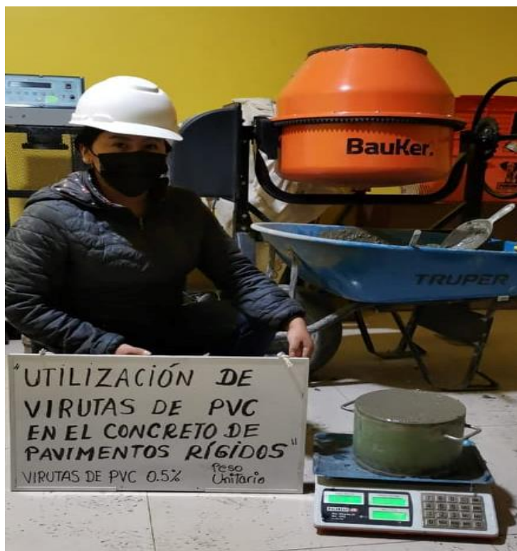
Figura 15. Peso unitario del concreto
