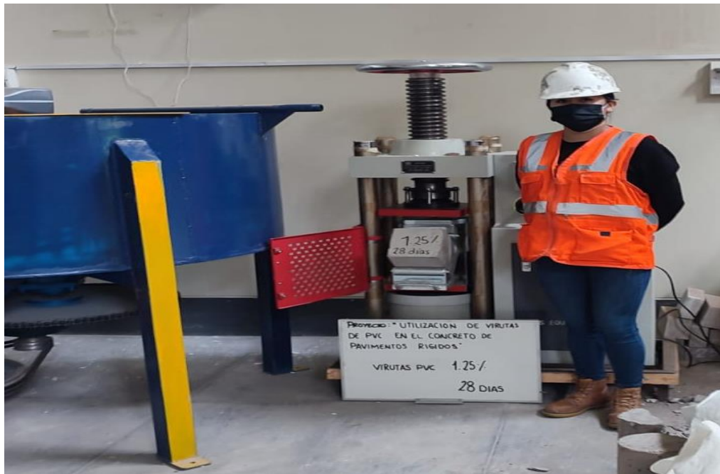
Figura 51. Ensayo de resistencia a la flexión con la adición de 1.25% de virutas de PVC
