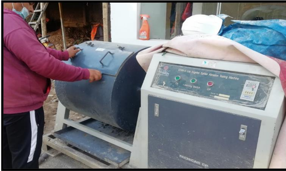
Figura 14: Ensayo Cántabro – Método Maquina de los Ángeles MTC E515
