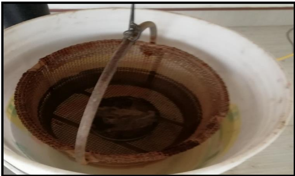
Figura 16: Impermeabilidad- Saturación de las muestras- Peso específico Bulk de mezclas asfálticas
