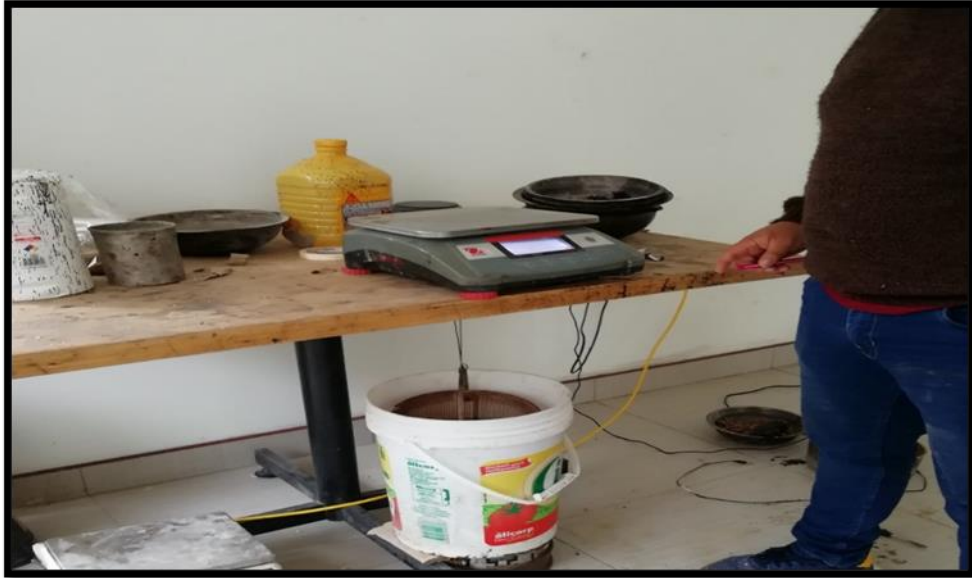
Figura 15: Impermeabilidad- Saturación de las muestras- Peso específico Bulk de mezclas asfálticas
