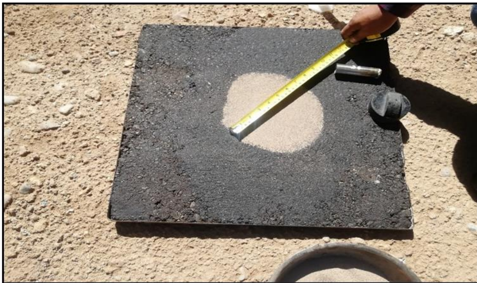
Figura 11: Ensayo del Círculo de Arena- Macro textura
