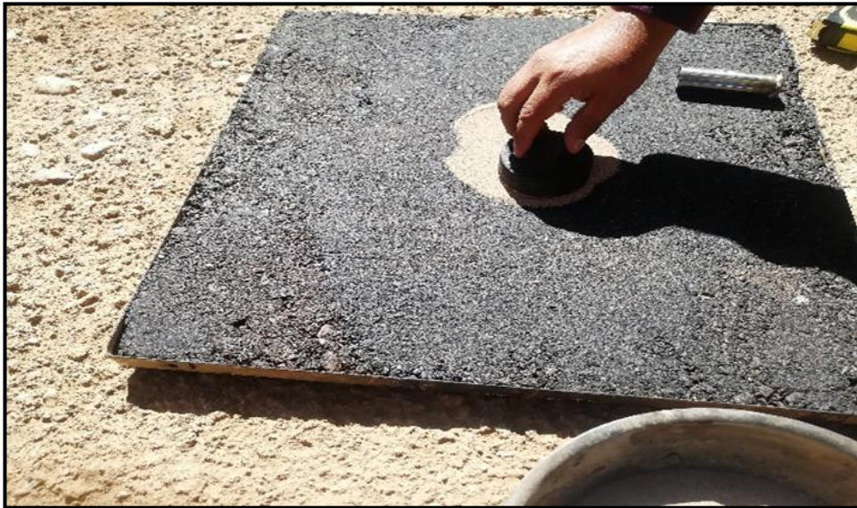
Figura 10: Ensayo del Círculo de Arena- Macro textura
