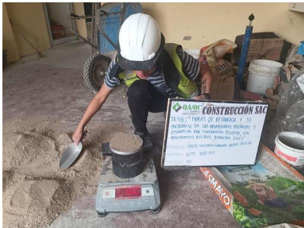
**Fotografía N°07:** Proceso del ensayo de peso unitario suelto del agregado fino.
