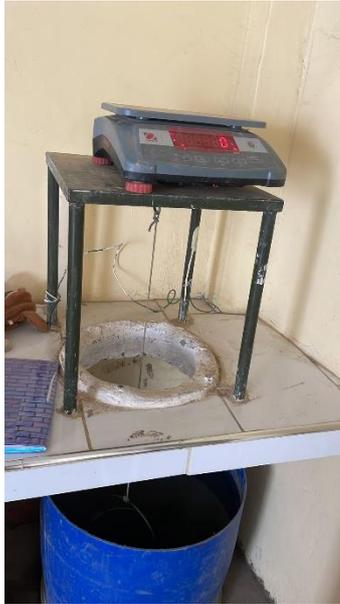
**Fotografía N°06:** Vista general del proceso de ensayo de peso específico del agregado grueso.
