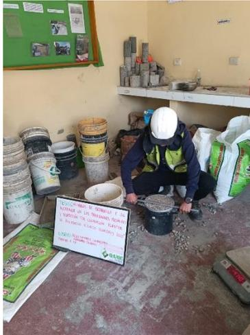
**Fotografía N°09:** Proceso de ensayo de peso unitario compactado del agregado global.
