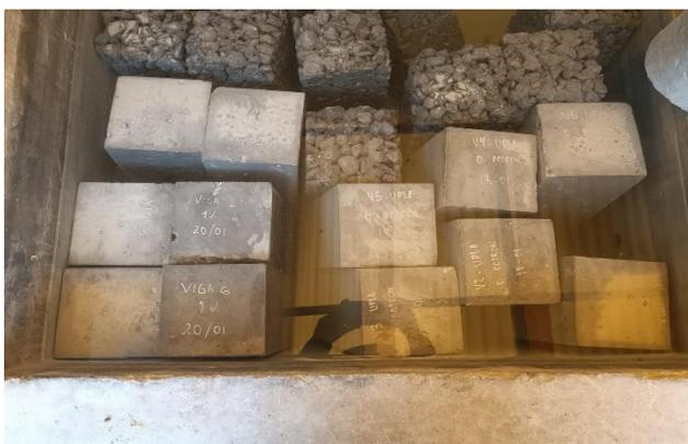
**Fotografía N°15:** Vista general del proceso de curado de testigos de concreto (vigas).
