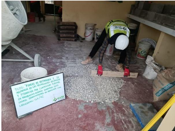
**Fotografía N°01:** Proceso de cuarteo del AG.
