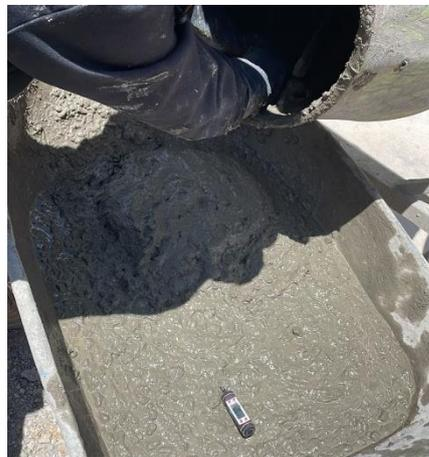
**Fotografía N°22:** Proceso de control de la temperatura del concreto.
