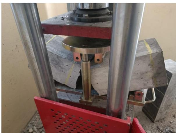
**Fotografía N°17:** Proceso de rotura de vigas sometidas a flexión.
