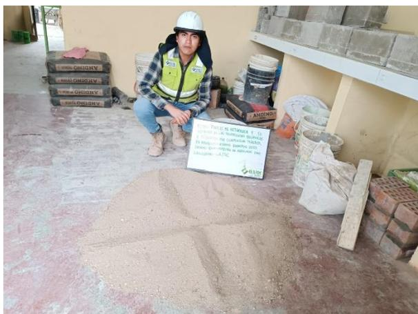
**Fotografía N°03:** Obtención de muestra para ensayo granulométrico mediante el cuarteo del AF.
