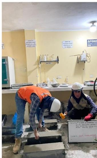
**Fotografía N°14:** Proceso de elaboración de vigas de concreto bajo la muestra D3.
