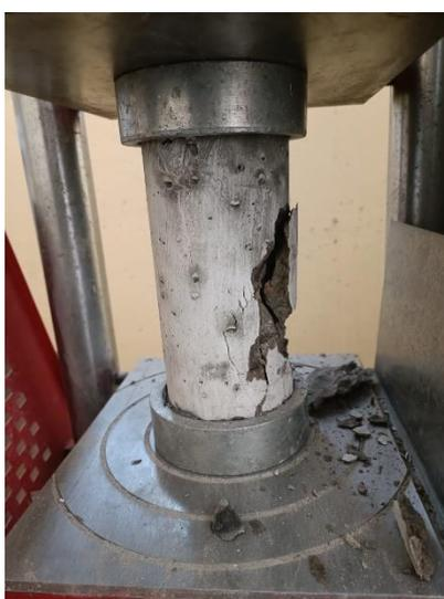
**Fotografía N°16:** Proceso de rotura de testigos de concreto empleando fibra de betarraga en dosis del 2%.
