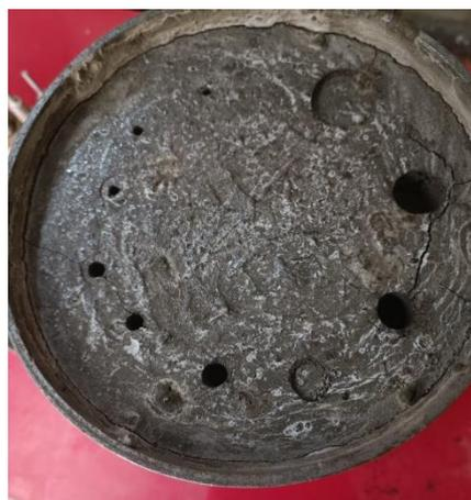
**Fotografía N°23:** Proceso de control de tiempo de fragua del concreto con dosis de fibra al 1%.
