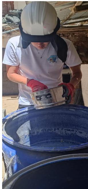
**Fotografía N°10:** Proceso de ensayo de material pasante por la malla N°200.
