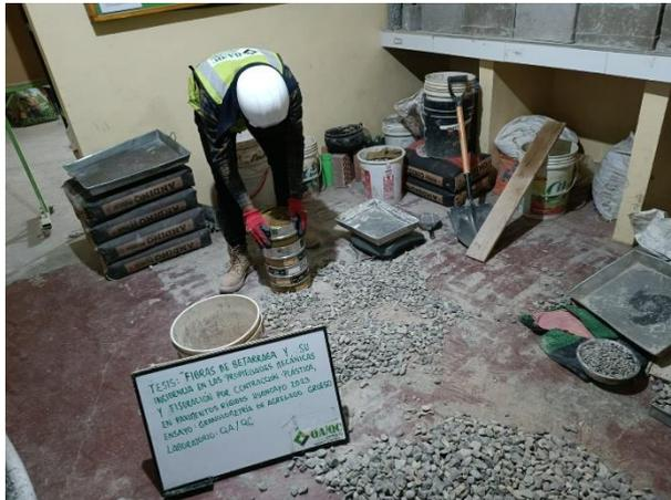
**Fotografía N°02:** Proceso de ensayo de análisis granulométrico del agregado grueso, prueba efectuada en concordancia a la norma NTP 400.012.
