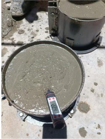
**Fotografía N°18:** Proceso de ensayo de exudación del concreto de la muestra patrón.
