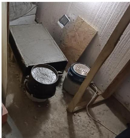
**Fotografía N°20:** Vista general del proceso de control de la relación de reducción de grietas del concreto con muestra patrón.
