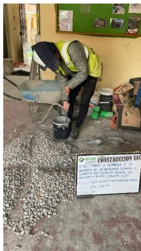
**Fotografía N°08:** Proceso del ensayo de peso unitario compactado del agregado grueso.
