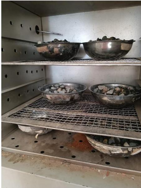
**Fotografía N°05:** Proceso de obtención del contenido de humedad del agregado grueso.
