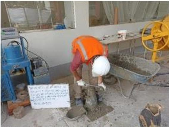
IMAGEN N° 32: Ensayo de asentamiento (slump) – enrasado.
