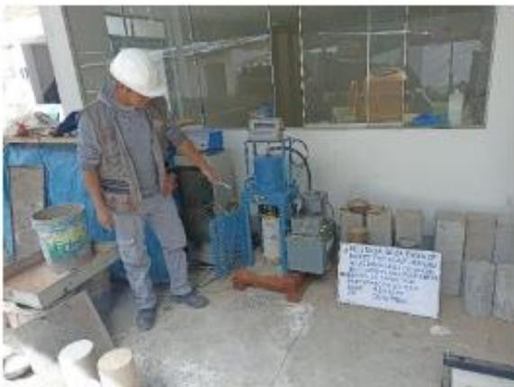
IMAGEN N° 57: Ensayo de resistencia a la compresión – 0.75% (28 días).
