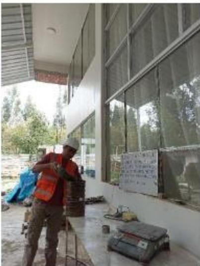
IMAGEN N° 09: Análisis granulométrico de agregado fino (arena gruesa).
