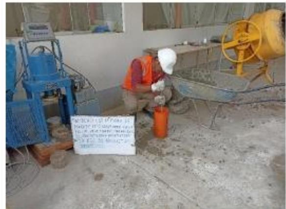
IMAGEN N° 35: Elaboración de briquetas para ensayo de compresión y tracción indirecta – golpes por capas.
