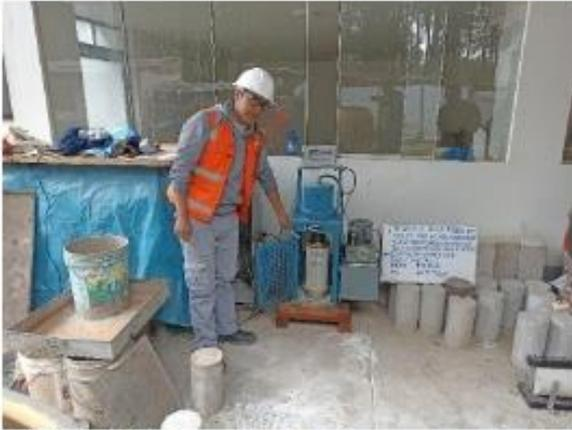
IMAGEN N° 49: Ensayo de resistencia a la compresión – 0.75% (14 días).
