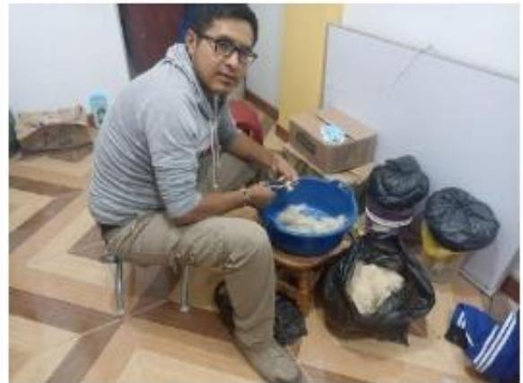
IMAGEN N° 06: Corte de fibra de maguey de aproximadamente 02 centímetros.
