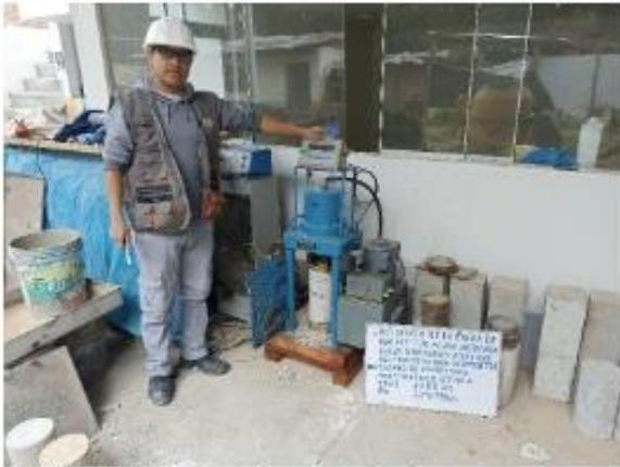
IMAGEN N° 55: Ensayo de resistencia a la compresión – 0.25% (28 días).
