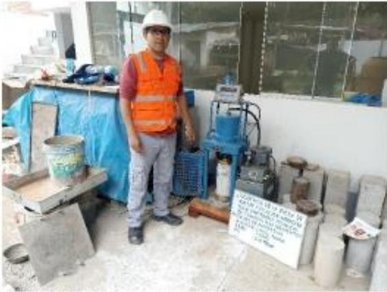
IMAGEN N° 43: Ensayo de resistencia a la compresión – 0.25% (7 días).
