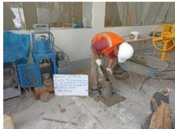
IMAGEN N° 30: Ensayo de asentamiento (slump).
