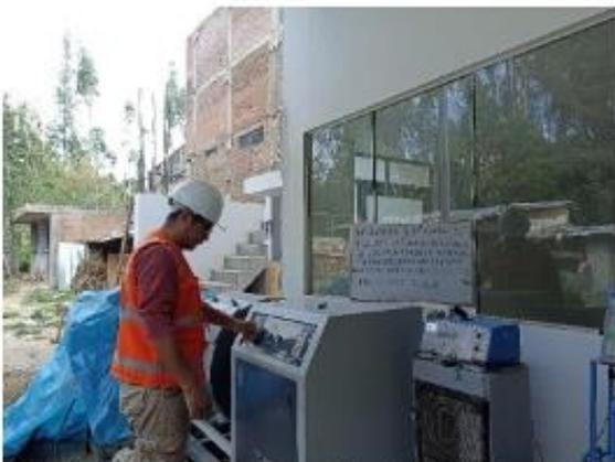
IMAGEN N° 18: Ensayo de abrasión de los ángeles.
