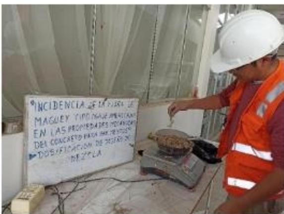
IMAGEN N° 23: Diseño de Mezcla (peso de fibra de maguey).
