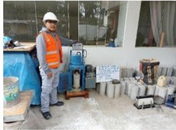
IMAGEN N° 46: Ensayo de resistencia a la compresión – muestra patrón (14 días).
