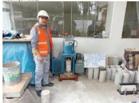
IMAGEN N° 48: Ensayo de resistencia a la compresión – 0.50% (14 días).
