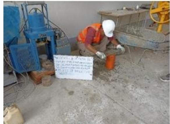
IMAGEN N° 36: Elaboración de briquetas para ensayo de compresión y tracción indirecta – enrasado.
