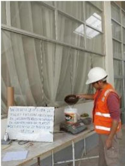
IMAGEN N° 22: Diseño de Mezcla (peso de agua).
