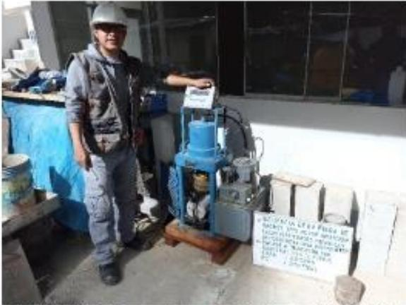
IMAGEN N° 61: Ensayo de tracción indirecta – 0.75% (28 días).
