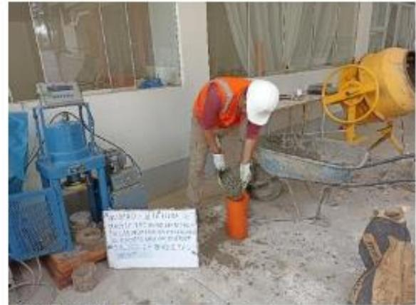
IMAGEN N° 34: Ensayo de asentamiento (slump) – enrasado.
