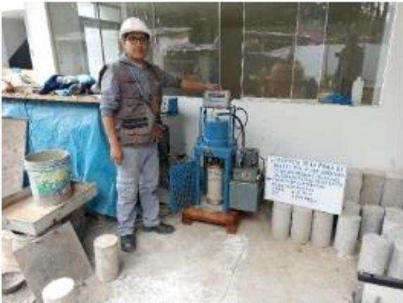
IMAGEN N° 50: Ensayo de resistencia a la compresión – muestra patrón (21 días).
