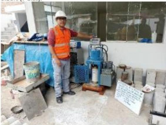
IMAGEN N° 45: Ensayo de resistencia a la compresión – 0.75% (7 días).
