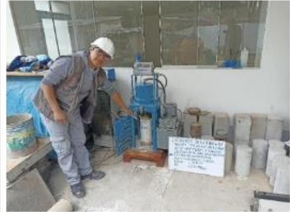
IMAGEN N° 52: Ensayo de resistencia a la compresión – 0.50% (21 días).
