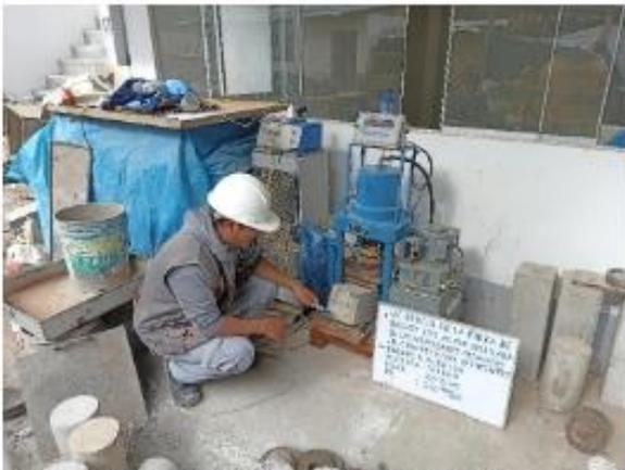
IMAGEN N° 62: Ensayo de resistencia a la flexión – muestra patrón (28 días).
