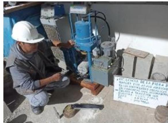
IMAGEN N° 59: Ensayo de tracción indirecta – 0.25% (28 días).
