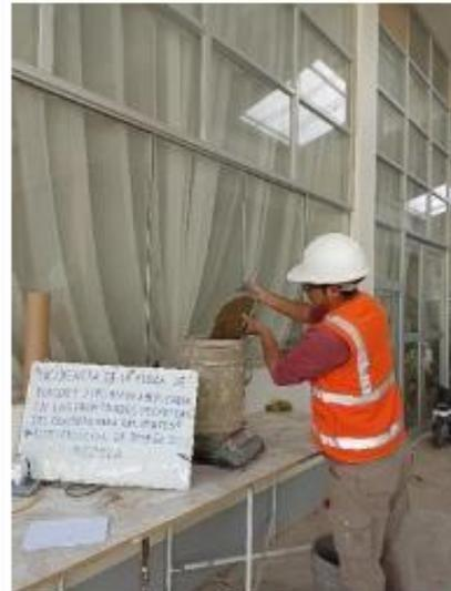
IMAGEN N° 20: Diseño de Mezcla (peso de arena gruesa).
