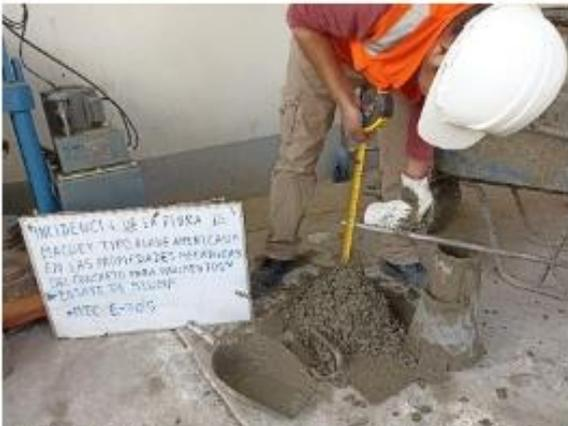
IMAGEN N° 33: Ensayo de asentamiento (slump) – 4.4' pulgadas.
