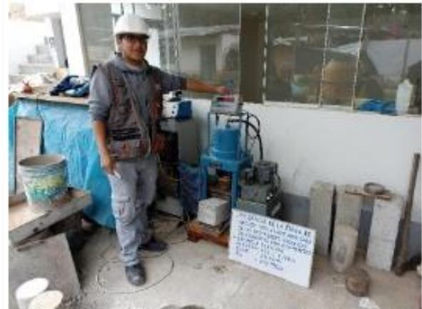
IMAGEN N° 65: Ensayo de resistencia a la flexión – 0.75% (28 días).
