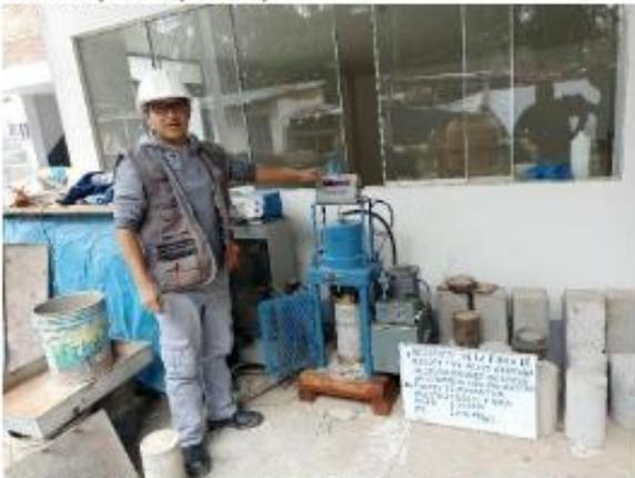
IMAGEN N° 51: Ensayo de resistencia a la compresión – 0.25% (21 días).
