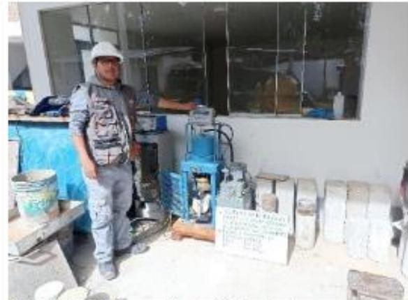
IMAGEN N° 58: Ensayo de tracción indirecta – muestra patrón (28 días).
