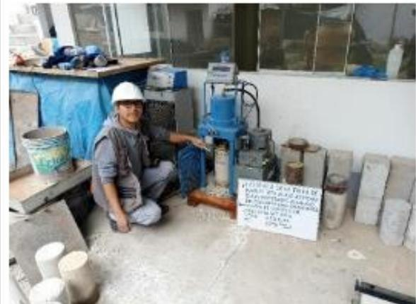
IMAGEN N° 54: Ensayo de resistencia a la compresión – muestra patrón (28 días).
