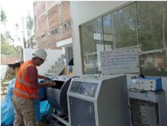
IMAGEN N° 17: Ensayo de abrasión de los ángeles.
