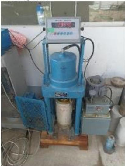
IMAGEN N° 38: Ensayo de resistencia a la compresión – muestra patrón.
