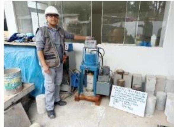
IMAGEN N° 53: Ensayo de resistencia a la compresión – 0.75% (21 días).
