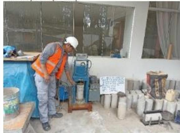
IMAGEN N° 47: Ensayo de resistencia a la compresión – 0.25% (14 días).
