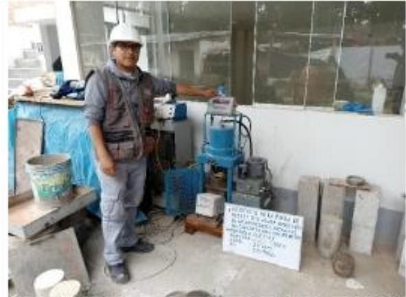
IMAGEN N° 64: Ensayo de resistencia a la flexión – 0.50% (28 días).
