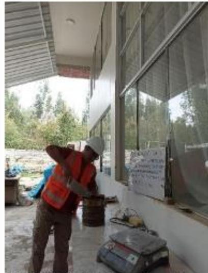
IMAGEN N° 10: Análisis granulométrico de agregado grueso (piedra chancada).
