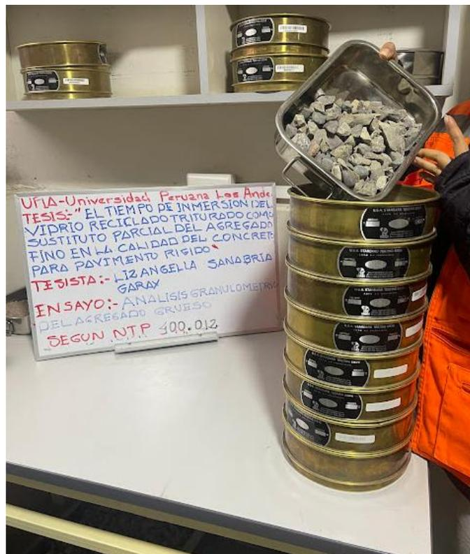
Fotografía 2. Vista del tamizado del agregado grueso para la elaboración del concreto.
