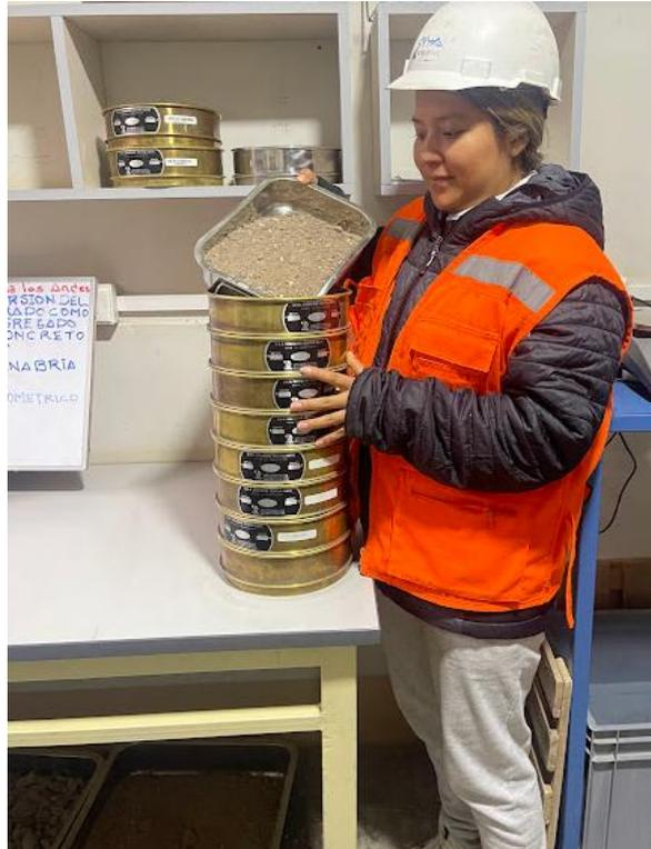
Fotografía 1. Vista del tamizado del agregado fino para la elaboración del concreto.
