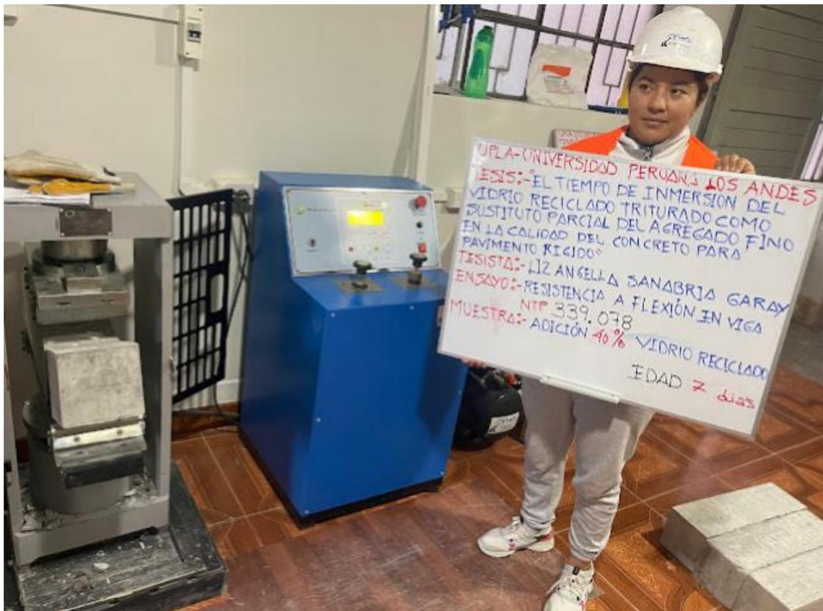
Fotografía 12. Rotura de las vigas con 30 % de vidrio triturado y reciclado.
