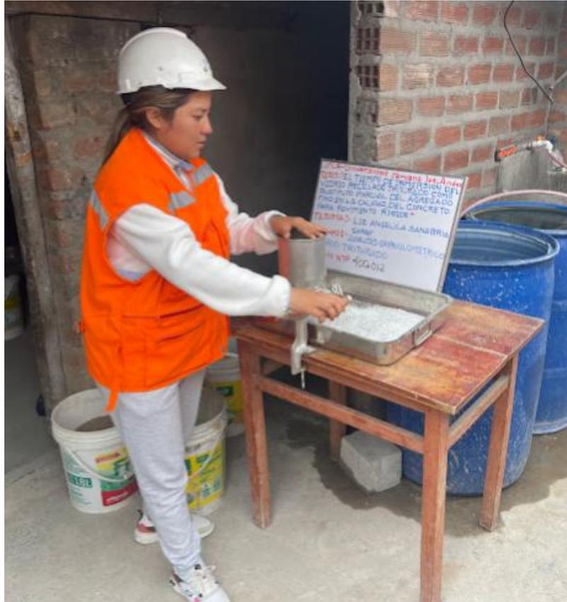
Fotografía 3. Molienda del vidrio, previamente triturado manualmente.
