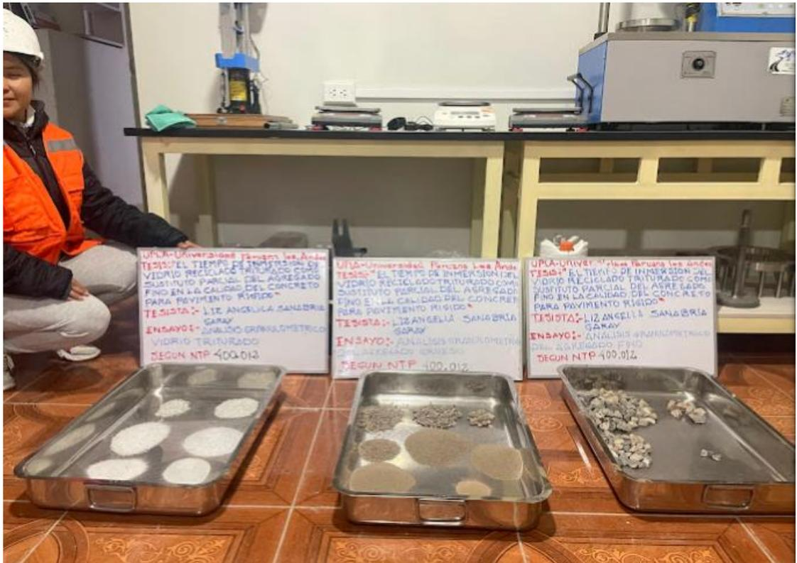
Fotografía 5. Vista general de la gradación obtenida del agregado fino, grueso y el vidrio reciclado triturado.
