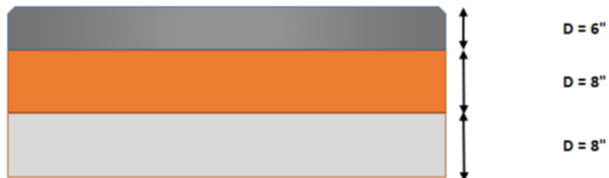
Figura 20. Dimensionamiento del pavimento flexible - Resiliencia Alta
