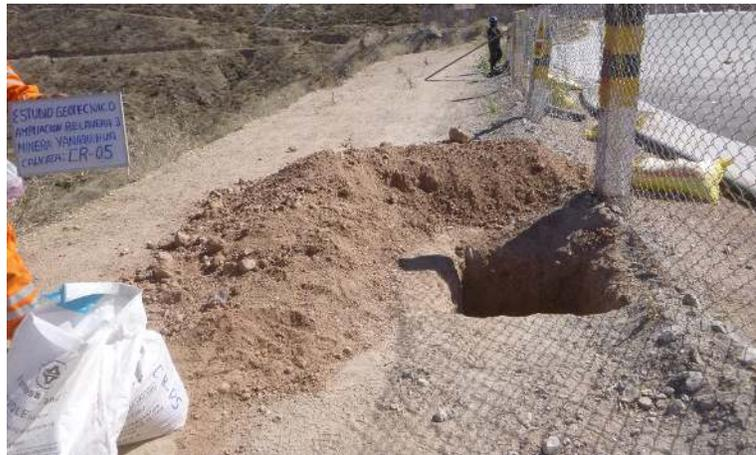
**Figura 5:** Calicata CR-04 Extracción de muestras para ensayos de laboratorio.
