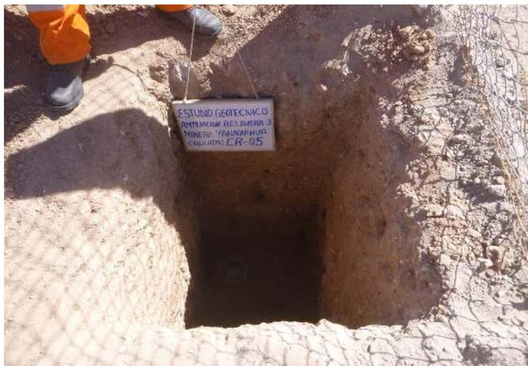
**Figura 6:** Calicata CR-05 Ensayo de densidad de campo
