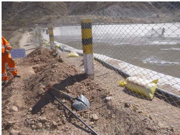
**Figura 8:** Calicata CR-06 extracción de muestras para ensayos de laboratorio
