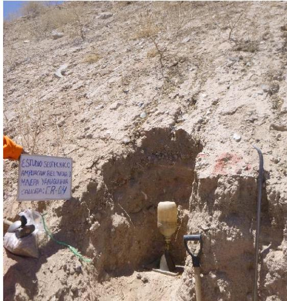
**Figura 2:** Ensayo de densidad de campo CR-04
