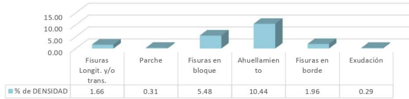
% de densidad de fallas (Muestra M1-04)
