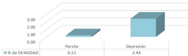
% de densidad de fallas (Muestra M1-07)
