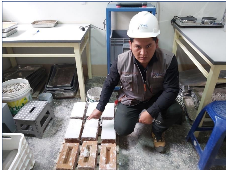
Figura 20. Reposo de ladrillos cubiertos de yeso.
