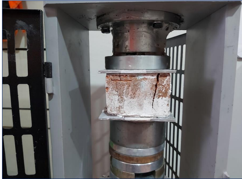
Figura 21. Rotura por compresión de ladrillo.
