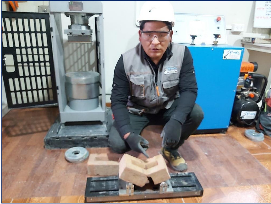
Figura 17. Ladrillo roturado por flexión.
