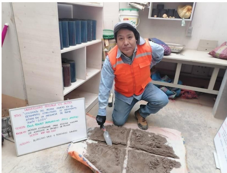
Cuarteo del agregado fino
