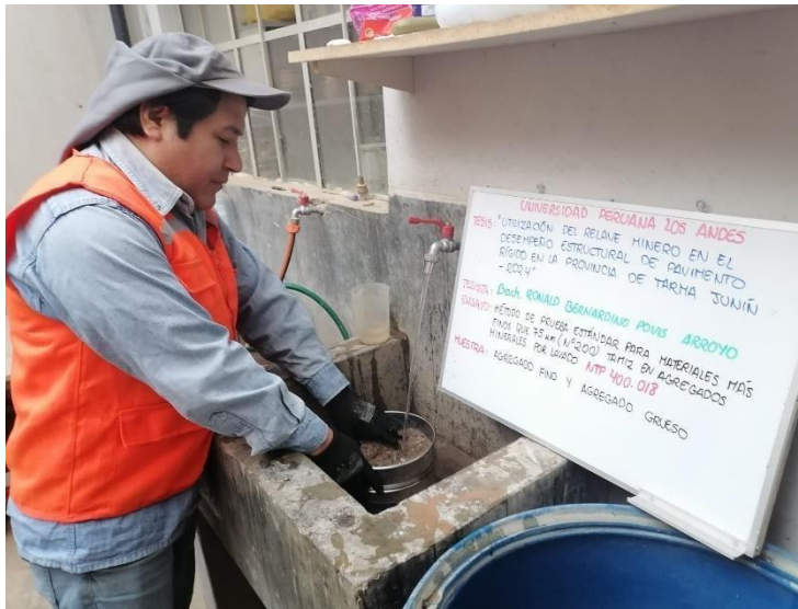
Lavado de agregado fino
