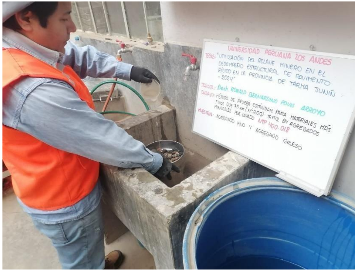
Lavado de agregado grueso
