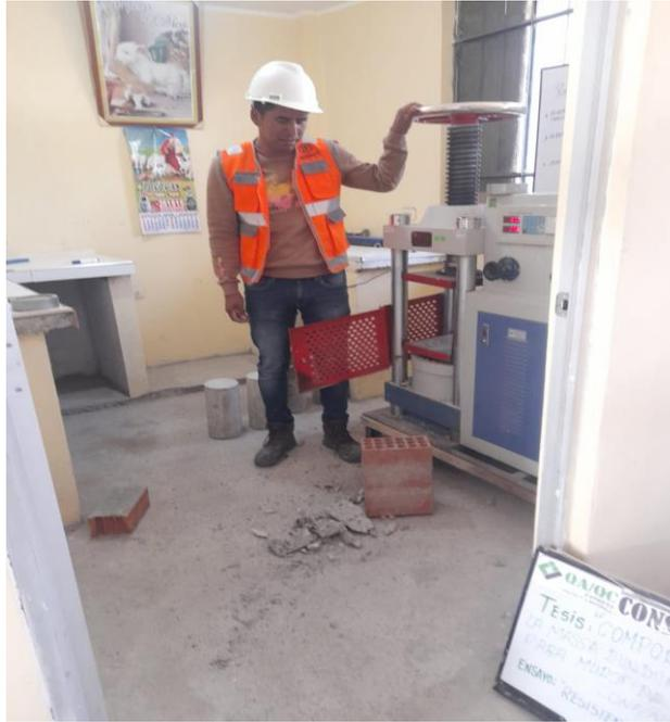
Realizando el ensayo de cada pila de cada ladrillo
