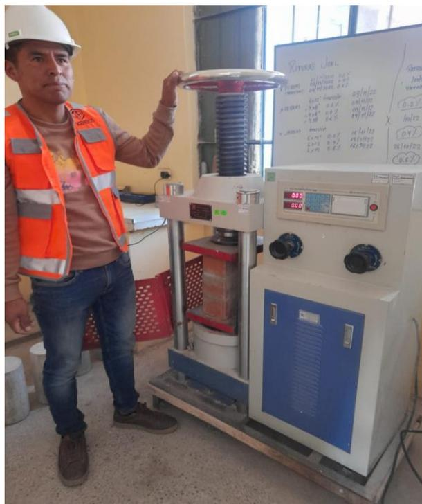
decimo pila de ladrillo para el ensayo de la masa dun dun
