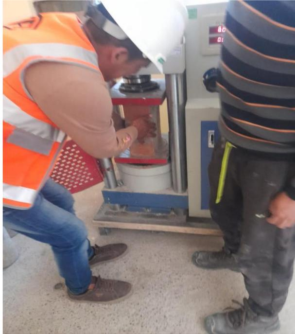
Noveno pila de ladrillo para el ensayo de la masa dun dun
