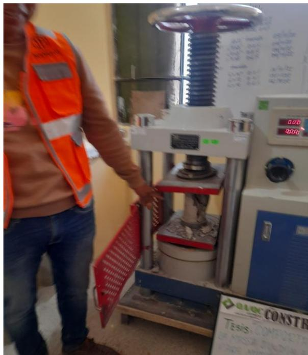
Configurando la máquina para los ensayos
