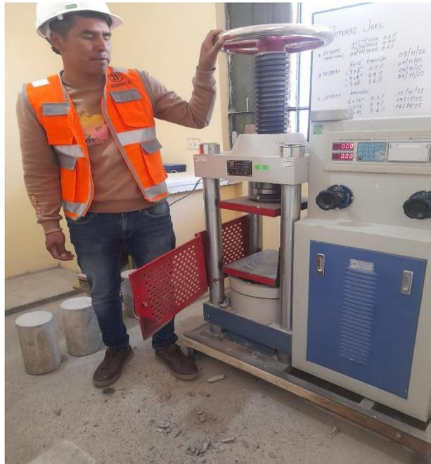
Máquina para la compresión para los ensayos
