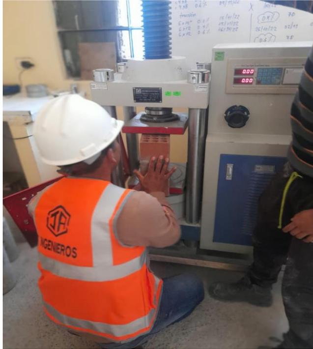
Octavo pila de ladrillo para el ensayo de la masa dun dun
