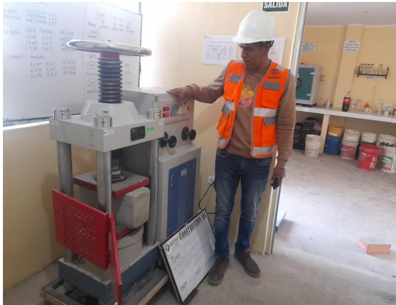
Cuarta pila de ladrillo para el ensayo de la masa dun dun
