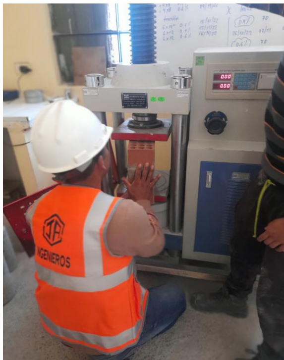
Preparando la tercera muestra de la pila de ladrillos
