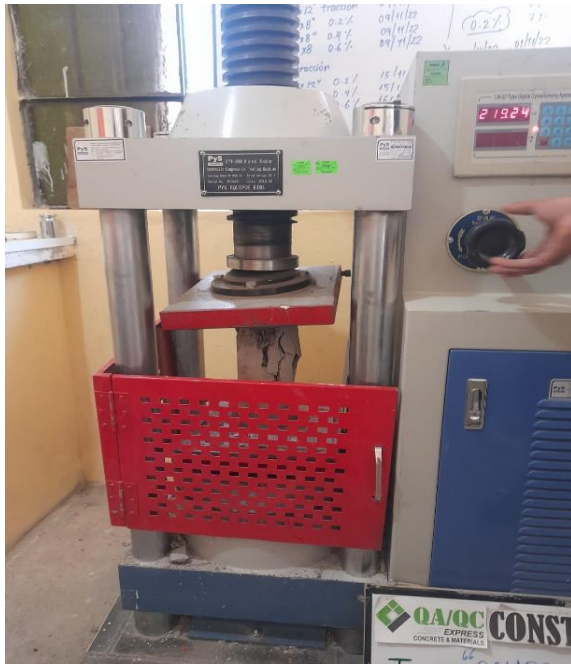
Tercer ensayo de la pila de ensayos con el mortero
