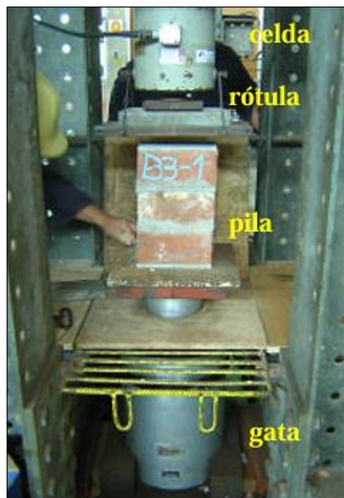
Figura 6: Compresión en pilas.
