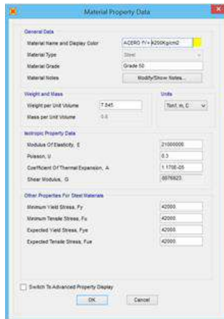
Figura 25 Definiendo el refuerzo Fy= 4200\text{Kg/cm}^2 Fuente: Elaboración propia.
