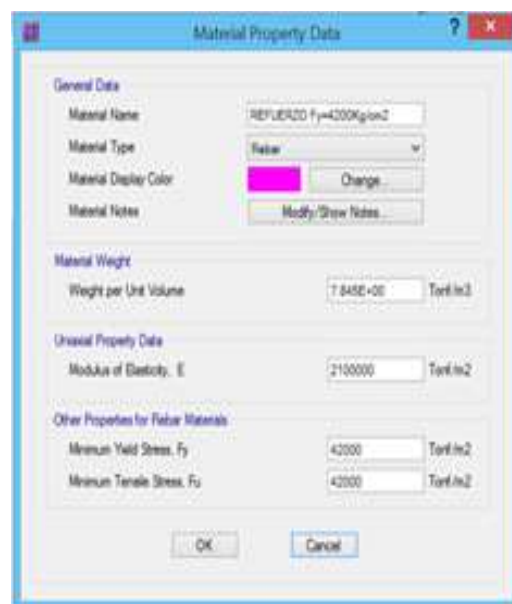
Figura 50 Definiendo el refuerzo F_y=4200\text{Kg/cm}^2 Fuente: Elaboración propia.
