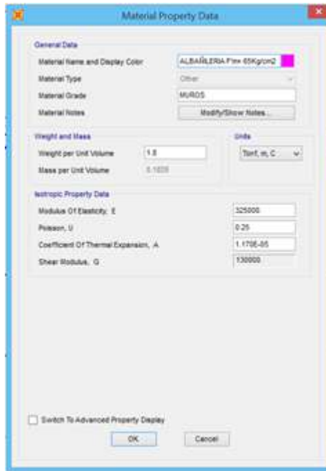
Figura 26 Definiendo la albañilería Fm= 65Kg/cm2”
