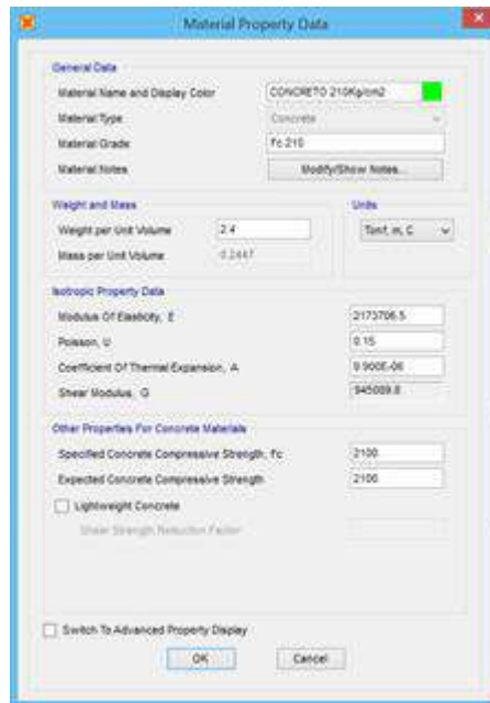
Figura 24 Definiendo el concreto F'c= 210\text{Kg/cm}^2 Fuente: Elaboración propia.
