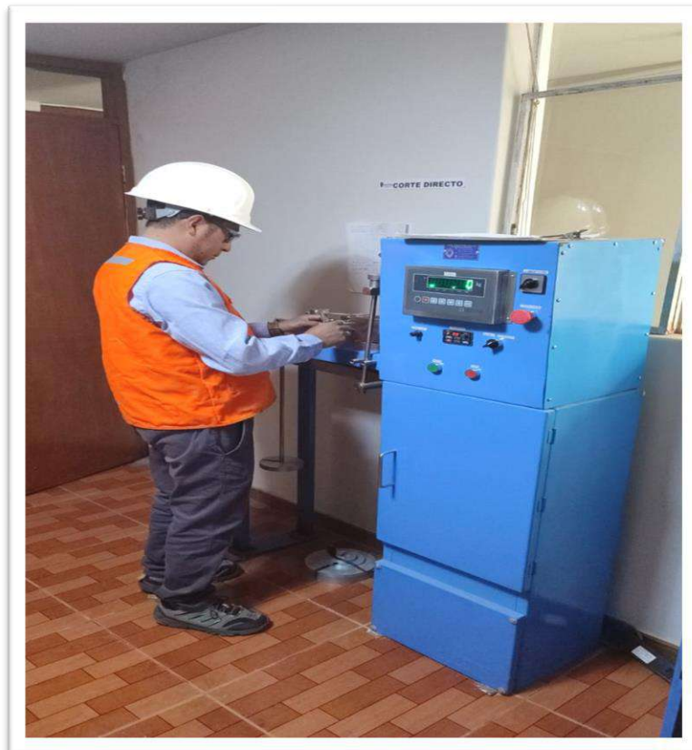
Vista 02.- En la vista se verifica el proceso del ensayo de corte directo en el laboratorio de suelos.
