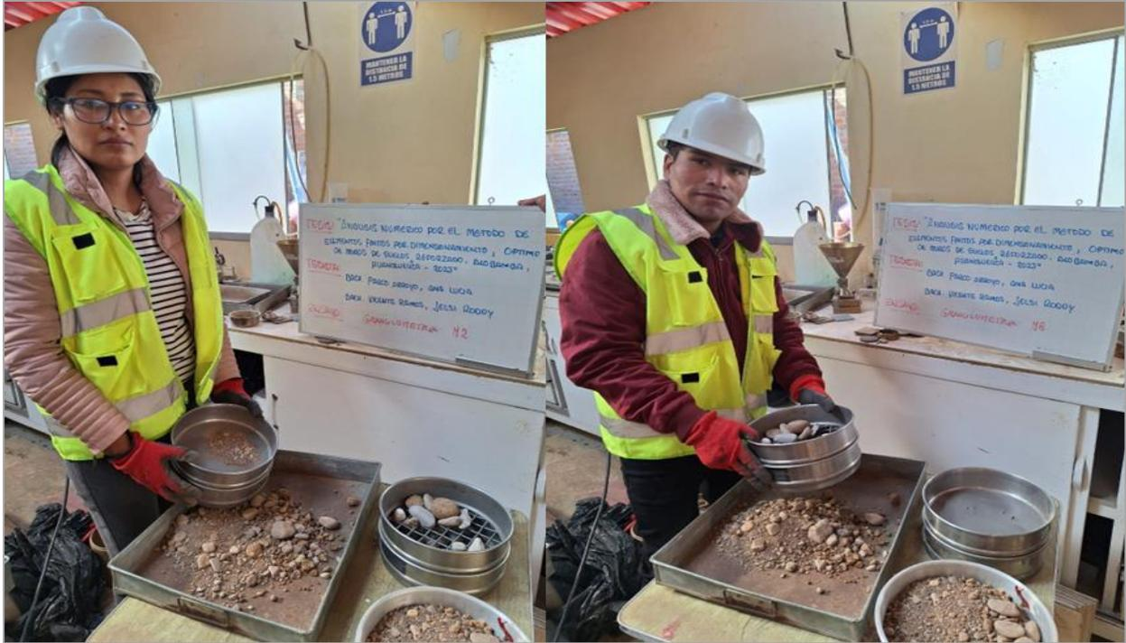
Anexo N°04. 3. Tamizado de muestras representativas de ensayo granulométrico.
