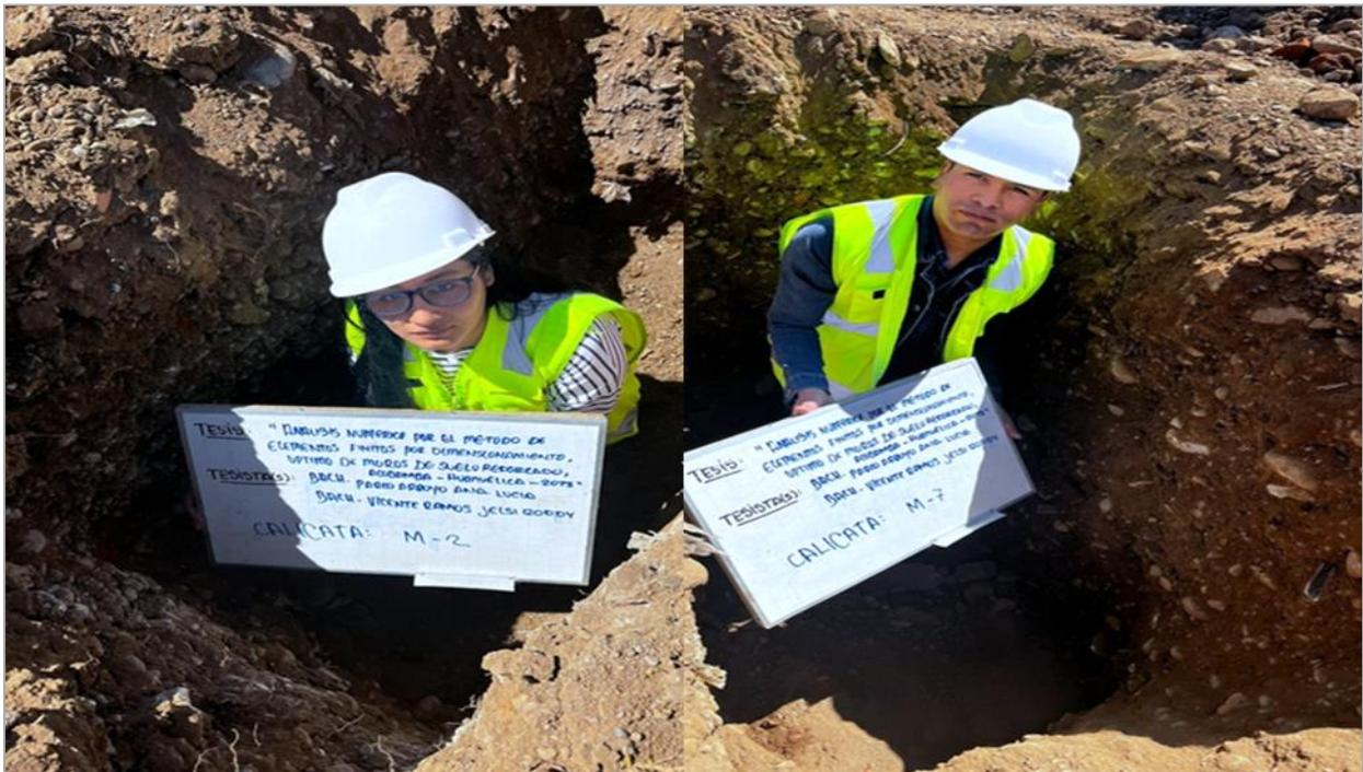
**Anexo N°04. 2.** Excavaciones de C-3/M-2 y C-1/M-7 con detalles característicos de las muestras.
