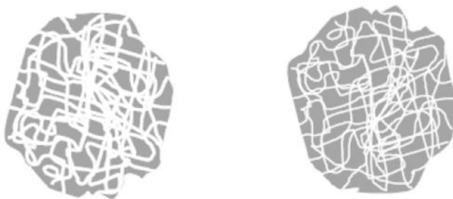
Figura 2.2. Macroporos y mesoporos en los gránulos de carbón activado. Fuente: Ingeniería de tratamiento y acondicionamiento de agua, 2017.
