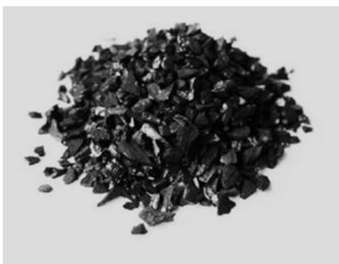
Figura 2.3. Carbón granular comercial Fuente: Fuente: (Lopez & Nieto, 2014)
